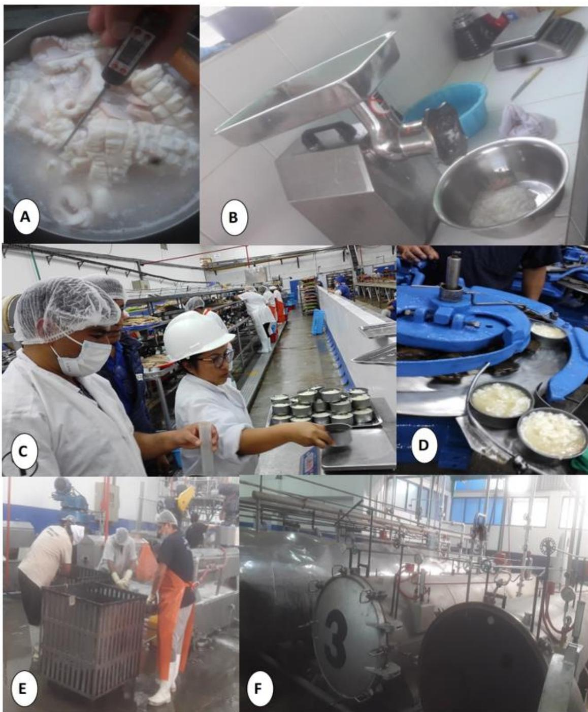
Nota: A) Precocción del calamar gigante previamente lavado y cortado; B) Molienda; C) Envasado y Adición de líquido de cobertura; D) Ingreso de las latas a máquina cerradora; E) Lavado de latas y llenado de carros de autoclave; F) Autoclaves de esterilizado.
