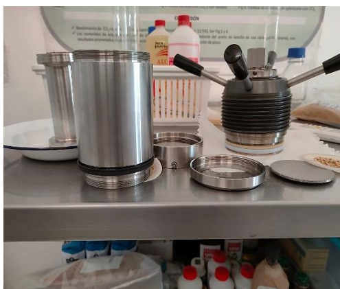
Detalle de la celda de extracción del equipo TOP INDUSTRIE 2802 0000
