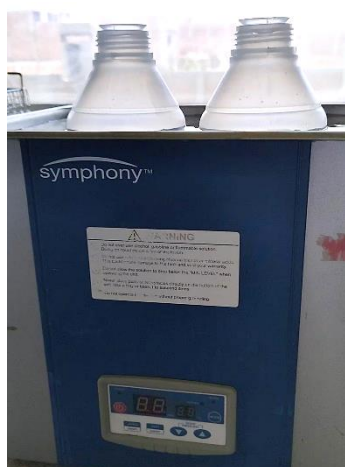
Sonicación de agua a 50Hz x 30 min, equipo Symphony. Laboratorio de Química, ITP.
