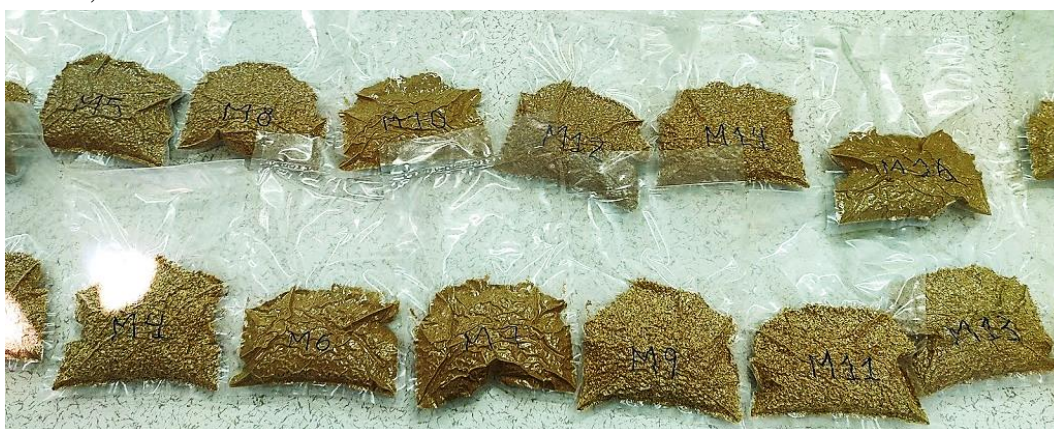
e) Obtención de muestras de cáscaras secas de jengibre (100g en cada envase, al vacío)
