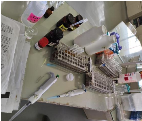
i) Preparación de muestras para ensayo CFT (Folin-Ciocalteu) y actividad antioxidante (método DPPH). Laboratorio de química, ITP, Ventanilla, Callao.
