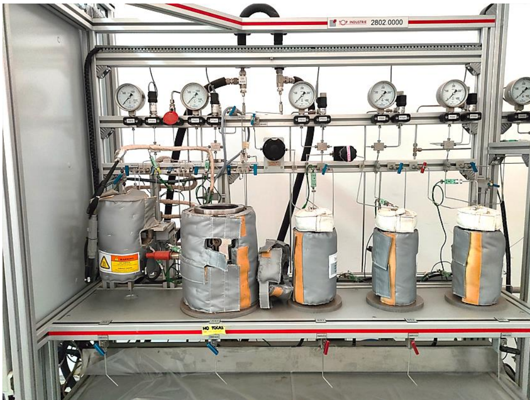
f) Equipo de extracción a alta presión y temperatura TOP INDUSTRIE 2802 0000. Laboratorio de compuestos bioactivos, ITP, Callao, Callao.
