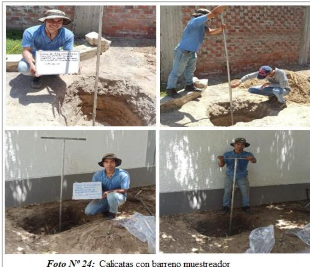
*Foto N° 24: Calicatas con barreno muestreador*
