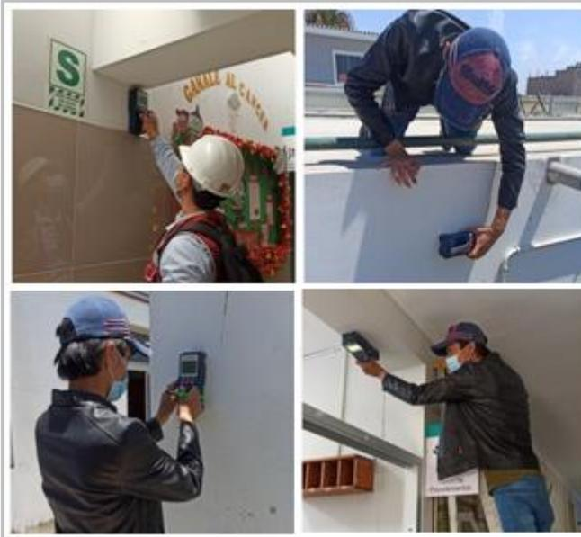
Foto N° 21: Ubicación y cantidad de barras de acero presente en los elementos estructurales
