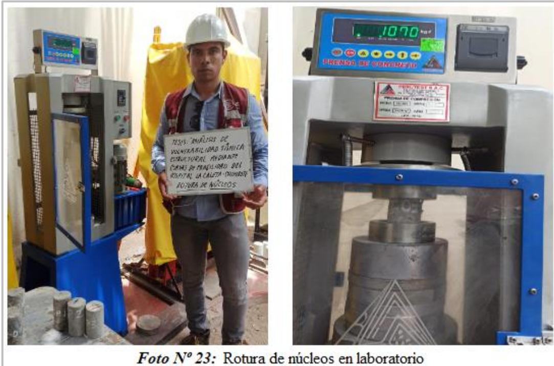
*Foto N° 23: Rotura de núcleos en laboratorio*
