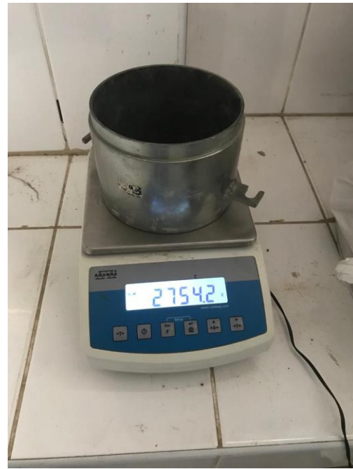
Fotografía N°19.- Toma de medidas del molde para proctor modificado.
