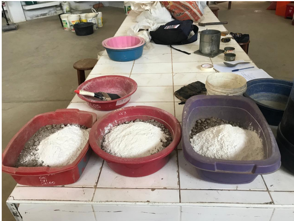
Fotografía N°33.- Colocación de los porcentajes de cal viva para su posterior mezcla.
