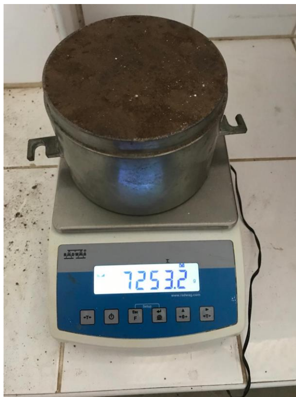
Fotografía N°36.- Pesaje de muestra con los aditivos para proctor modificado.
