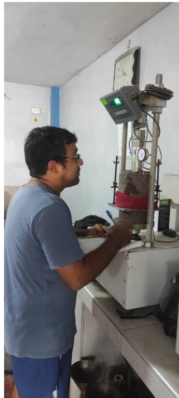
Fotografía N°40.- Ensayo de penetración de muestra más aditivos.
