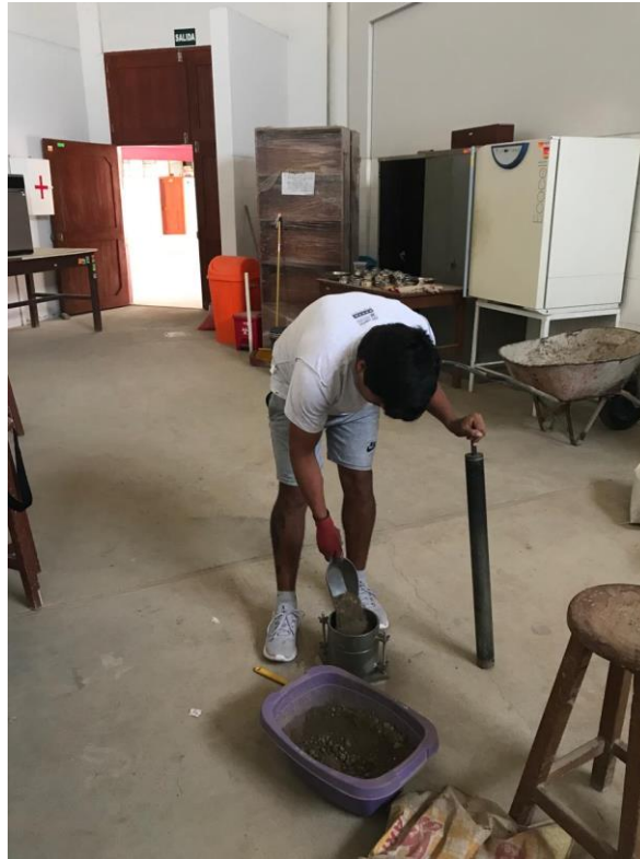
Fotografía N°35.- Compactación para proctor modificado.
