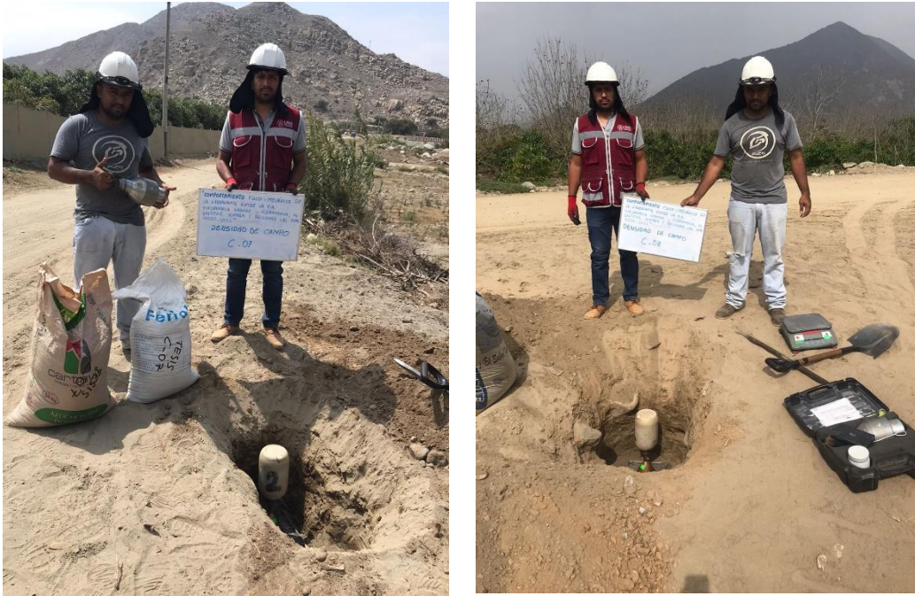
Fotografía N°07.- Densidad de campo - calicata 7 y 8.
