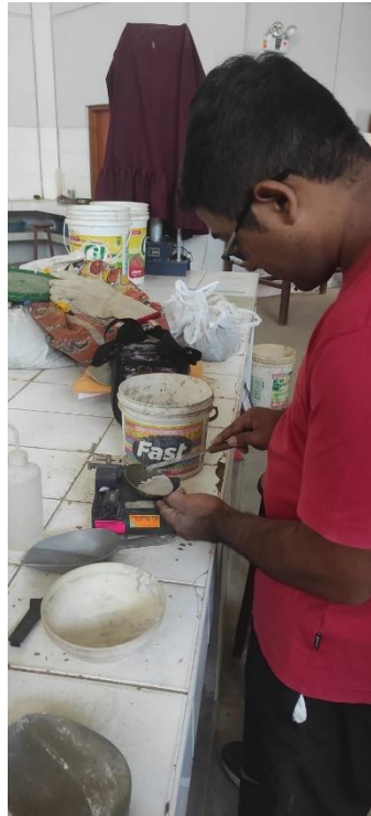
Fotografía N°29.- Límite líquido de la cal viva.
