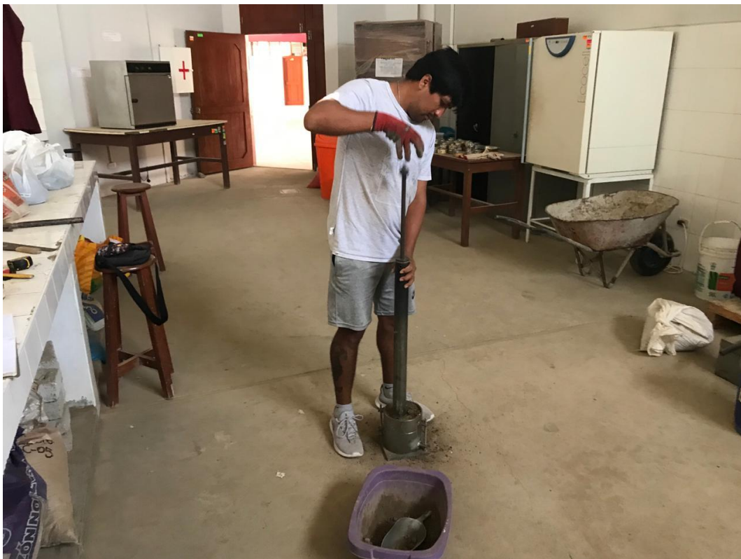
Fotografía N°20.- Compactación con martillo para Proctor modificado.
