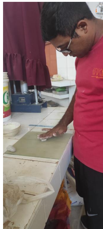
Fotografía N°30.- Límite plástico de la cal viva.
