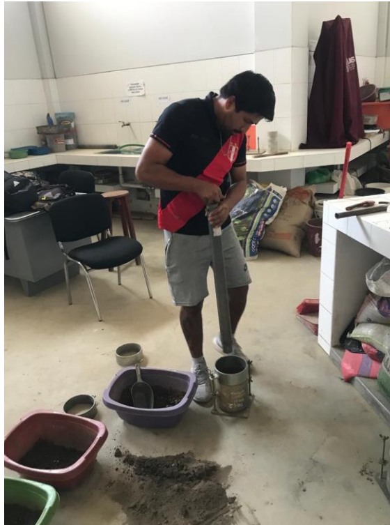
Fotografía N°23.- Compactación de proctor para CBR.
