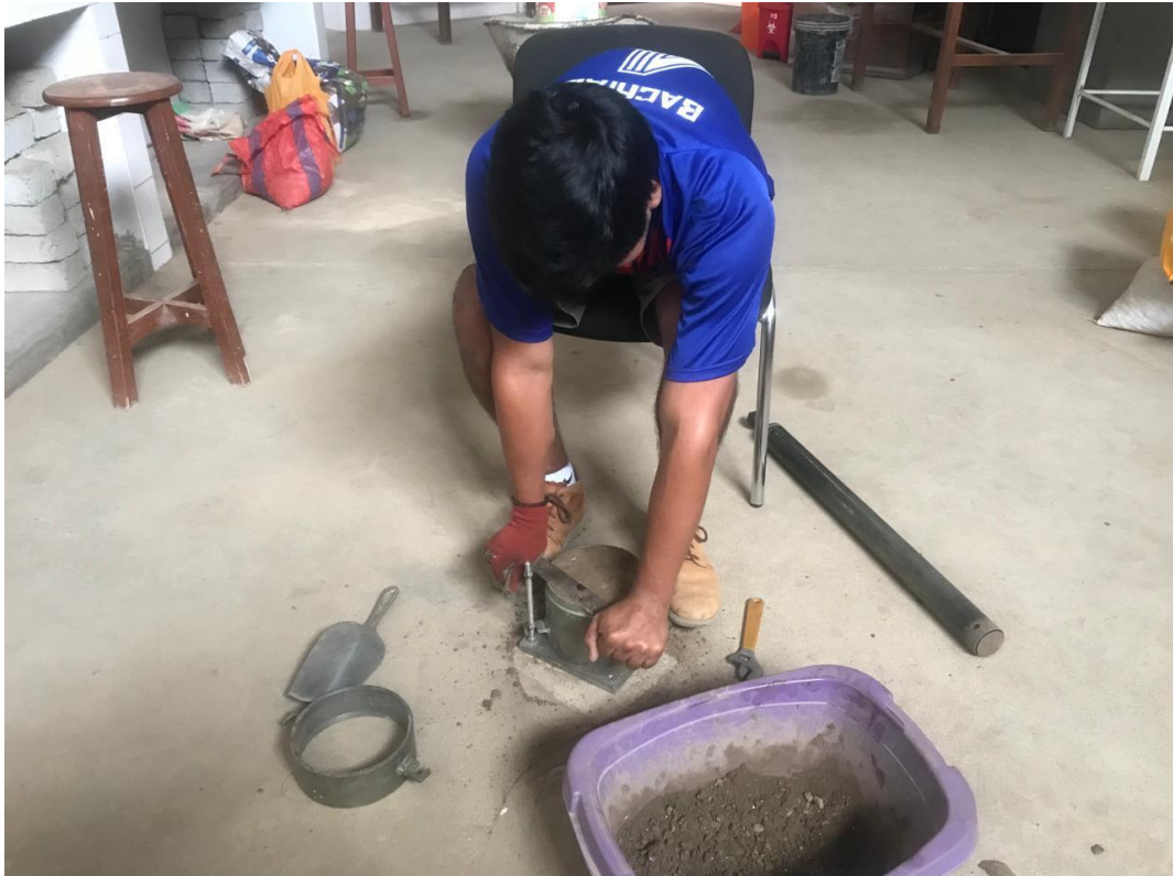
Fotografía N°21.- Enrasado para Proctor modificado.
