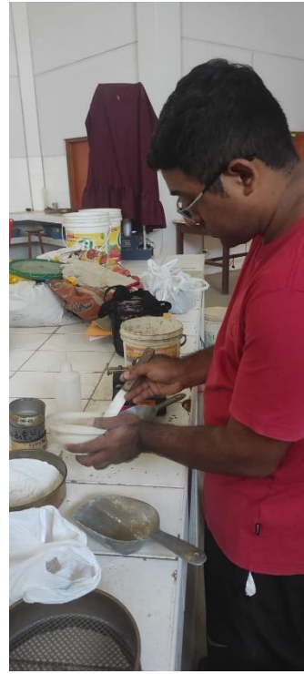
Fotografía N°29.- Límite líquido de la cal viva.
