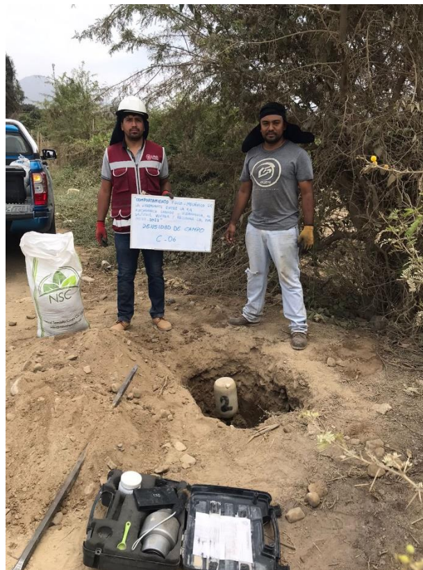
Fotografía N°06.- Densidad de campo - calicata 6.
