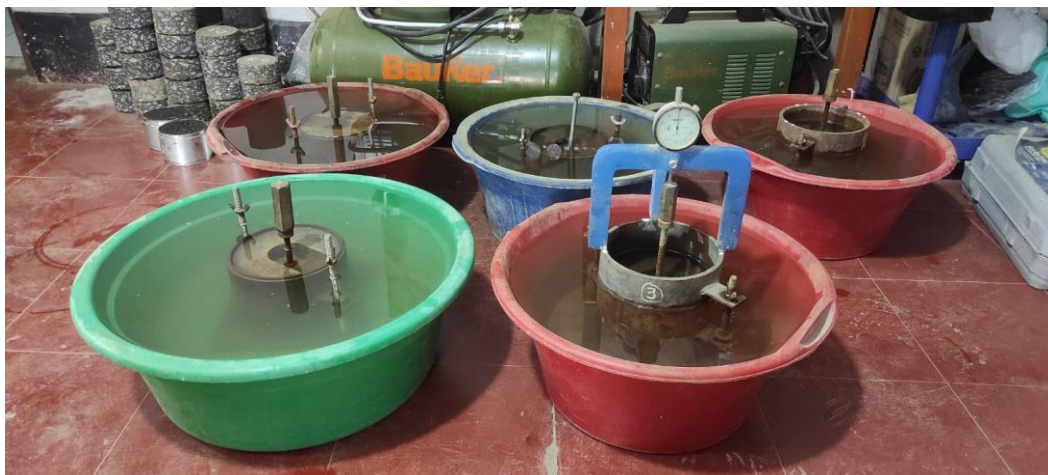
Fotografía N°38.- Medición de expansión inicial de muestra más aditivos.
