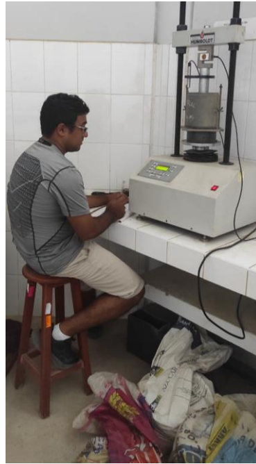
Fotografía N°27.- Ensayo de penetración para CBR.
