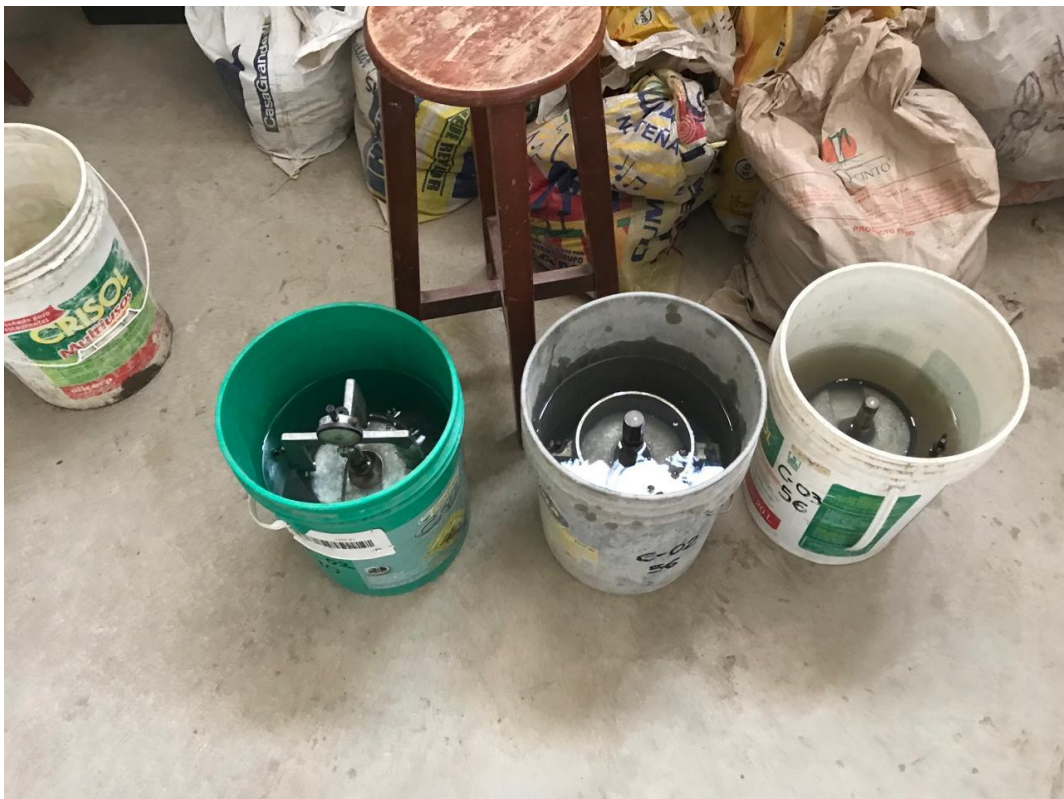
Fotografía N°26.- Cuarto día, medida de expansión final de muestras.
