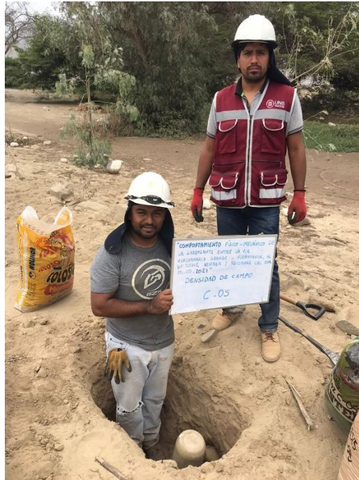
Fotografía N°05.- Densidad de campo - calicata 5.
