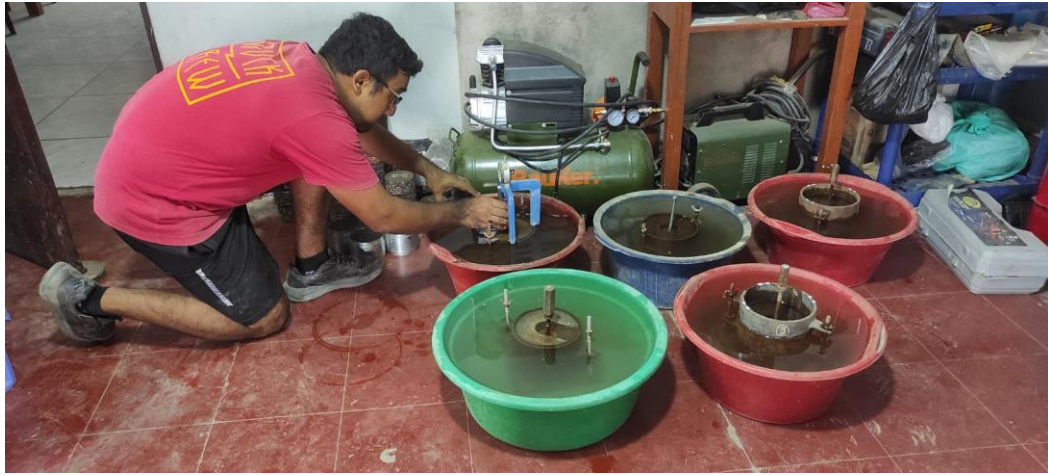
Fotografía N°39.- Medición de expansión final de muestra más aditivos.
