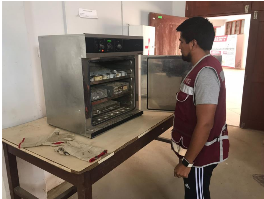
Fotografía N°13.- Secado luego del lavado.
