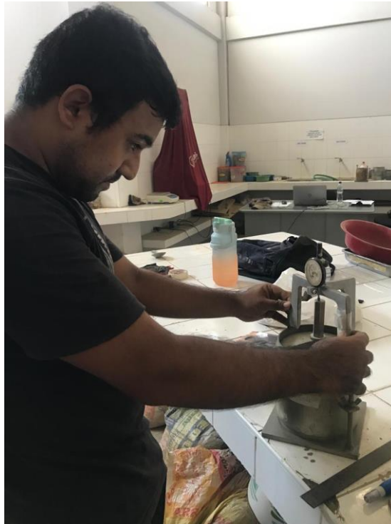
Fotografía N°25.- Medición de expansión inicial de muestra para CBR.
