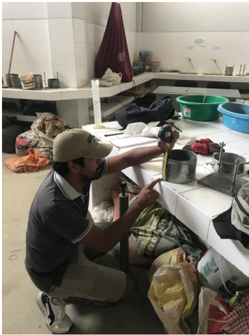
Fotografía N°19.- Toma de medidas del molde para proctor modificado.
