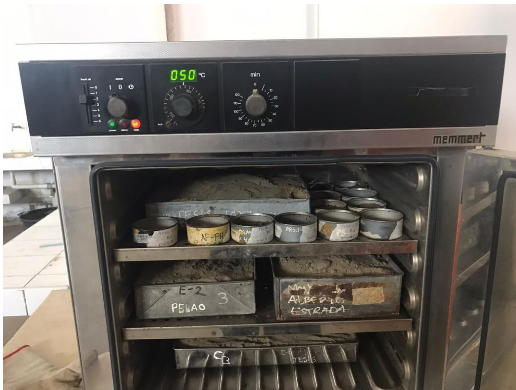
Fotografía N°09.- Secado de muestras en horno para contenido de humedad.
