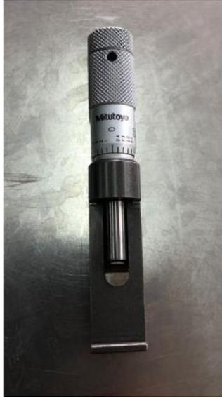
**Anexo 80.** Micrómetro para medición de espesor.
