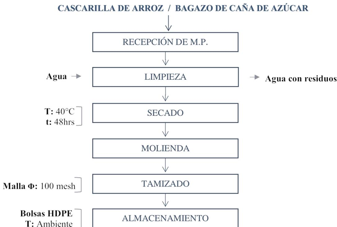
*Nota.* Esta figura se muestra el flujograma del proceso para la extracción de las fibras agroindustriales. Este proceso se hace por cada materia prima por separado.
