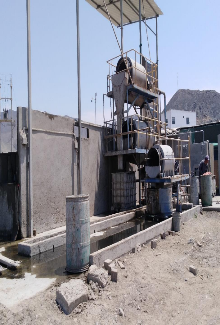
Anexo 4. Trommel procesador de biofouling y sistemas del lixiviado en la empresa Aquacultivos del Pacifico Sac.
