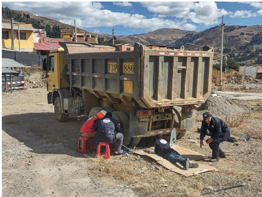
Fotografía 10: se puede ver la toma de datos en el ensayo de placa de carga N° 06 (P-6).
