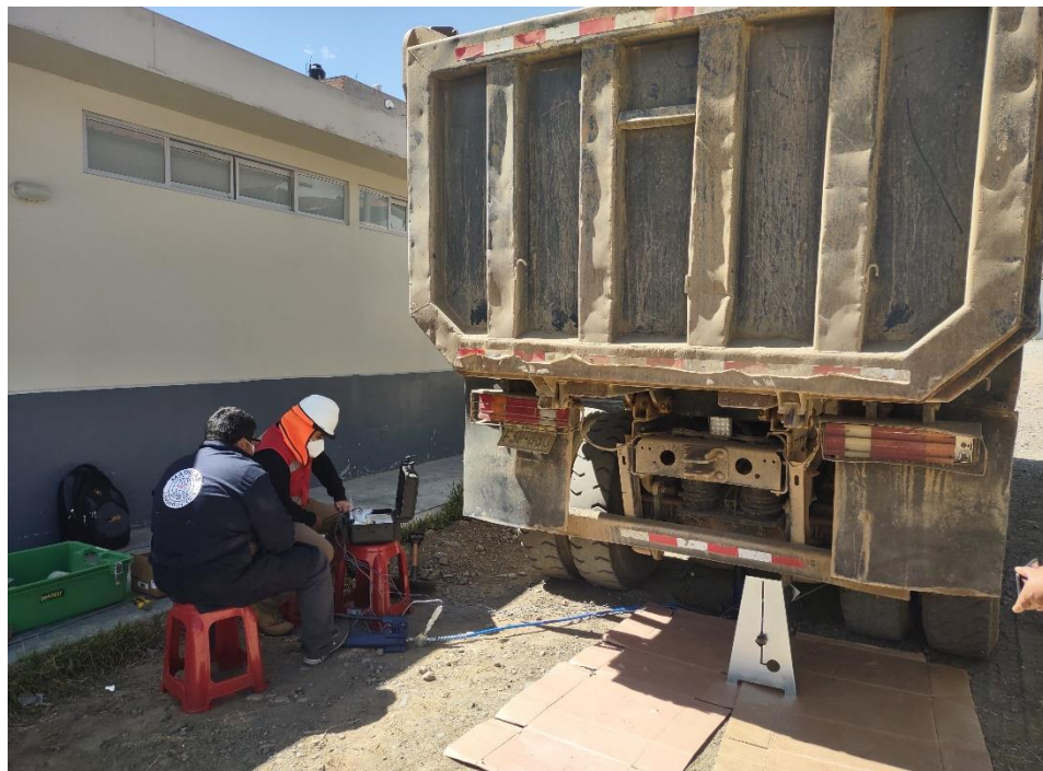
Fotografía 4: se puede ver el ensayo de placa de carga N° 03 (P-3) también dentro de las instalaciones del Hospital Víctor Ramos Guardia.
