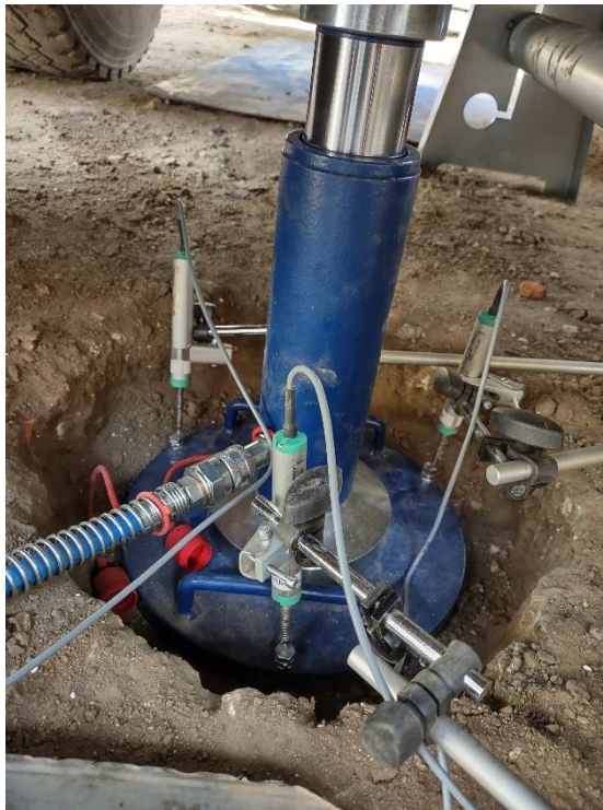
Fotografía 16: se puede ver la ejecución del ensayo de placa de carga N° 09 (P-09).
