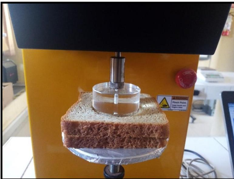
**Figura 60.** *Se empleó la sonda cilíndrica TA4/1000<sup>a</sup> a una velocidad de 0.5 mm/s con un objetivo de penetración de 10 mm.*
