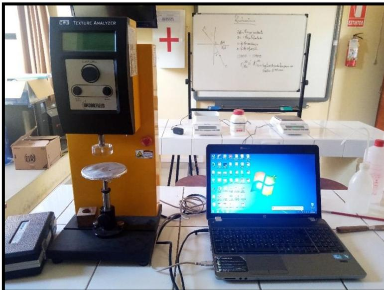
**Figura 59.** *Texturómetro de la marca BROOKFIELD Engineering Labs, modelo CT3 4500.*
