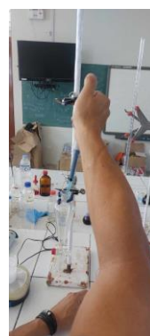
Figura 206: Se le agregó 10 ml de solución sal de amonio – tolueno al embudo de separación
