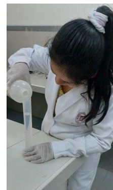
Figura 126: Adición de 100 ml H 2 O destilada al pallar machacado
