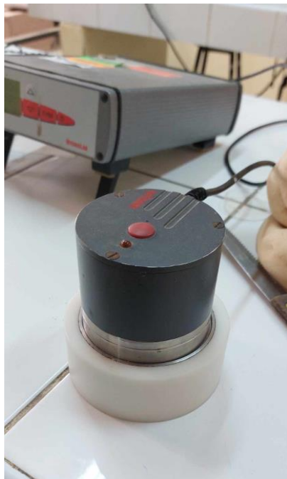
Figura 168: Adición de muestra (salsa) sobre la cubeta del equipo
