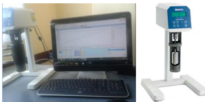
Figura 20: Reómetro R/S Plus Rheometer, Marca Brookfield SN:70200085
