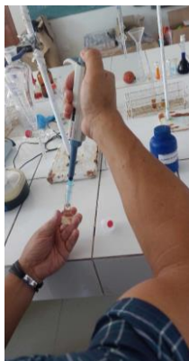
Figura 202: Se tomó 1.5 ml de la preparación de muestra con etanol y se agregó al embudo de separación
