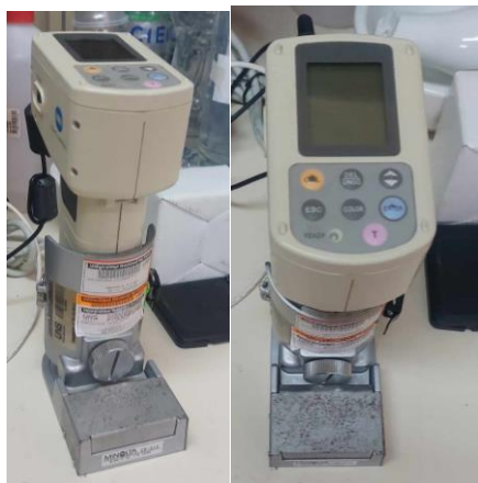
Figura 19: Colorímetro Chroma Meter, Marca Konica Minolta, Modelo Cr – 400, Japón
