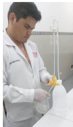
Figura 129: Titulación con NaOH 0.1N a la muestra del pallar
