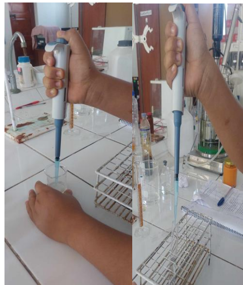
Figura 209: Realización de la dilución con 100ul de muestra orgánica y 10 ml de agua destilada.
