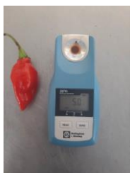
Figura 149: Colocar de 1 a 2 gotas de muestra (ají limo) al refractómetro portátil y anotar
