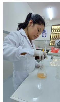
Figura 135: Adición de 3 a 4 gotas de fenolftaleína al 1% a la muestra del ají limo.
