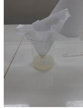
Figura 120: Filtrado la muestra del pallar
