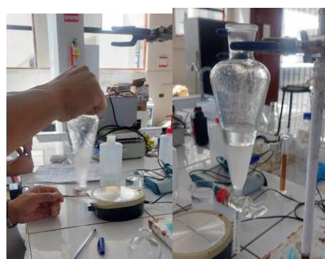
Se agito durante 1 min a temperatura ambiente y se deja reposar hasta que se separe en dos fases
