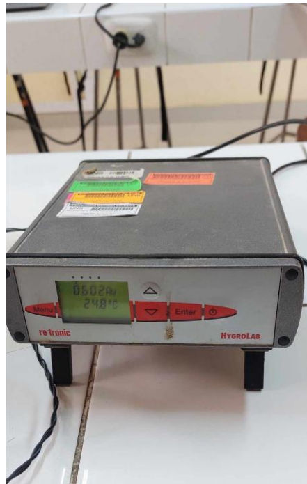
Figura 169: Esperar la estabilidad del equipo
