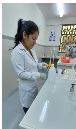
Figura 136: Titulación con NaOH 0.1N a la muestra del ají limo
