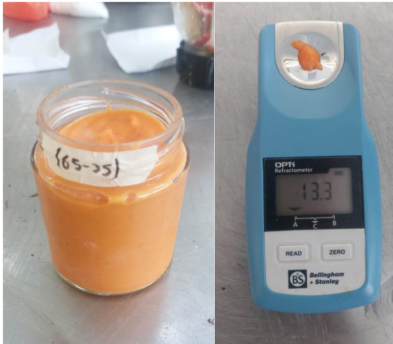
Figura 153: Colocar de 1 a 2 gotas de muestra (salsa) al refractómetro portátil y anotar
