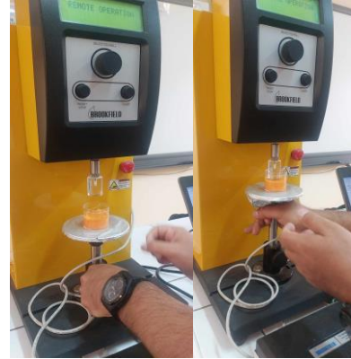
Figura 176: Colocación de la muestra en el texturómetro
