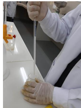
Figura 118: Adición de 100 ml H_2O destilada al pallar machacado
