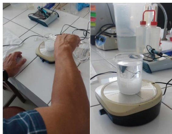
Figura 201: Se le Se preparó la solución sal de amonio tolueno ( NH_4Cl + C_6H_5CH_3 )
