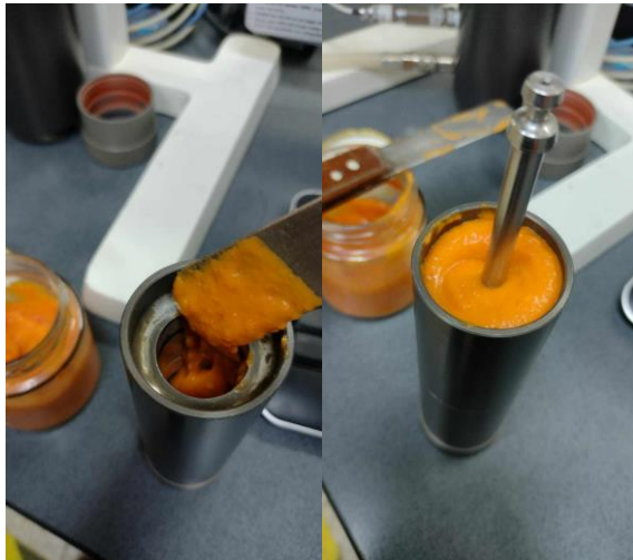
Figura 182: Adición de muestra (salsa) sobre la cubeta del reómetro
