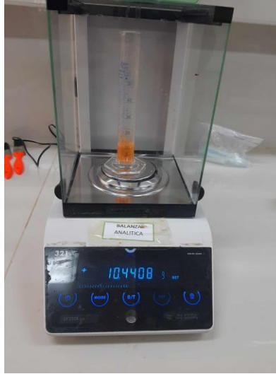
Figura 187: Pesado de la muestra para luego calcular la densidad
