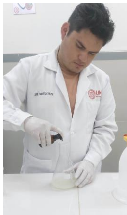
Figura 128: Adición de 3 a 4 gotas de fenolftaleína al 1% a la muestra del pallar
