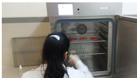
Figura 164: Colocar la muestra (pallar) en la estufa a 105°C por 3h
