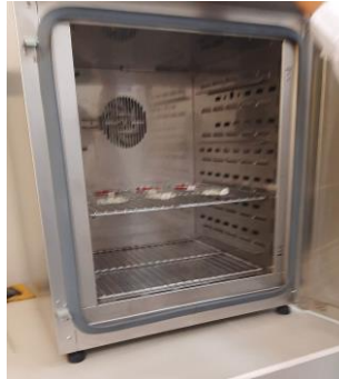
Figura 16: Estufa, Marca Pol- Eko-Aparatura SPJ, Modelo SLW 115, Serie SWITF 121018
