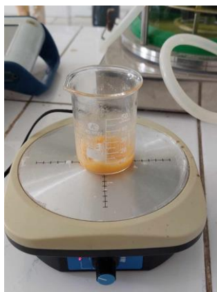
Figura 197: Muestra disuelta con etanol y agitación por 15 min
