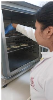
Figura 159: Sacar la muestra (ají limo) de la estufa
