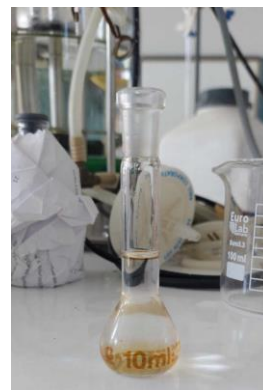
Figura 199: Aforar con 10 ml etanol la muestra
