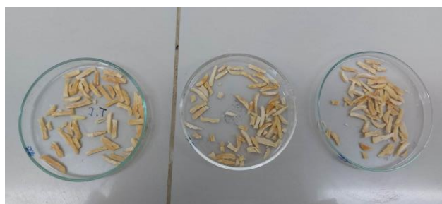
Figura 166: Pesar las muestras (pallar) y realizar el cálculo utilizando la fórmula para la humedad
