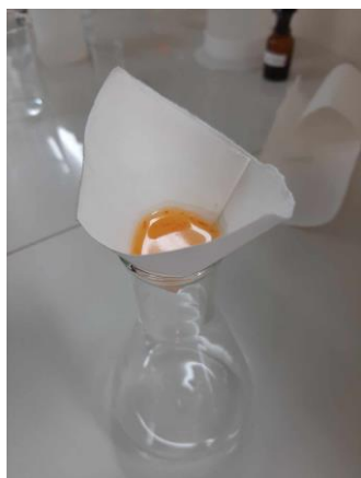
Figura 198: Filtración de la muestra
