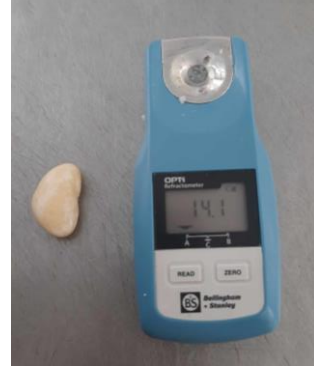
Figura 152: Colocar de 1 a 2 gotas de muestra (pallar) al refractómetro portátil y anotar
