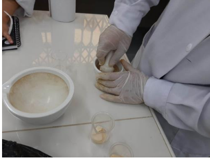
Figura 119: Trituración de la muestra del pallar y agitación constante
