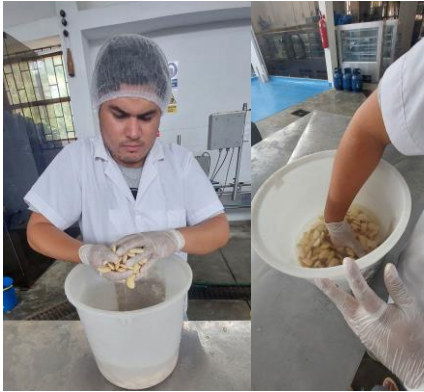
Figura 64: Lavado y desinfectado del pallar
