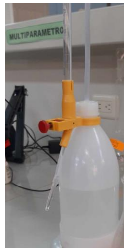
Figura 18: Titulador de NaOH para determinar acidez
