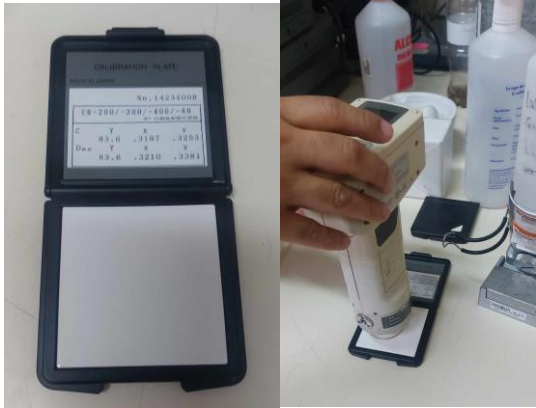
Figura 106: Estabilizar el colorímetro con el calibrador
