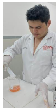
Figura 133: Adición de 100 ml H 2 O destilada al ají limo machacado
