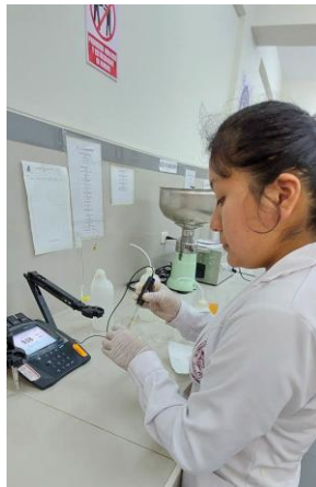
Figura 121: Medición en el pH-metro del pallar
