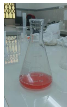
Figura 137: Observar la coloración grosella de la muestra del ají limo y anotar el gasto
