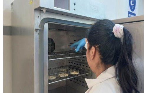
Figura 158: Colocar la muestra (ají limo) en la estufa a 105°C por 3h
