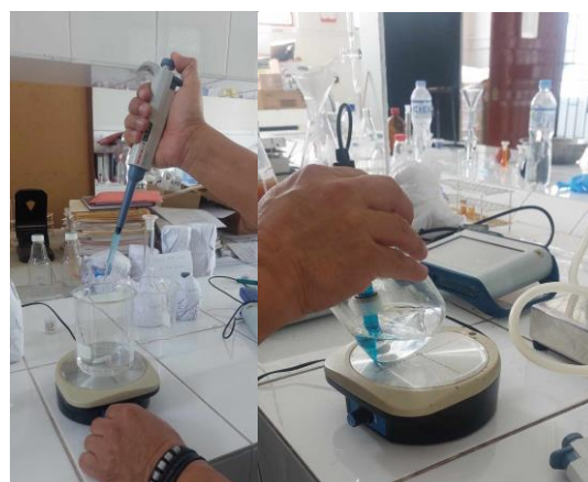
Figura 200: Se preparó la solución amortiguadora de pH 2.8 ( H_2O + HCl )
