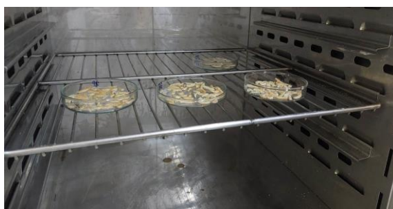
Figura 165: Sacar la muestra (pallar) de la estufa
