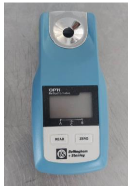
Figura 17: Refractómetro portátil, Marca Opti Handheld, Modelo Bellingham Stanley
