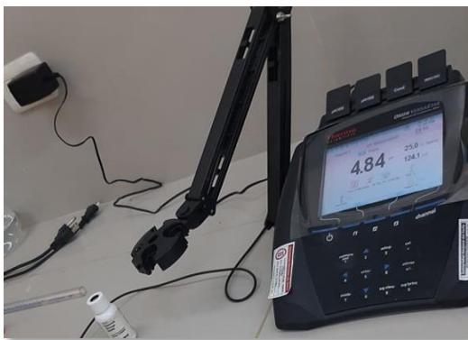
Figura 111: Calibración del equipo (pH-metro) con una solución de pH de 4 y 7
