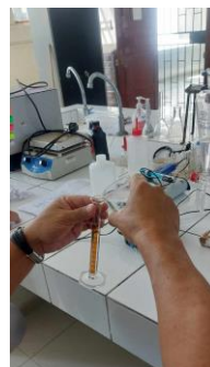
Figura 205: Se le agregó 10.5 ml de agua destilada al embudo de separación
