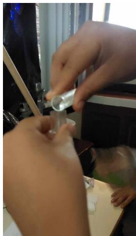
Figura 210: Colocar la dilución en una cubeta para colocarlo en el espectrofotómetro UV-Visible
