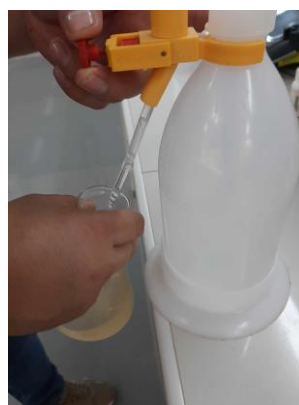
Figura 143: Titulación con NaOH 0.1N a la muestra de la salsa
