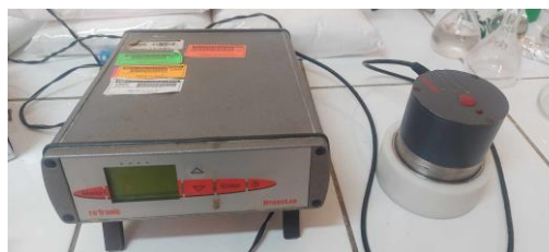
Figura 25: Hidrolab, Marca Rotronic, Modelo Aw- Dio
