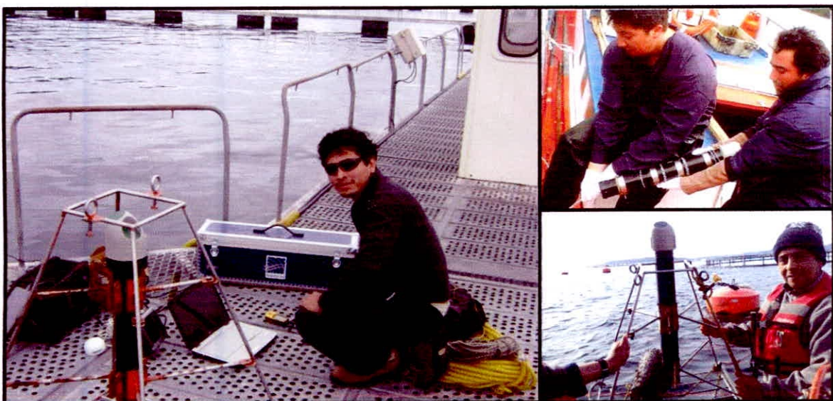
Fig. 8. Programación e instalación del correntómetro ADCP.
