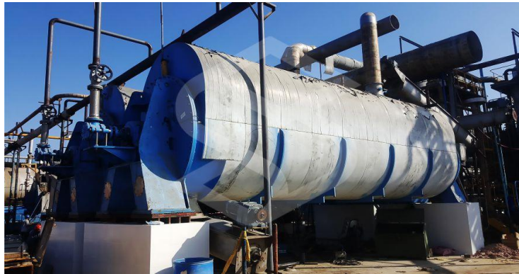
Figura 35. secador rotadisco de 3500 Kg/h
