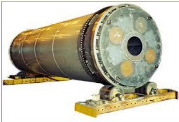
Figura 4. Secador rotatubo a vapor de 12 Ton/h
