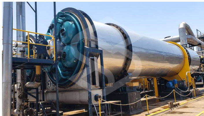
Figura 36. secador rotatubo de 8000 Kg/h
