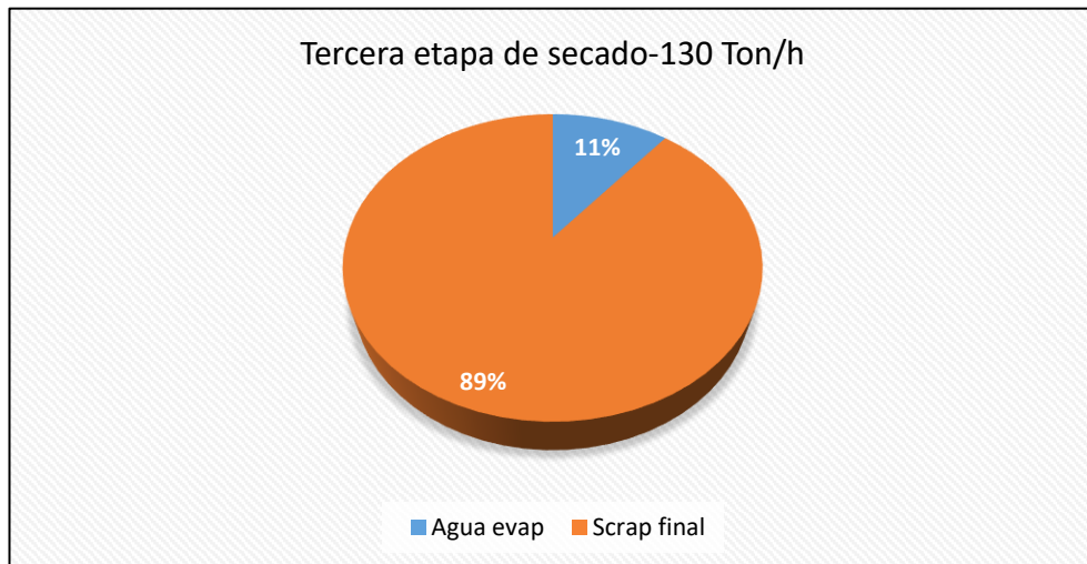
Gráfico 7. Tercera etapa de secado con capacidad de planta de 130 Ton/h Fuente: Elaboración propia
