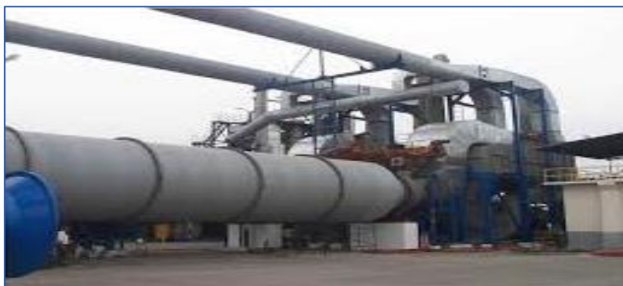
Figura 5. Secador de aire caliente de harina de pescado.
