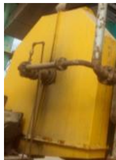
Figura 32: Guarda de seguridad de piñones
