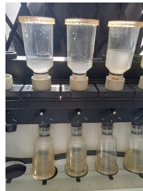
Figura 106: Luego del montaje pasa al proceso de filtración para lo cual se aplica presión y succión.
