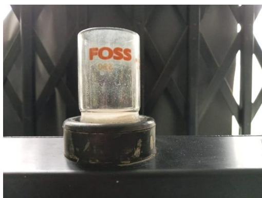
Figura 95: Pesado de los crisoles junto con el 0.5g de celite, para ser luego secado en la estufa.
