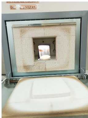
Figura 109: Las muestras secas fueron incineradas a 550°C por 4hr, para luego ser pesadas
