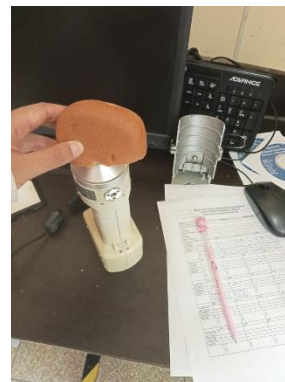
Figura 113: Medición del color de la muestra, en el caso de los bizcocho se midió el color de la corteza y miga.
