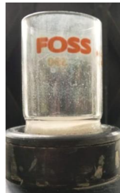
Figura 110: La muestra incinerada fue pesado para determinar la FDT
