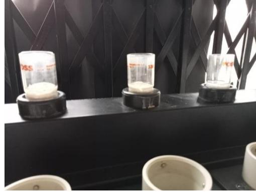
Figura 108: Los crisoles con los residuos fueron secados en la estufa a 105°C por 12h.
