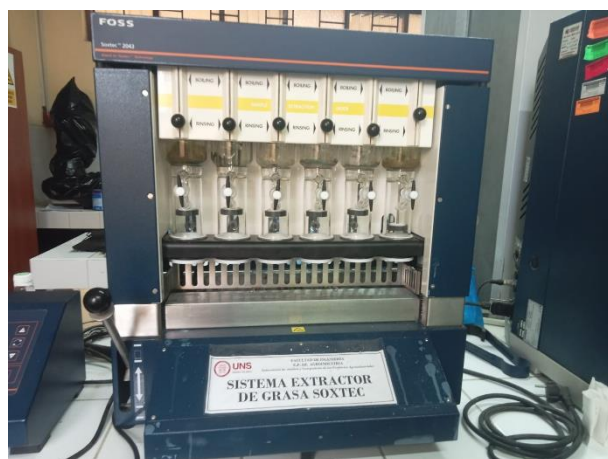
Figura 89: Equipo Soxhlet utilizado para la extracción de grasa de las muestras
