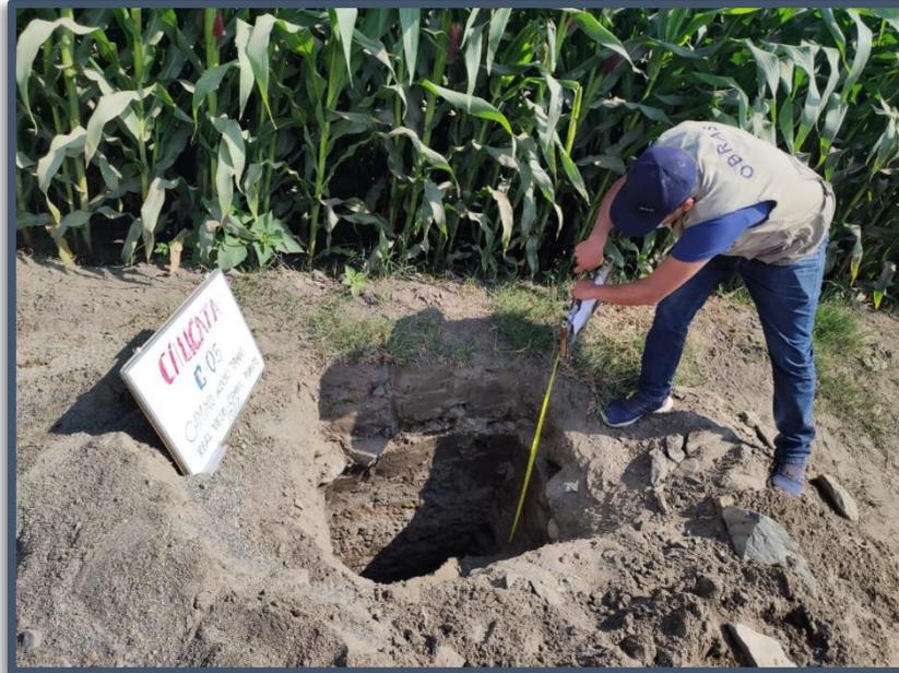
**Figura N°05:** Muestreo de suelos mediante calicata C-05, en la via Tambo Real Viejo – Cambio Puente. MTC E 101
