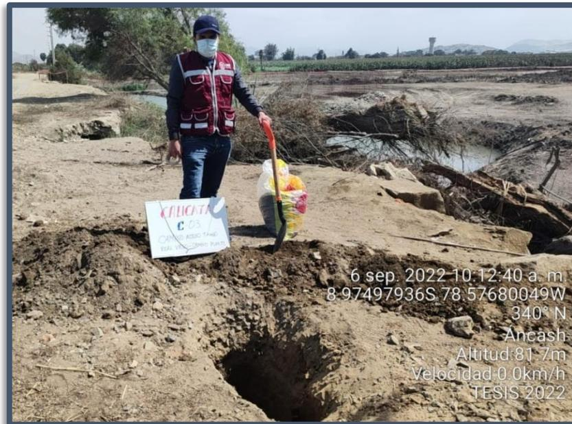
**Figura N°03:** Muestreo de suelos mediante calicata C-03, en la via Tambo Real Viejo – Cambio Puente. MTC E 101
