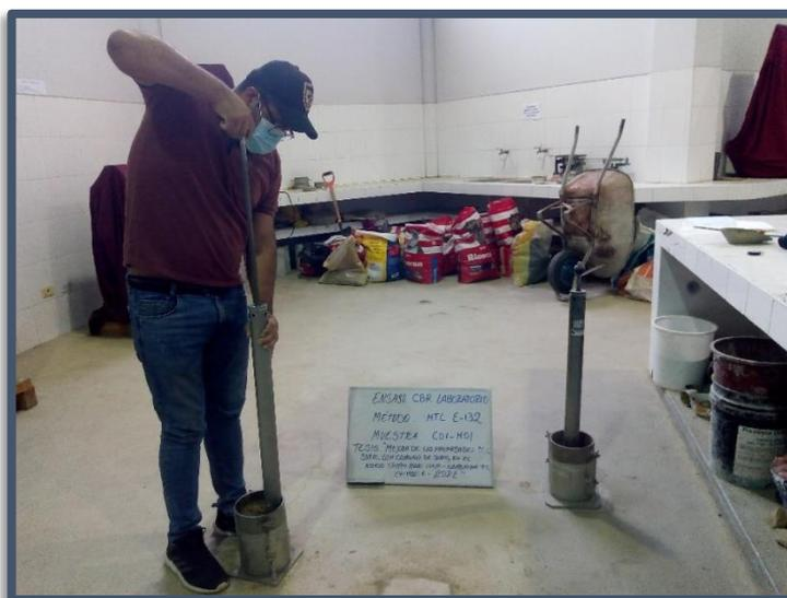
**Figura N°(118 al 121):** Elaboración de especímenes aplicando compactación dinámica a 55, 26 y 12 golpes por capa, CBR En Laboratorio MTC E 132.
