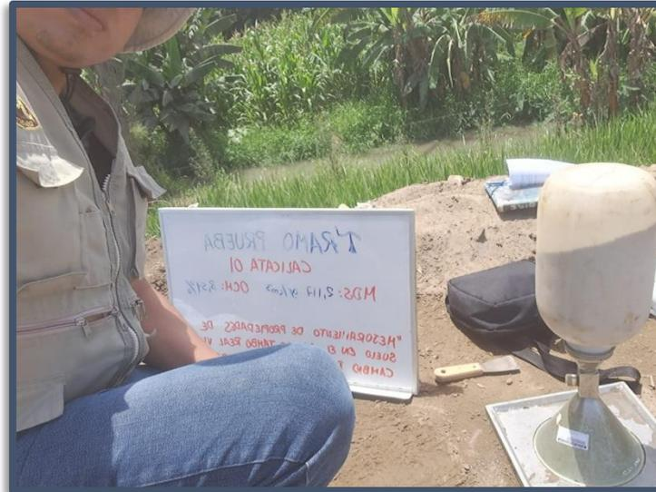
Figura N°(38 al 42): Deyerminación de la densidad de sueloen In Situ en el tramo de prueba 01, haciendo uso del método de cono de arena, MTC E 117.
