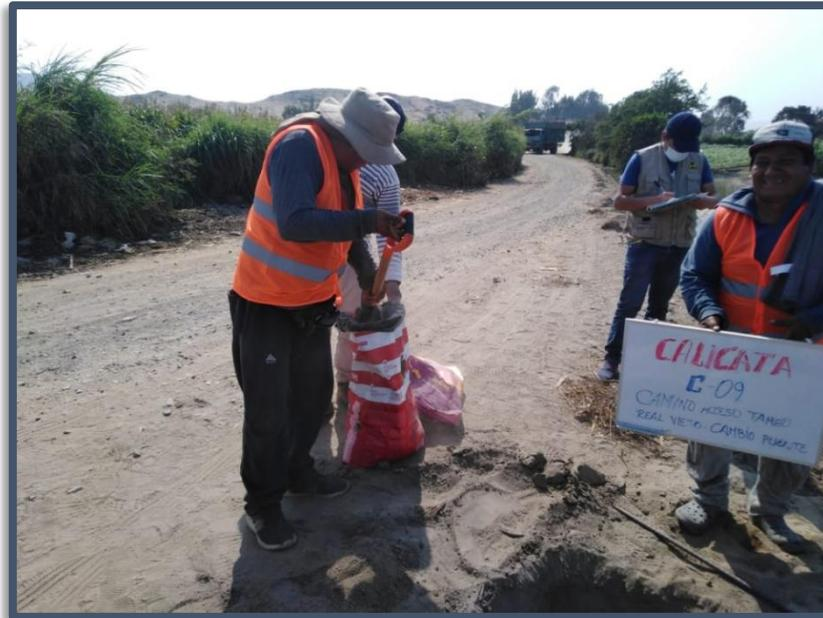
**Figura N°09:** Muestreo de suelos mediante calicata C-09, en la via Tambo Real Viejo – Cambio Puente. MTC E 101
