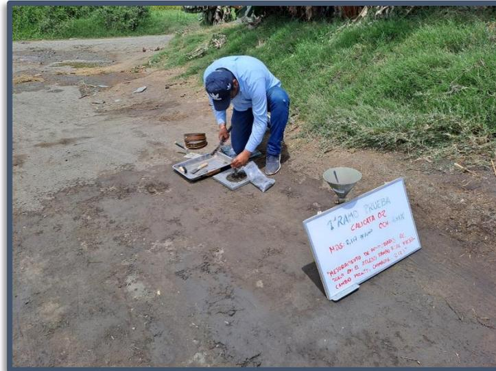
Figura N°(43 al 47): Deyerminación de la densidad de sueloen In Situ en el tramo de prueba 02, haciendo uso del método de cono de arena, MTC E 117.
