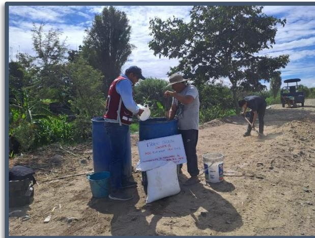
**Figura N° 19, 20, 21 y 22:** Dosificación al 5% de NaCl en funcion al peso seco de la muestra, preparado a modo de salmuera en OCH obtenido el laboratorio.
