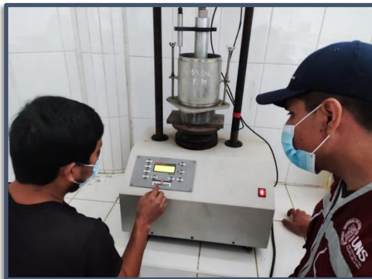
**Figura N°(129 al 131)** Penetración en prensa con velocidad y carga controladas, CBR En Laboratorio MTC E 132.
