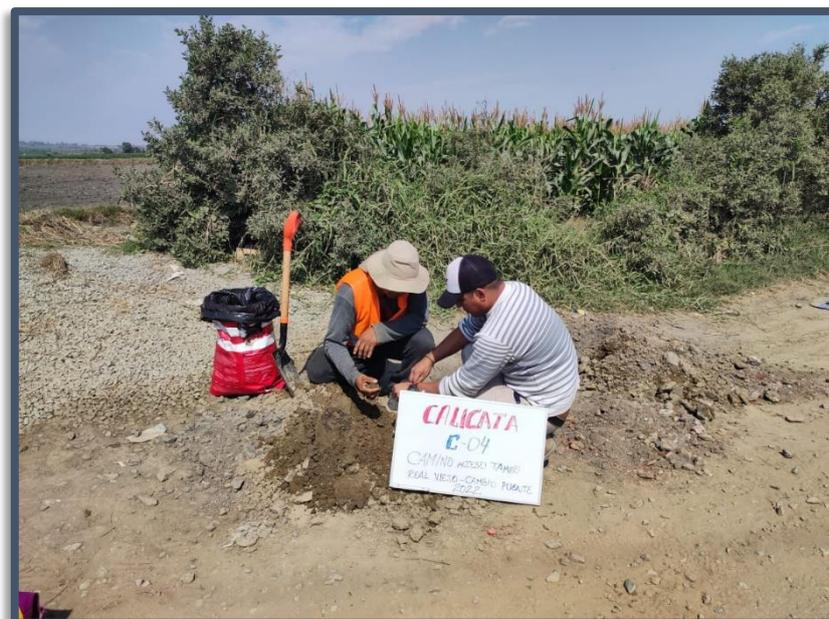
**Figura N°04:** Muestreo de suelos mediante calicata C-04, en la via Tambo Real Viejo – Cambio Puente. MTC E 101
