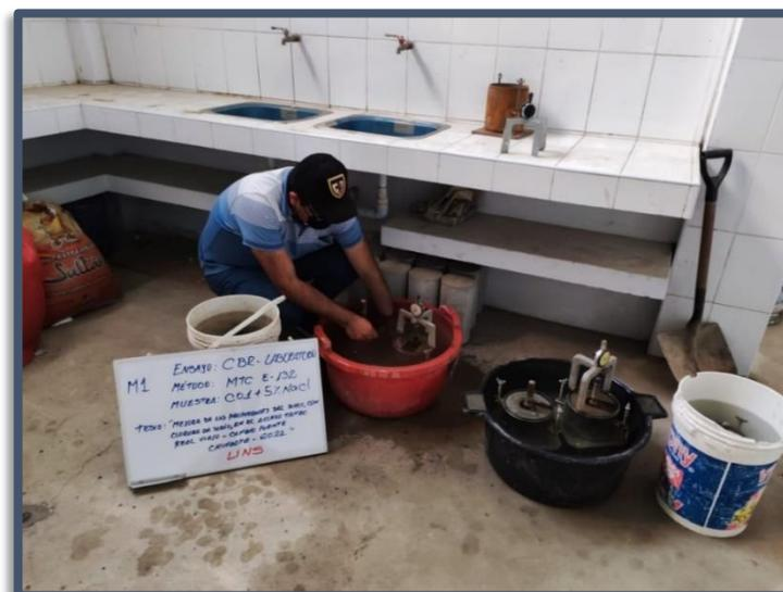
**Figura N°(144 al 147):** Proceso de Inmersión y control de lecturas para Hinchamiento durante 96 horas, CBR En Laboratorio MTC E 132.
