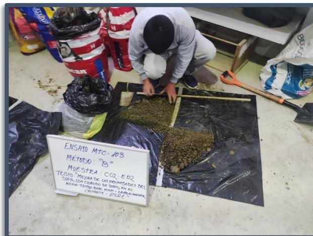
Figura N°50, 51, 52 y 53: Obtención en laboratorio de muestras representativas, mediante Cuarteo Manual. MTC
