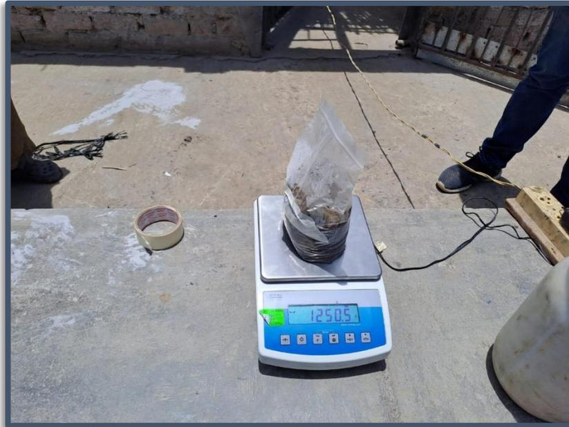
**Figura N°48:** Extracción de muestra de suelo de aparato de cono de densidad, para determinación de peso y humedad.
