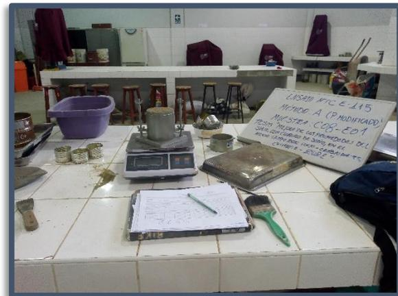
**Figura N°(92 al 96):** Proceso de compactación, enrase y pesaje para el Ensayo de compactación de suelo natural, usando Proctor Modificado (Metodo A) MTC E 115.
