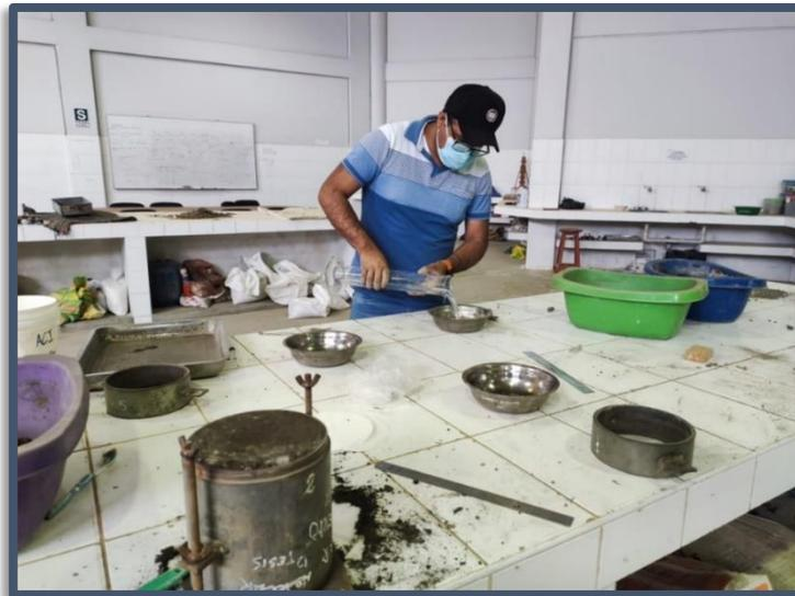
**Figura N°(135 al 137) Preparación del Cloruro de Sodio para los especímenes, CBR En Laboratorio MTC E 132.**
