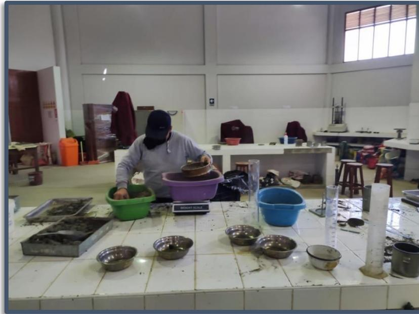
**Figura N°(115, 116 y 117):** Preparacion de la muestra natural, en función a los resultados de Proctor de Laboratorio y dimensionamiento de moldes y accesorios, CBR En Laboratorio MTC E 132.
