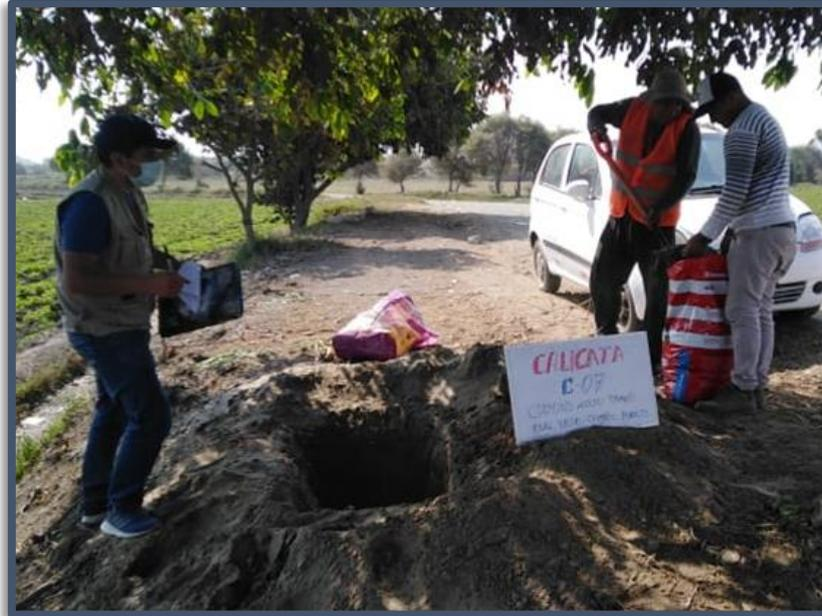
**Figura N°07:** Muestreo de suelos mediante calicata C-07, en la via Tambo Real Viejo – Cambio Puente. MTC E 101
