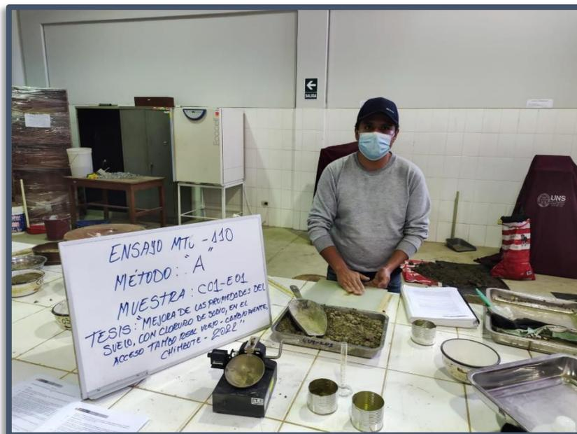
Figura N°(77 al 81): Determinación del Límite Plástico e Índice de Plasticidad de las muestras de suelo . MTC E-111
