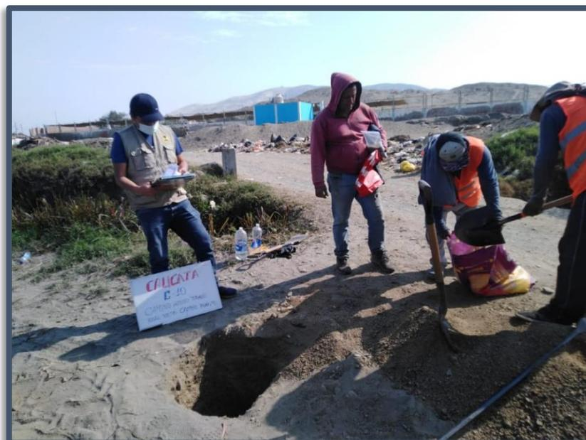
**Figura N°10:** Muestreo de suelos mediante calicata C-10, en la via Tambo Real Viejo – Cambio Puente. MTC E 101
