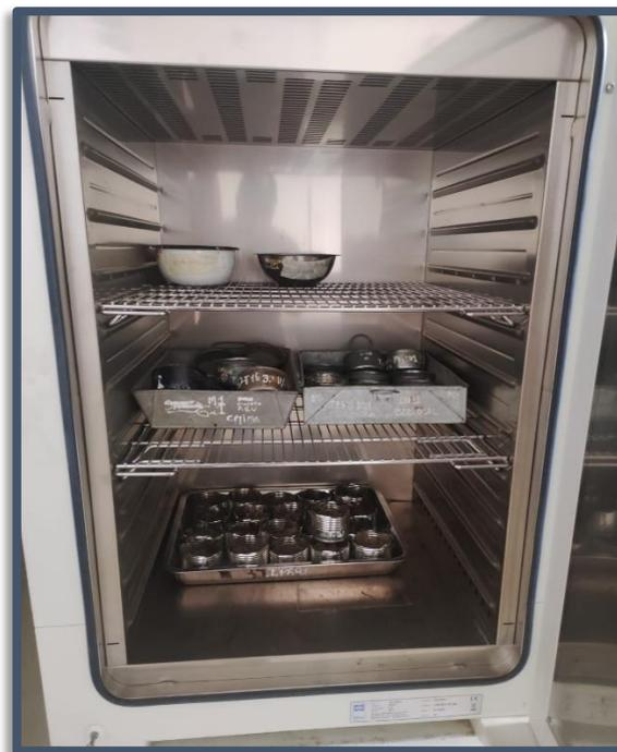
**Figura N°(72 al 76):** Determinación del contenido de humedad de las muestras multipunto para el Límite Líquido.
