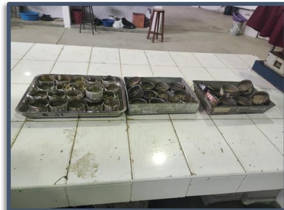
**Figura N°(64 al 68):** Determinación del contenido de humedad del suelo. MTC E-108
