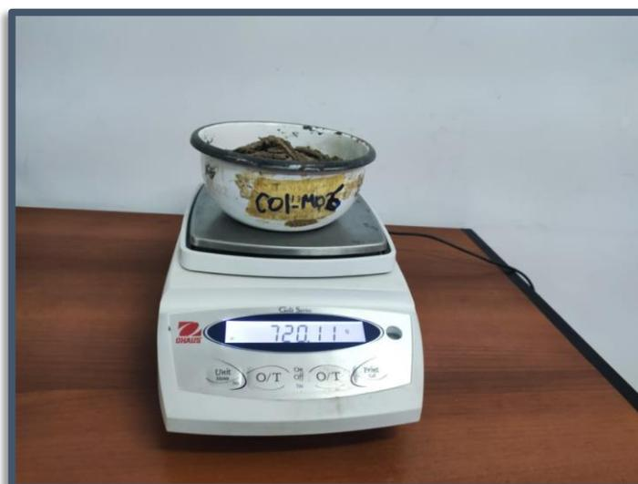
**Figura N°(112, 113 y 114):** Control de humedad para Ensayo de compactación de suelo modificado, usando Proctor Modificado (Metodo A) MTC E 115.
