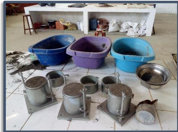
**Figura N°(107 al 111):** Proceso de compactación, enrase y pesaje para el Ensayo de compactación de suelo mejorado, usando Proctor Modificado (Metodo A) MTC E 115.
