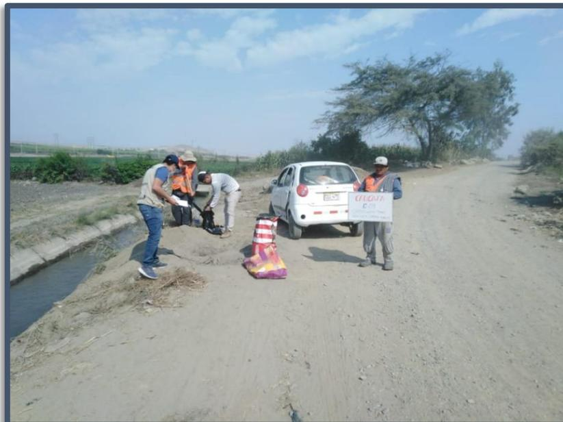
**Figura N°06:** Muestreo de suelos mediante calicata C-06, en la via Tambo Real Viejo – Cambio Puente. MTC E 101
