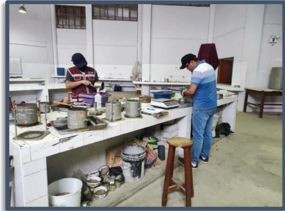
**Figura N°(138 al 141):** Preparacion de la muestra mejorada, en función a los resultados de Proctor de Laboratorio, CBR en Laboratorio MTC E 132.
