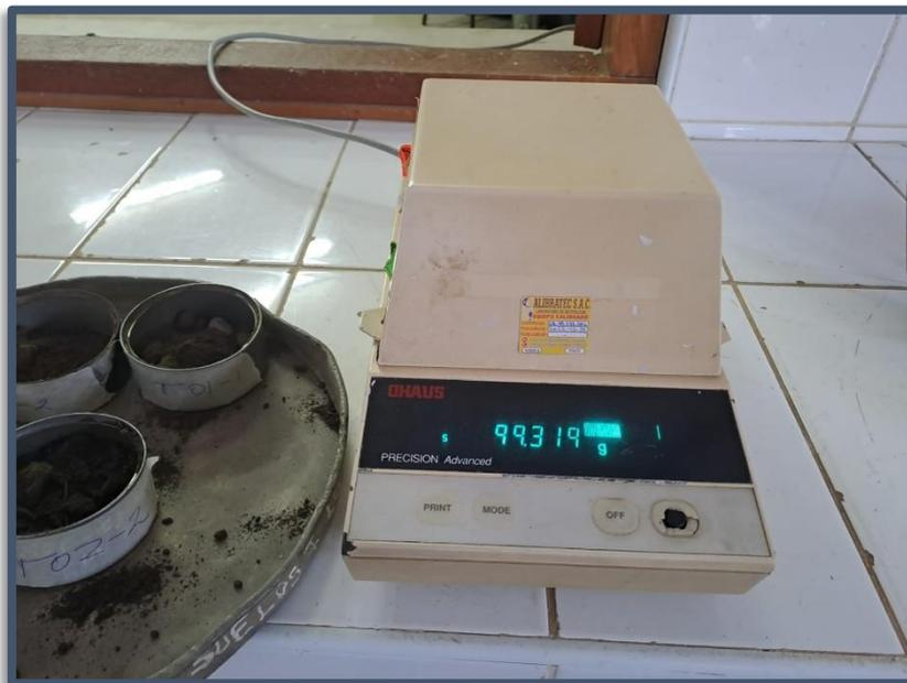
**Figura N°(43 al 47):** Determinación de humedad de suelo el laboratorio, para comparación con la humedad óptima, obtenida en laboratorio.
