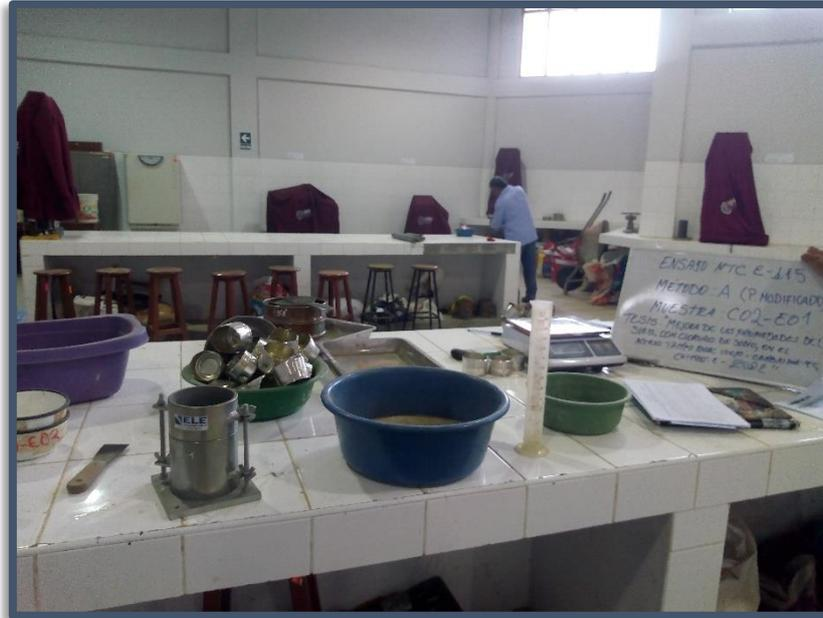
**Figura N°(89, 90 y 91):** Calibración y preparación de aparatos de acuerdo a norma para el Ensayo de compactación de suelo en estado natural, usando Proctor Modificado (Metodo A) MTC E 115,
