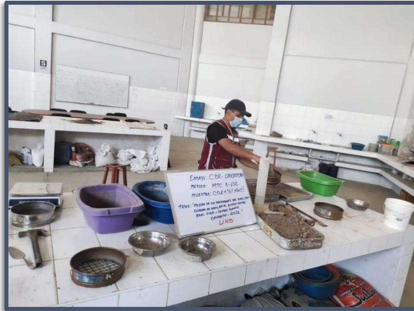
**Figura N°(100, 101 y 102):** Ensayo de compactación de suelo adicionando porcentajes de NaCl, usando Proctor Modificado (Metodo A) MTC E 115, pesaje de los materiales recomendados por norma.
