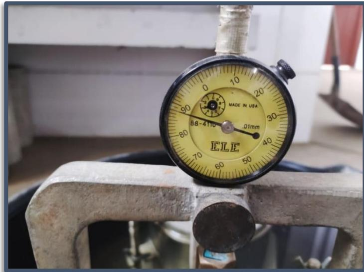
**Figura N°(125 al 128):** Proceso de Inmersión y control de lecturas para Hinchamiento durante 96 horas, CBR En Laboratorio MTC E 132.
