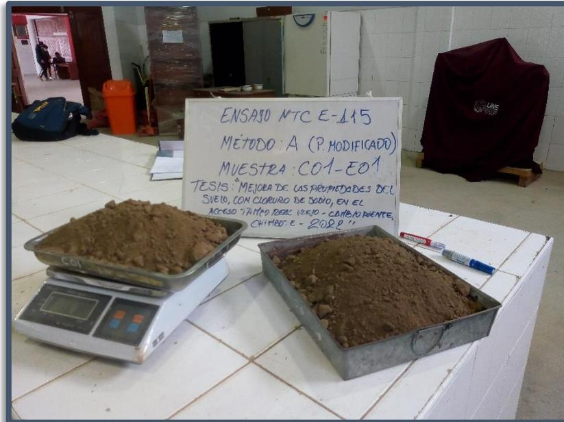
**Figura N°(87 y 88):** Ensayo de compactación de suelo en estado natural, usando Proctor Modificado (Metodo A) MTC E 115, pesaje de los materiales recomendados por norma.
