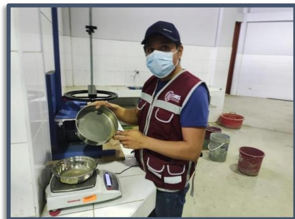
Figura N°(59 al 63): Análisis granulométrico de suelos por tamizado con separación de finos por lavado. MTC E-107
