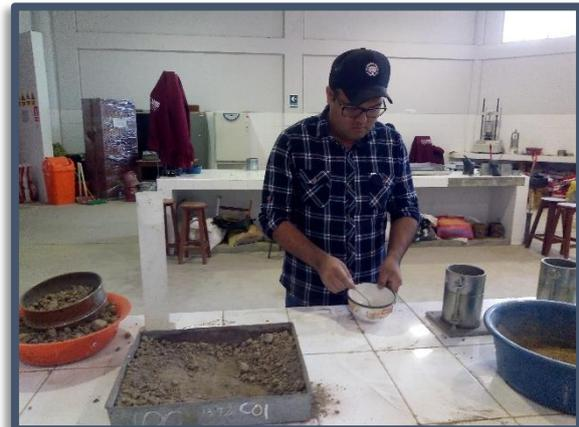
**Figura N°(105 y 106):** Preparación de NaCl para su aplicación en las muestras de suelo en forma de salmuera para el Ensayo de compactación de suelo mejorado, usando Proctor Modificado (Metodo A) MTC E 115.
