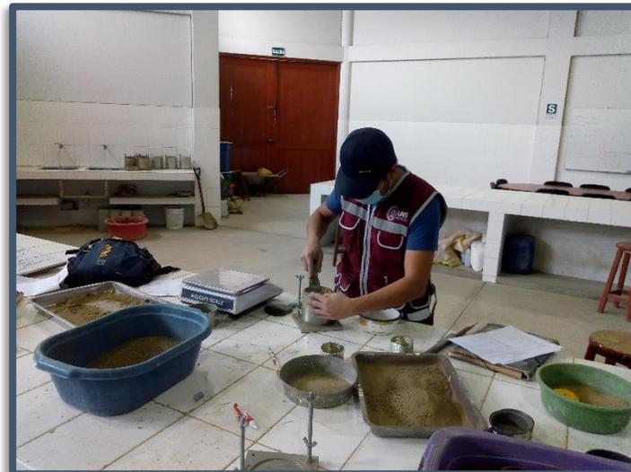
**Figura N°(97, 98 y 99):** Control de humedad para Ensayo de compactación de suelo natural, usando Proctor Modificado (Metodo A) MTC E 115.
