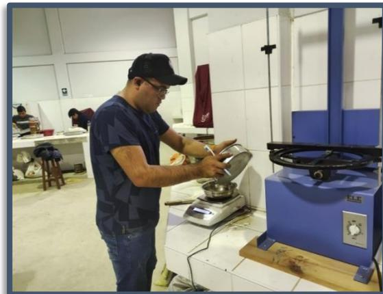
Figura N°(54 al 58): Análisis granulométrico de suelos por tamizado con muestra completa. MTC E-107
