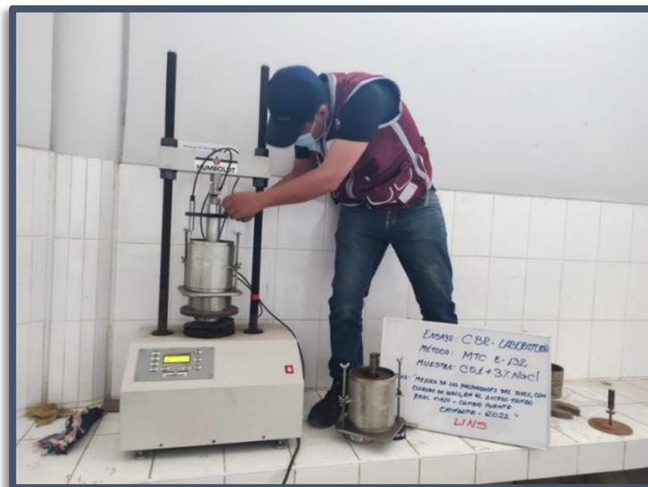
Figura N°(151 al 153) Penetración en prensa con velocidad y carga controladas, CBR En Laboratorio MTC E 132.
