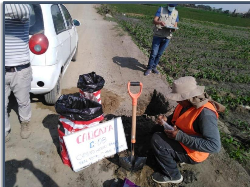
**Figura N°08:** Muestreo de suelos mediante calicata C-08, en la via Tambo Real Viejo – Cambio Puente. MTC E 101
