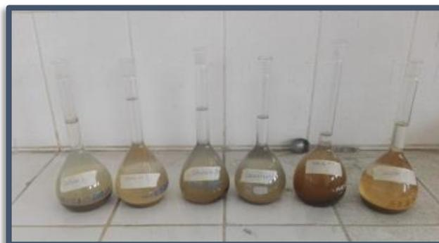
**Figura N°(82 al 86):** Determinación de la Gravedad Específica de solidos de las muestras de suelo mediante Picnómetro de agua. MTC E-111
