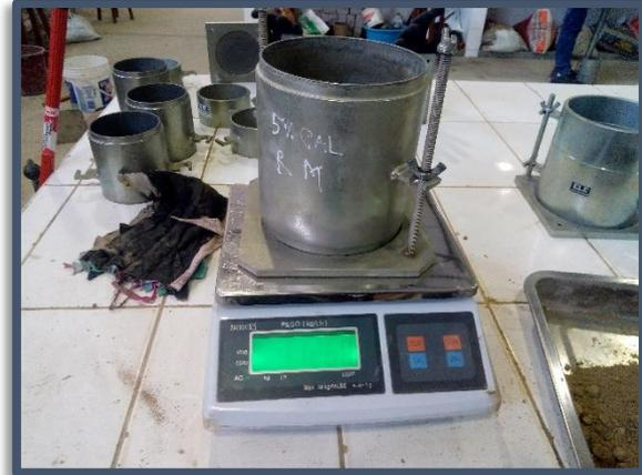
**Figura N°(103 y 104):** Calibración y preparación de aparatos de acuerdo a norma para el Ensayo de compactación de suelo usando NaCl, usando Proctor Modificado (Metodo A) MTC E 115.
