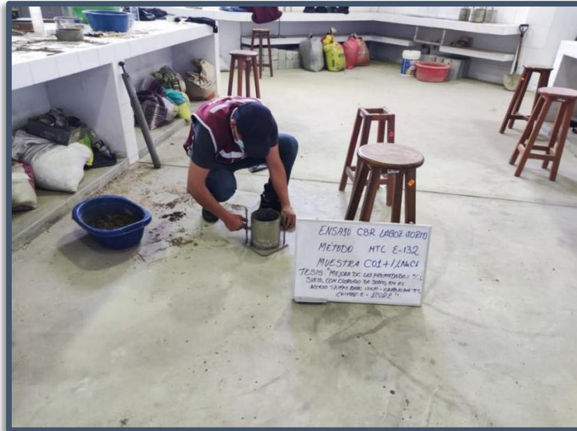
**Figura N°(142, 143):** Elaboración de especímenes aplicando compactación dinámica a 55, 26 y 12 golpes por capa, CBR En Laboratorio MTC E 132.
