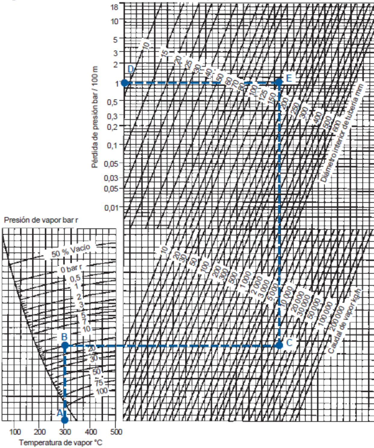
Anexo A-03: Gráfico de dimensionado de tuberías de vapor (método de la caída de presión)
