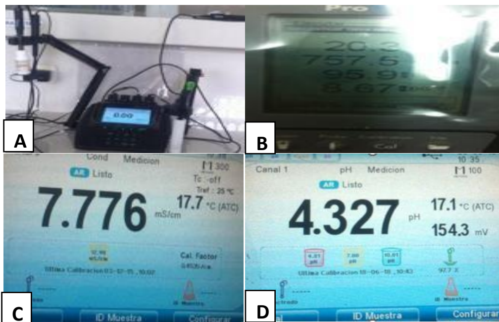
Figura 21. Caracterización físicoquímica del Lactosuero, A. Multiparámetro Thermo Scientific del IITA de la UNS, B. La data arrojó 8.67mg/L de OD., C. El análisis arrojó 7.7 ms/cm de conductividad., D. Medición del pH de la muestra.
