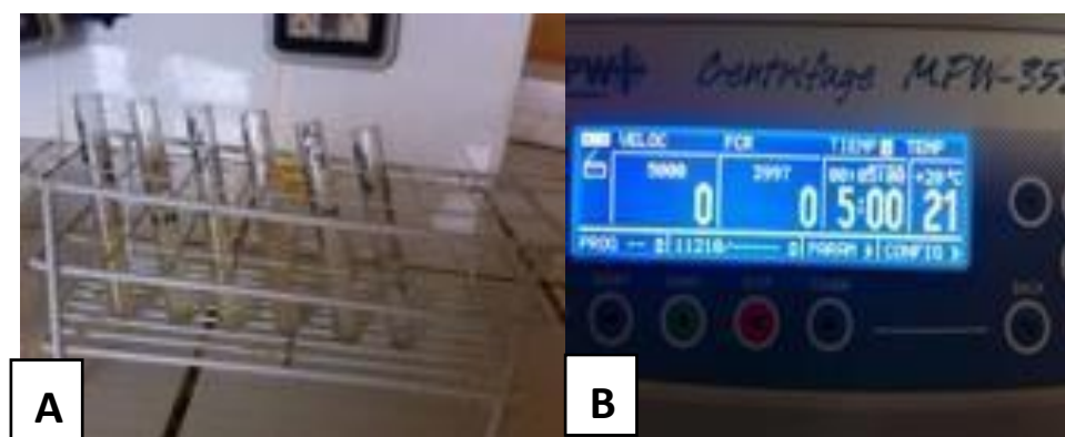
Figura 22. A. Muestras de 1 mL del caldo de fermentación de cada tratamiento colocados tubos, B. Tubos de ensayo llevados a la centrifuga a 5 000 RPM, por un tiempo de 5 minutos.
