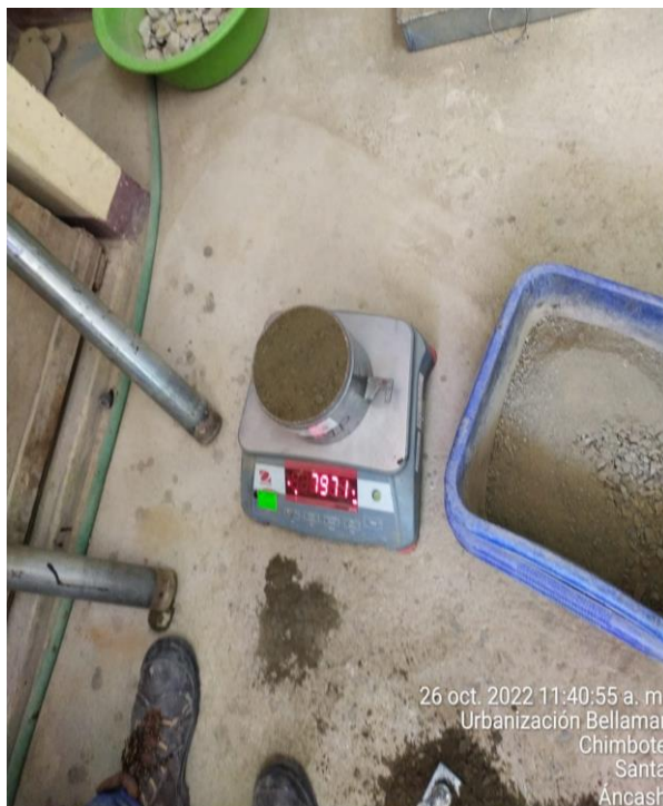
Fotografía N° 20.- Obtención de una porción representativa de material para determinar el contenido de humedad.
