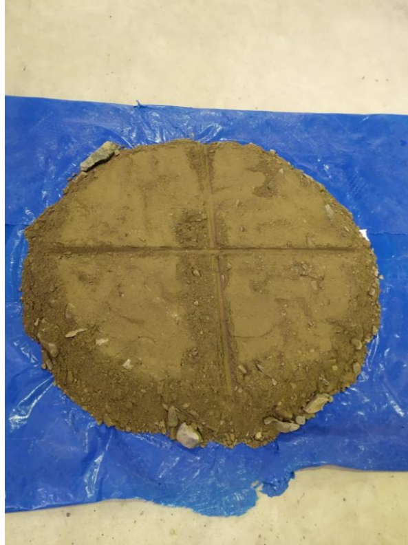
Fotografía N° 03.- Cuarteo del material granular traído de cantera.
