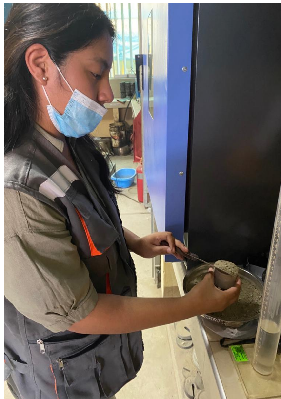
Fotografía N° 12.- Colocación de la muestra pasante del tamiz N°4 de material de cantera, para el Ensayo Equivalente de Arena.
