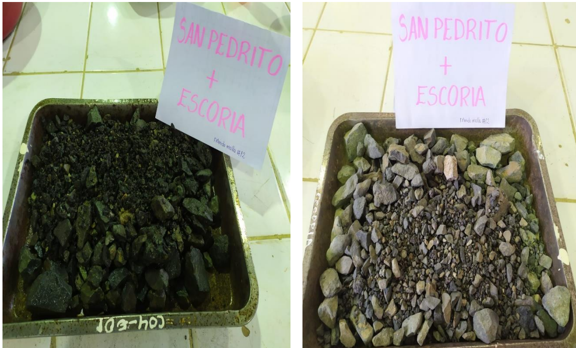
Fotografía N° 35.- Muestra de combinación de material granular de la Cantera San Pedrito + EHAE, retenido en la malla N°12- Ensayo de Abrasión los Ángeles.
