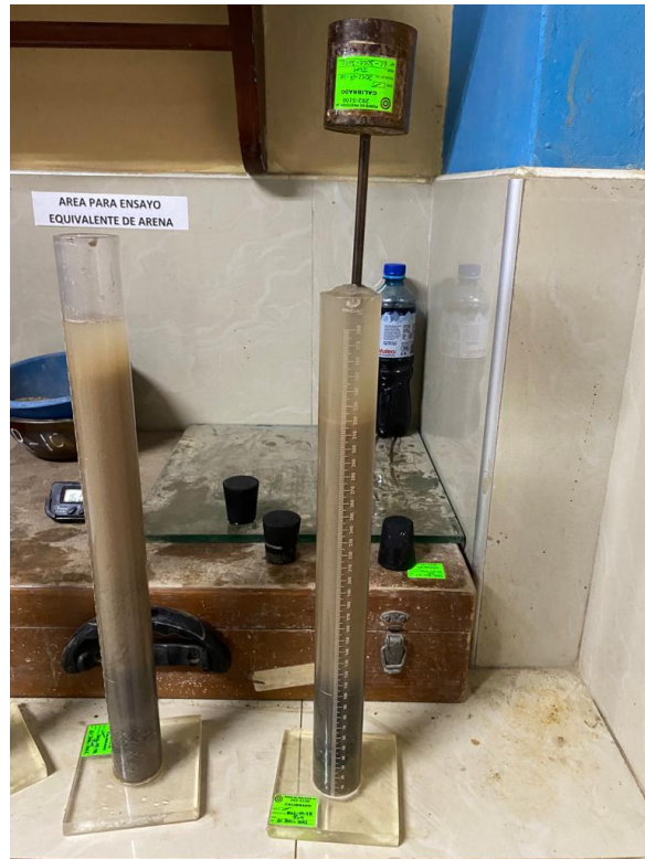
Fotografía N° 17.- Lectura del ensayo equivalente de arena de la combinación material de cantera + EHAE.
