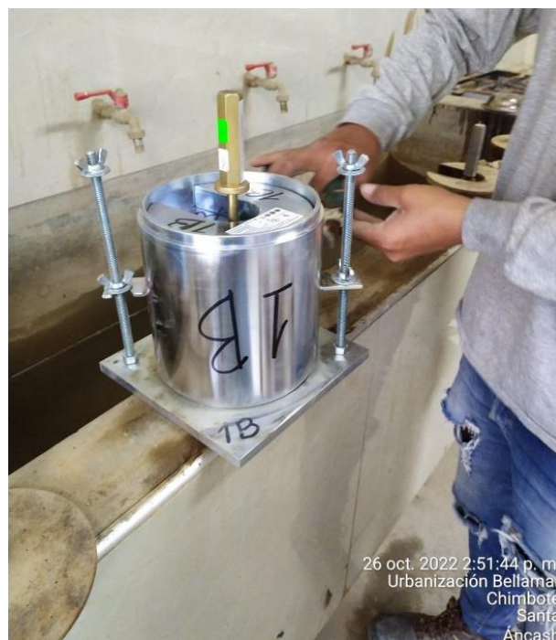
Fotografía N° 22.- CBR - Colocación de las sobrecargas en la superficie de la muestra compactada.
