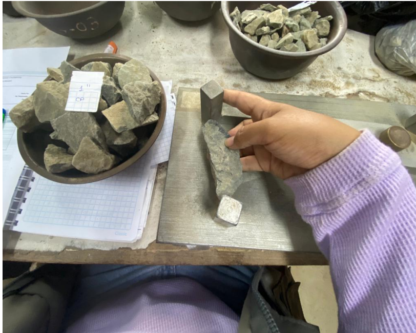
Fotografía N° 37.- Ensayo de partículas chatas y alargadas en los agregados.
