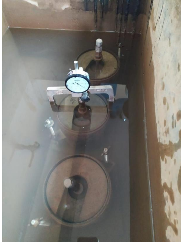
Fotografía N° 23.- Colocación del trípode con el dial para la realización de la lectura de la expansión del suelo luego de un periodo de 4 días sumergido en agua.
