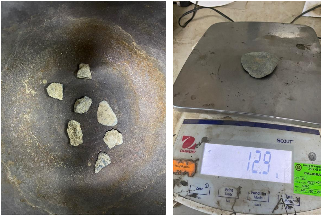
Fotografía N° 39.- Ensayo de partículas fracturadas en los agregados gruesos.
