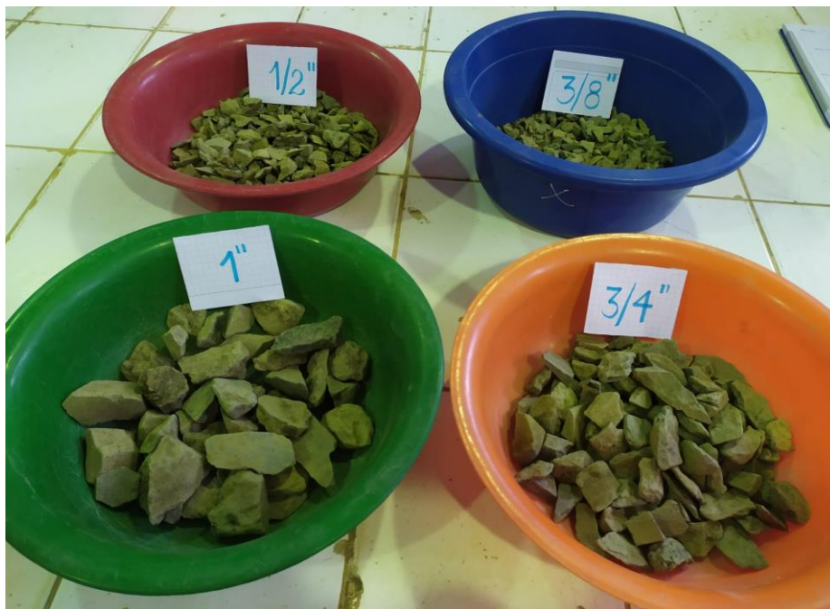
Fotografía N° 30.- Muestra del material granular la cantera para el ensayo de Abrasión Los Ángeles.
