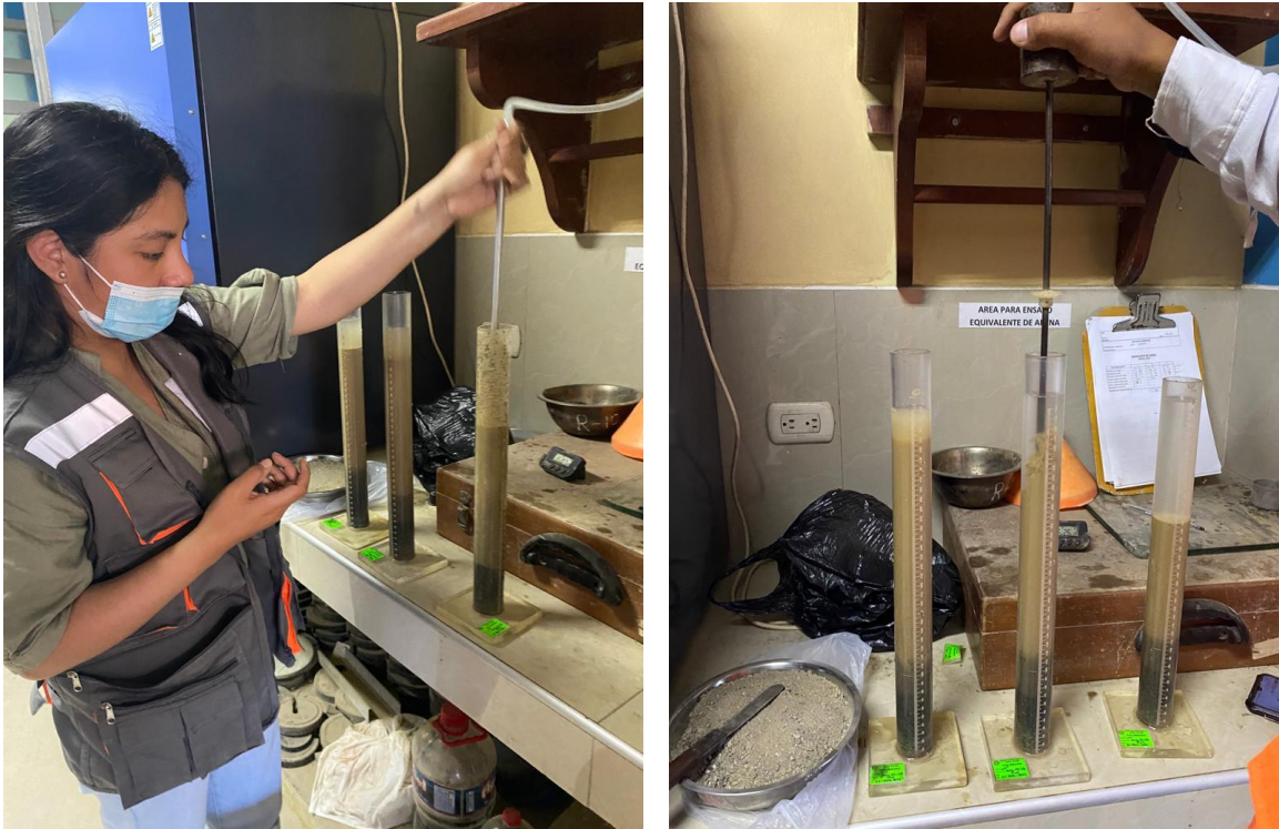
Fotografía N° 15.- Llenado de la probeta con la solución y toma de lectura luego de 20 minutos de hacer presión con el pistón para que los finos queden en la superficie.
