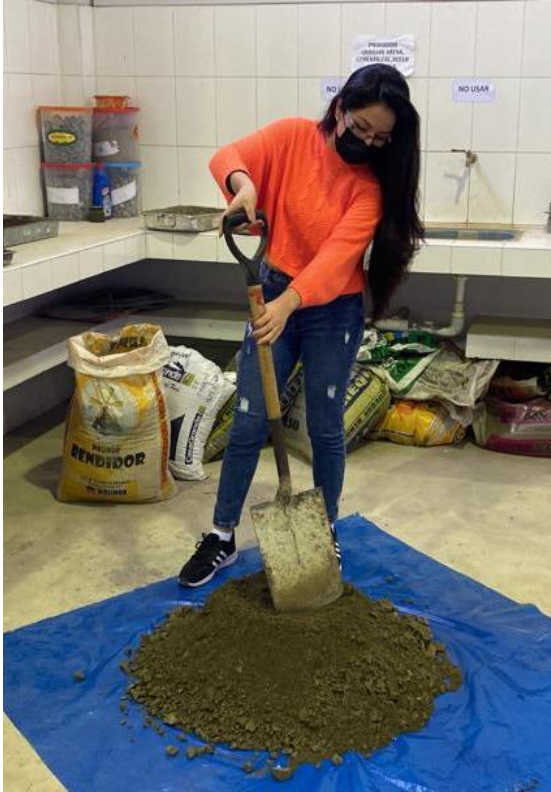
Fotografía N° 03.- Cuarteo del material granular traído de cantera.
