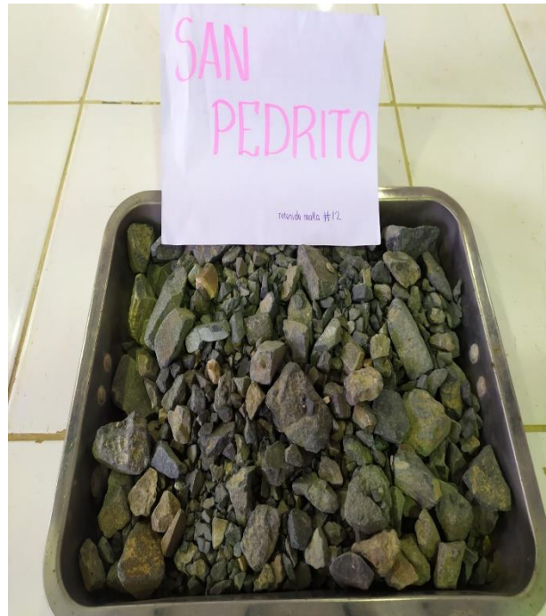
Fotografía N° 34.- Lavado y secado de la muestra retenida en el tamiz N°12.
