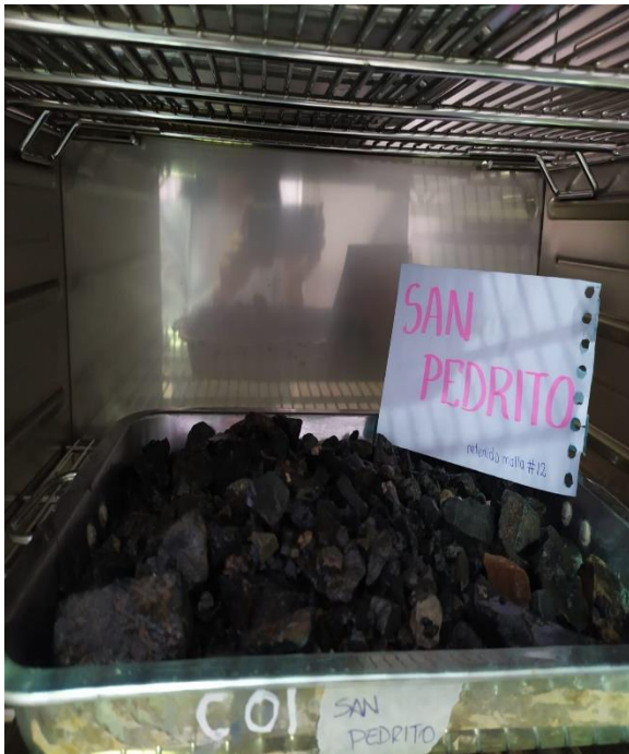
Fotografía N° 34.- Lavado y secado de la muestra retenida en el tamiz N°12.
