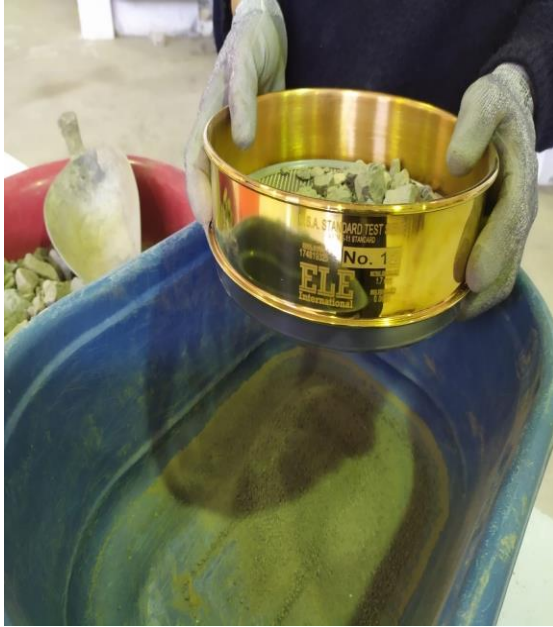
Fotografía N° 33.- Material retirado de la Máquina de los Ángeles para posteriormente realizar la separación de la muestra sobre el tamiz N°12.
