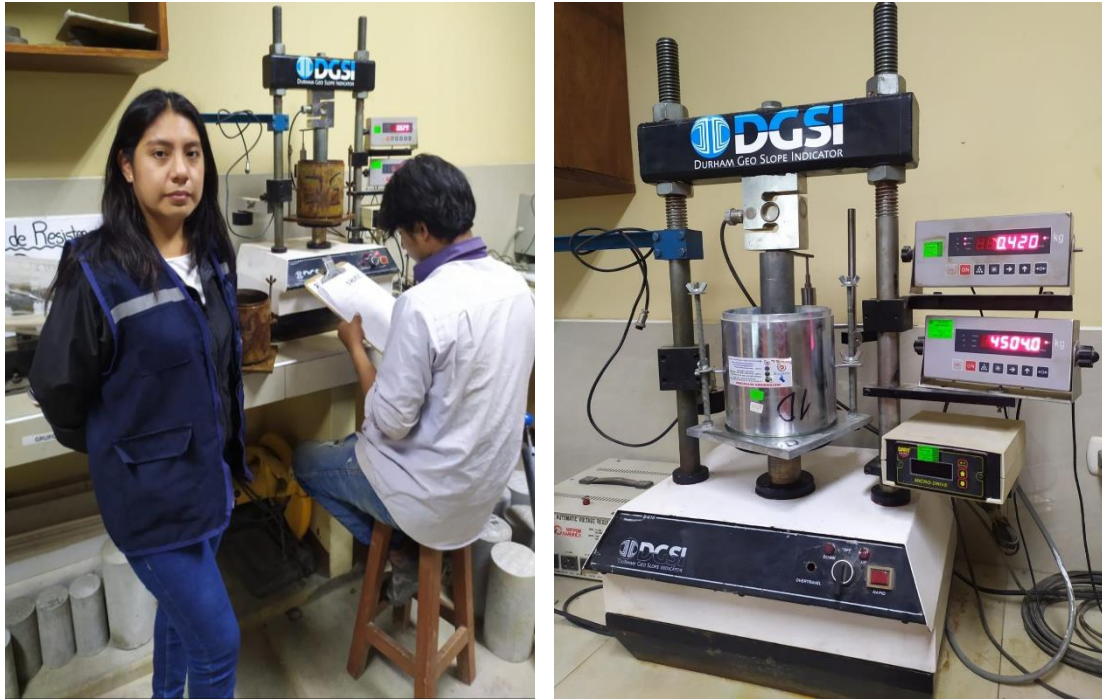
Fotografía N° 25.- Colocación de la muestra en la Máquina CBR para su posterior lectura.
