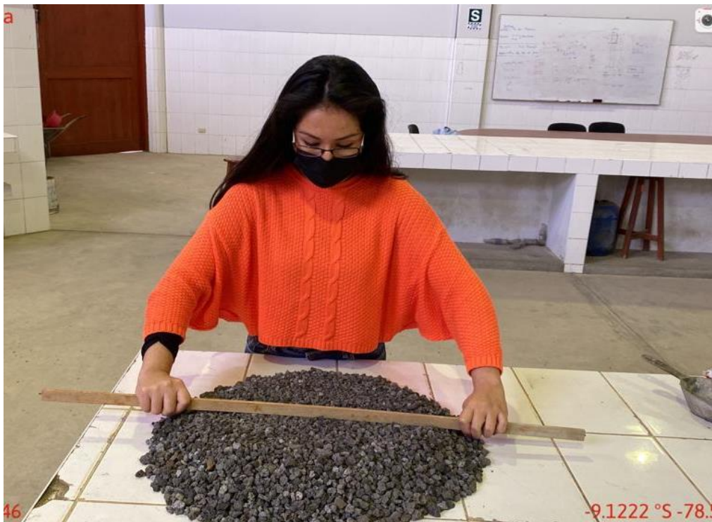
Fotografía N° 08.- Cuarteo de la muestra de EHA proveniente de SiderPerú.
