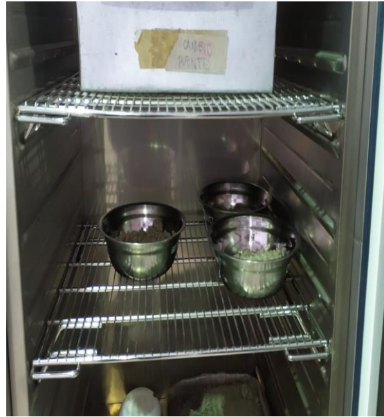
Fotografía N° 31.- Lavado y secado de la muestra, por fracciones separadas, del material granular de cantera.
