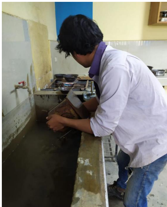
Fotografía N° 24.- Retiro de los moldes del agua transcurrido los 4 días - CBR
