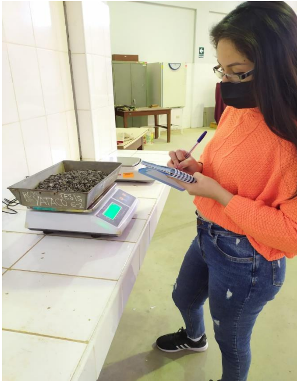
Fotografía N° 09.- Pesado y tamizado de la muestra de EHAE para la determinación de su granulometría.
