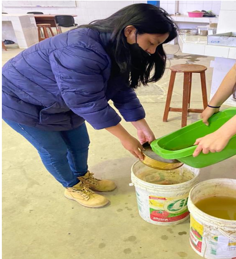
Fotografía N° 05.- Lavado de la muestra para granulometría.
