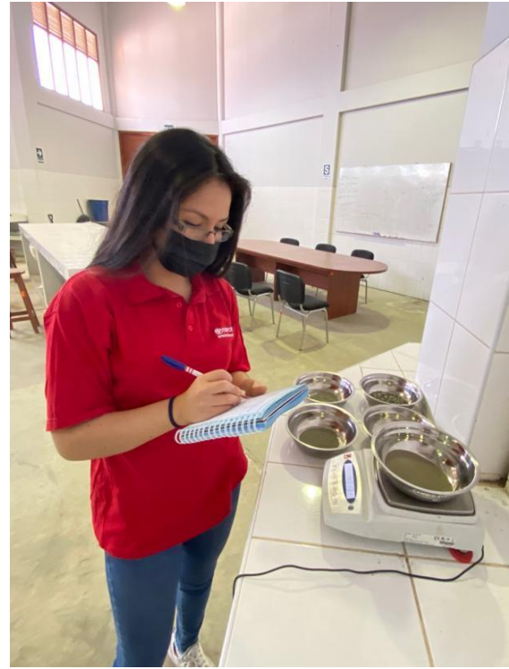
Fotografía N° 07.- Tamizado y pesaje de la muestra para la determinación de su granulometría.
