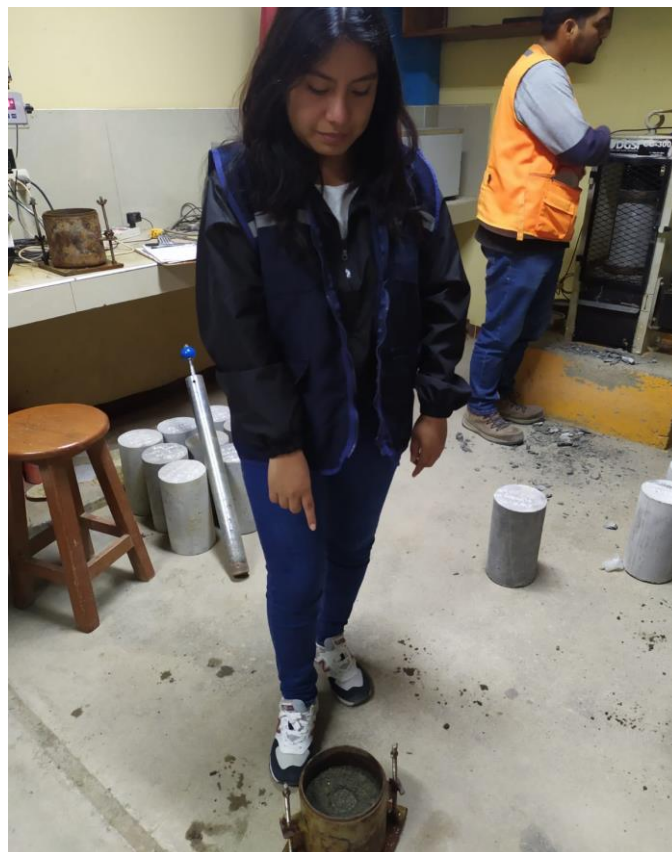
Fotografía N° 26.- Muestra patrón de cantera luego de la penetración en la Máquina CBR.
