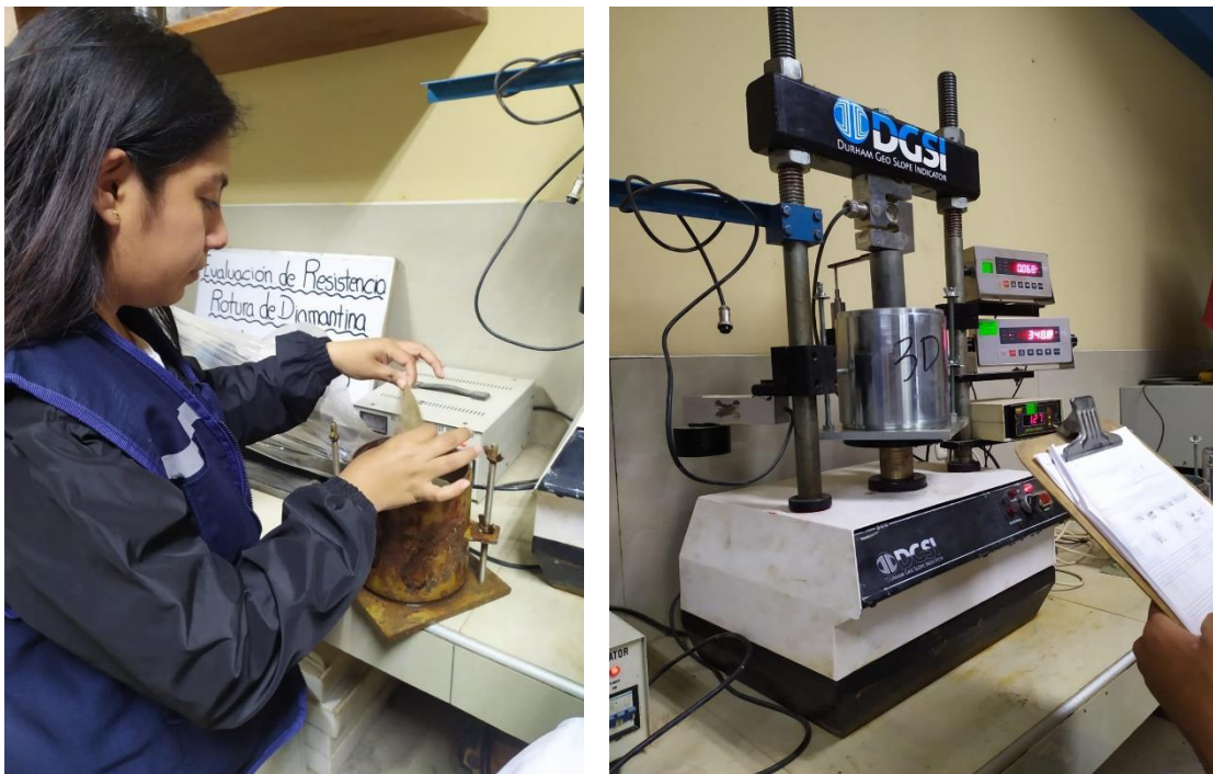
Fotografía N° 28.- Colocación de la muestra en la Máquina CBR para su posterior lectura.
