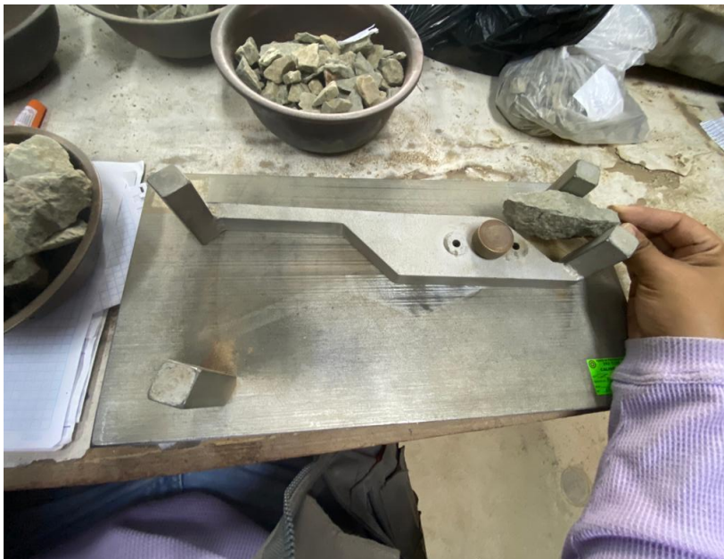
Fotografía N° 38.- Clasificación de cada partícula del material granular, en uno de los tres grupos: chatas, alargadas y ni chatas ni alargadas, mediante el calibrador de grosores.
