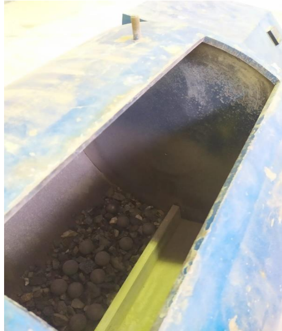
Fotografía N° 32.- Colocación de la muestra seca en la Máquina de los Ángeles para ser ensayada a 30 rpm por 500 revoluciones.
