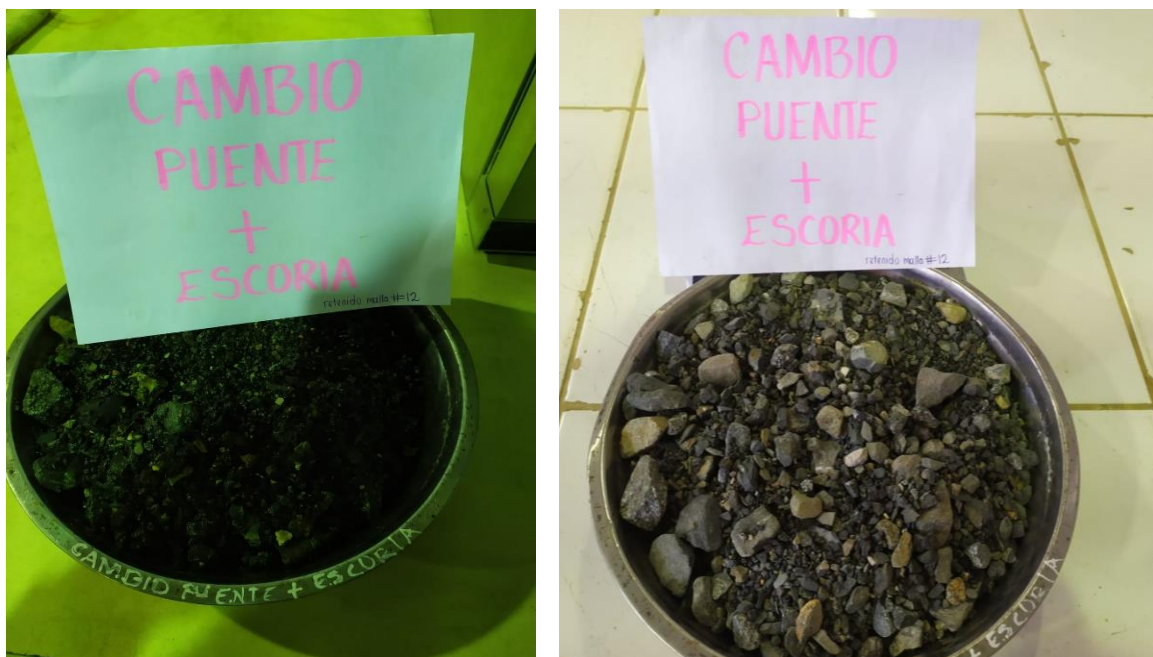
Fotografía N° 36.- Muestra de combinación de material granular de la Cantera Cambio Puente + EHAE, retenido en la malla N°12- Ensayo de Abrasión los Ángeles.
