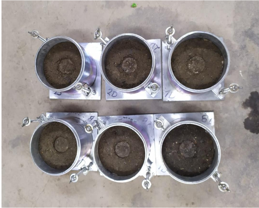
Fotografía N° 29.- Muestras ensayadas, en máquina CBR, de la combinación Material Granular + EHAE.
