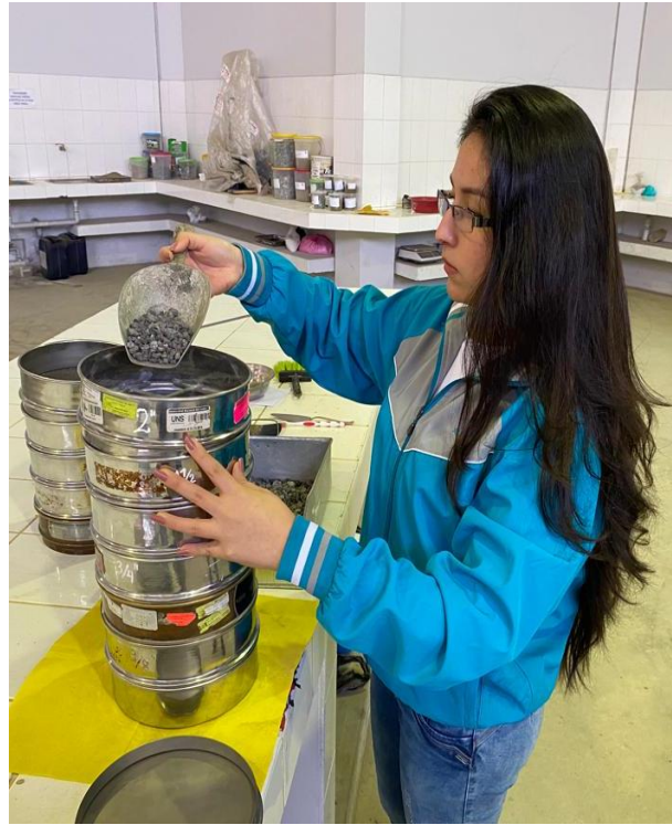
Fotografía N° 09.- Pesado y tamizado de la muestra de EHAE para la determinación de su granulometría.
