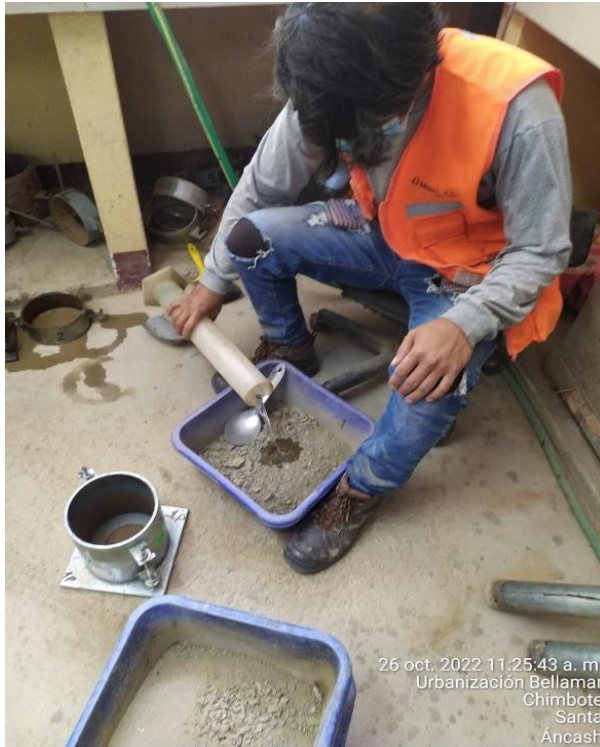
Fotografía N° 19.- Preparación y compactación de la muestra, empleando el Método C-Proctor Modificado.
