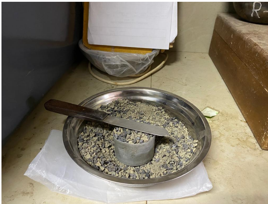
Fotografía N° 16.- Muestra pasante del tamiz N°4 - Material de Cantera+ EHAE.
