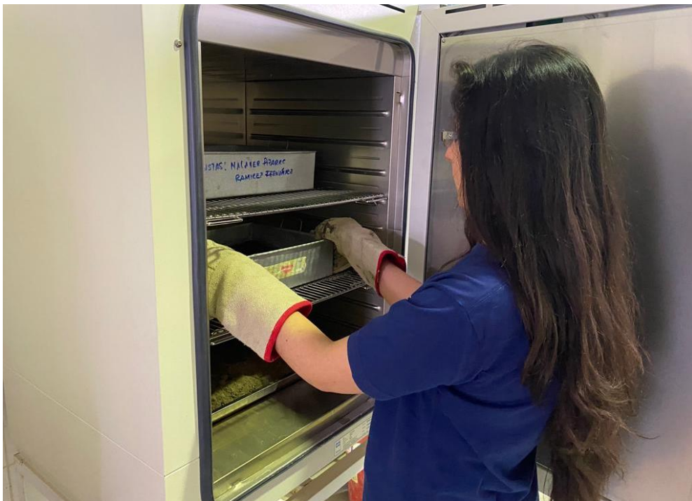
Fotografía N° 04.- Secado de la muestra en el horno por 24 horas a una temperatura de 110 \pm 5 °C.
