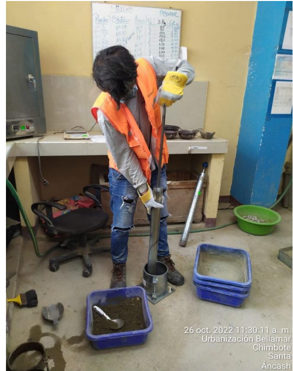
Fotografía N° 19.- Preparación y compactación de la muestra, empleando el Método C-Proctor Modificado.
