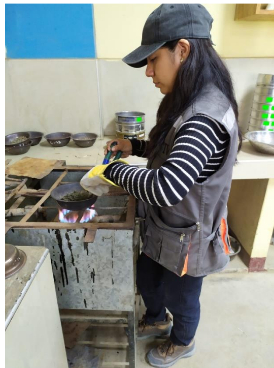
Fotografía N° 20.- Obtención de una porción representativa de material para determinar el contenido de humedad.
