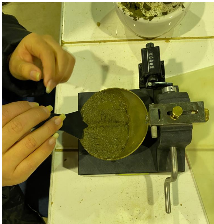
Fotografía N° 10.- Determinación del límite líquido del material de las canteras.
