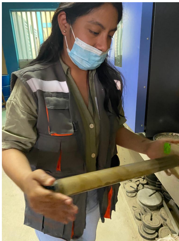
Fotografía N° 14.- Agitación de la probeta de 90 ciclos durante 30 segundos.
