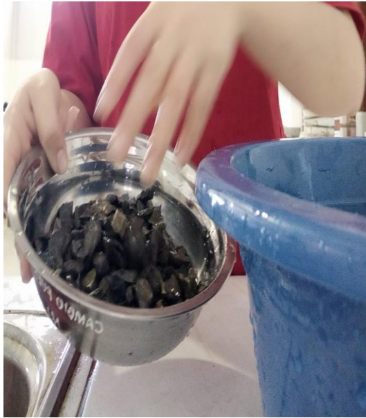
Fotografía N° 31.- Lavado y secado de la muestra, por fracciones separadas, del material granular de cantera.
