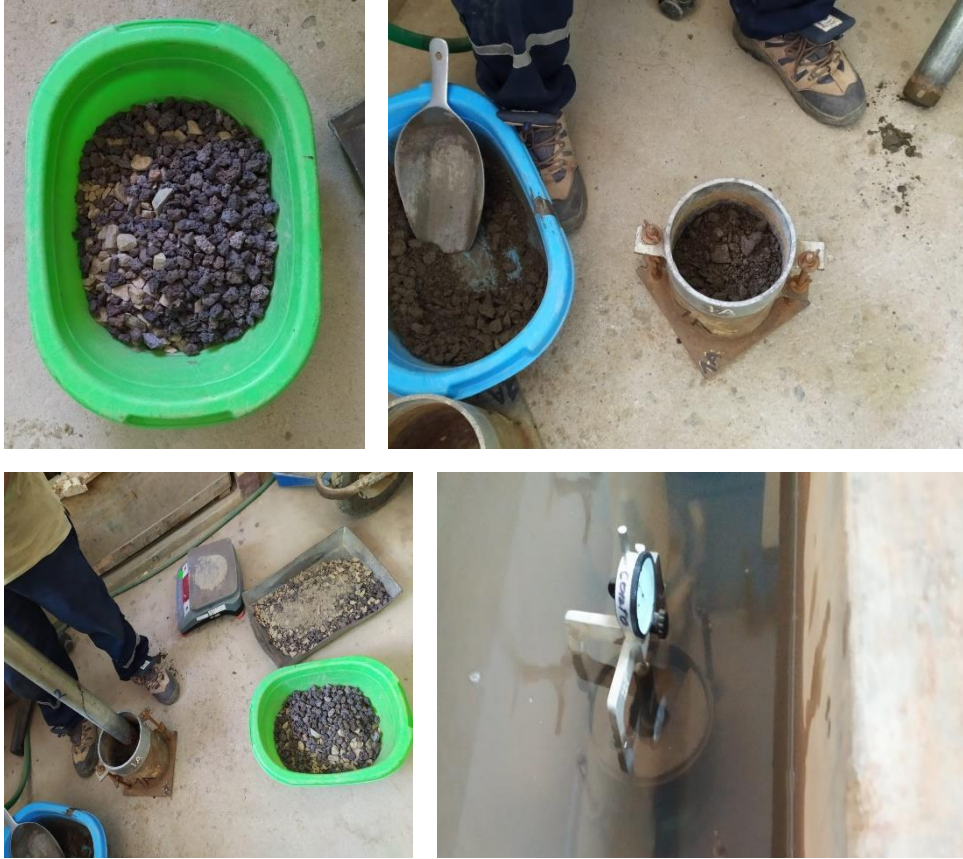
Fotografía N° 27.- Moldeo del Material Granular + EHAe para ensayo CBR.
