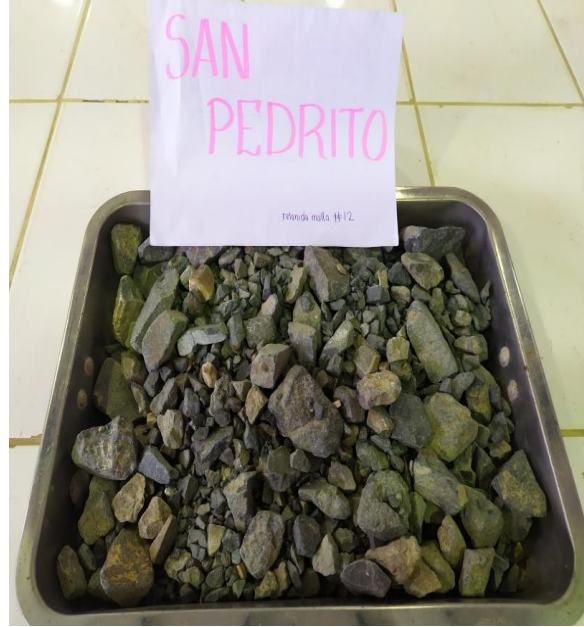
Fotografía N° 33.- Material retirado de la Máquina de los Ángeles para posteriormente realizar la separación de la muestra sobre el tamiz N°12.
