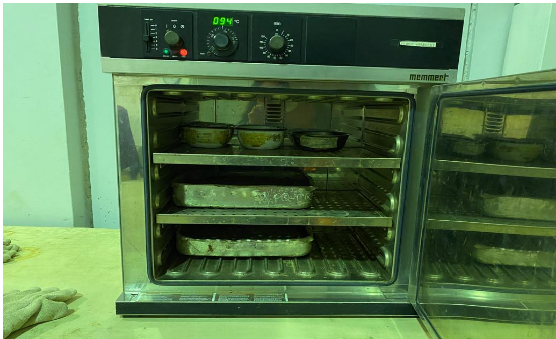
Fotografía N° 06.- Secado de la muestra, luego del lavado, a una temperatura de 110 \pm 5 °C.
