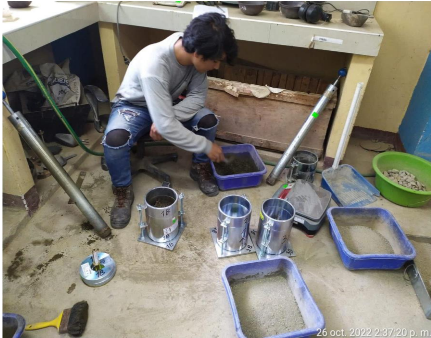
Fotografía N° 21.- Preparación de las muestras para el ensayo de CBR, añadiendo el óptimo contenido de humedad, determinado en el ensayo de Proctor Modificado.
