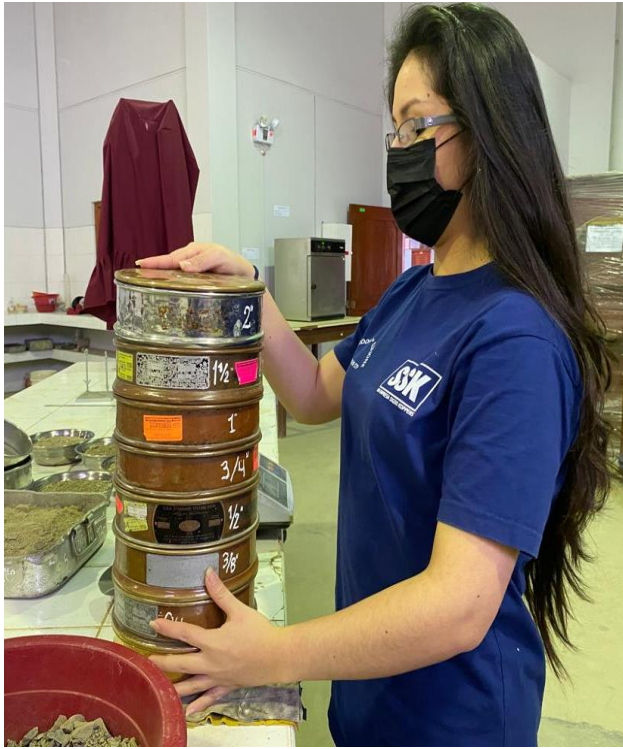
Fotografía N° 07.- Tamizado y pesaje de la muestra para la determinación de su granulometría.
