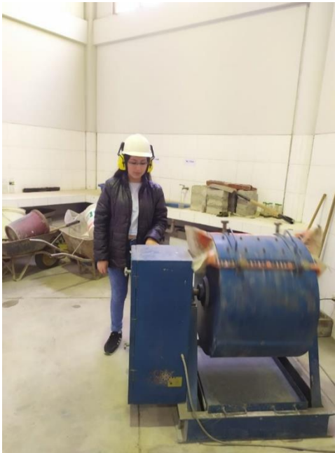
Fotografía N° 32.- Colocación de la muestra seca en la Máquina de los Ángeles para ser ensayada a 30 rpm por 500 revoluciones.
