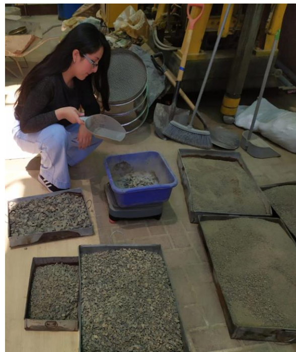
Fotografía N° 18.- Tamizado de la muestra del material de cantera para la realización del Proctor Modificado.
