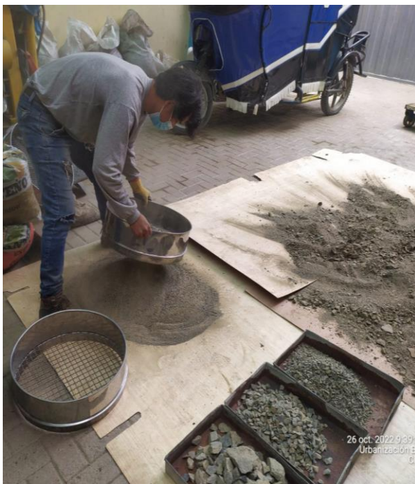
Fotografía N° 18.- Tamizado de la muestra del material de cantera para la realización del Proctor Modificado.
