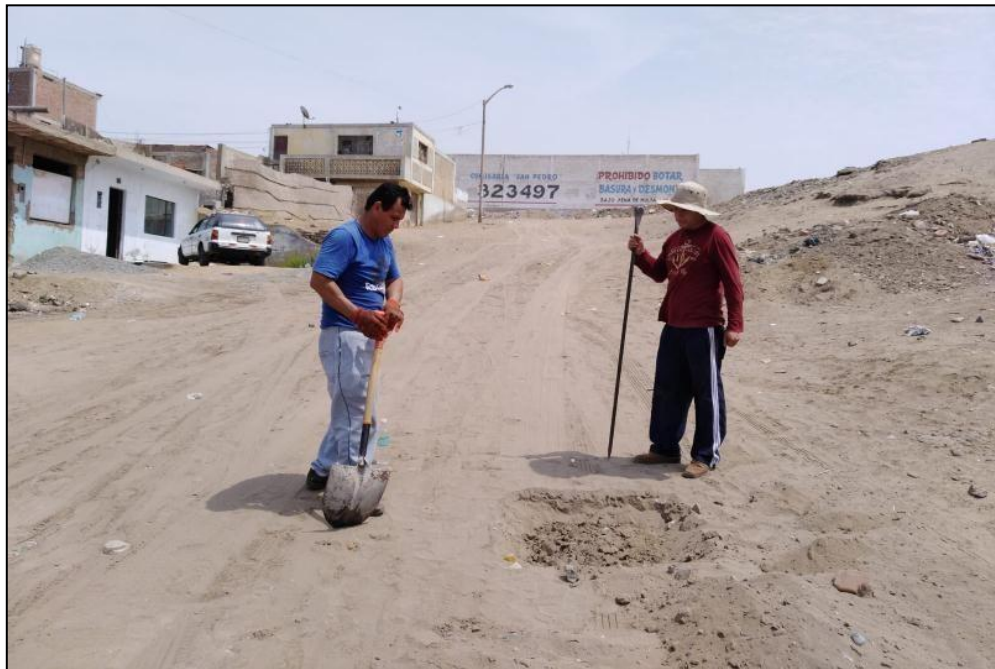
Fotografía 03. Empezando las calicatas para extraer el suelo a ensayar con ayuda de personal de apoyo
