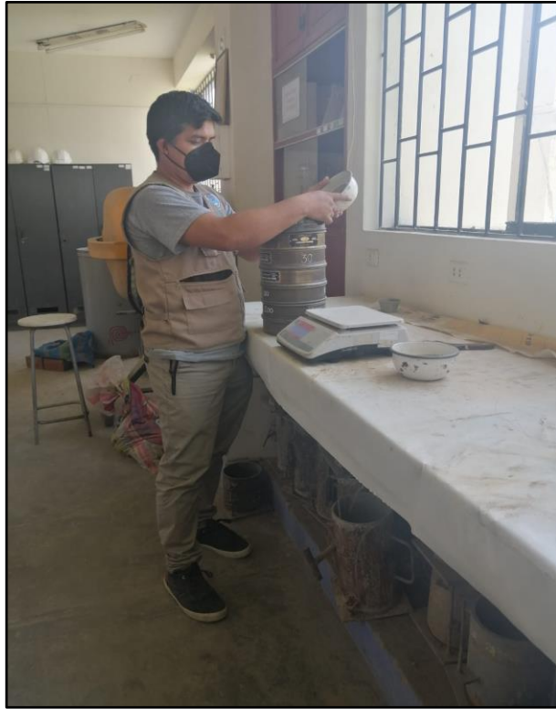
Fotografía 13: Realización de la granulometría de suelos en la Universidad San Pedro
