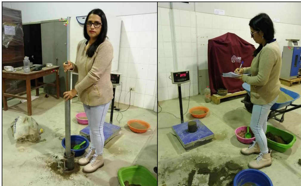
Fotografía 10. Elaboración del Proctor por parte de la tesista Bach. Jhadrit Janina Guevara Tuesta; lado izquierdo adición de energía de compactación a la muestra, lado derecho peso de la muestra para determinar la densidad.
