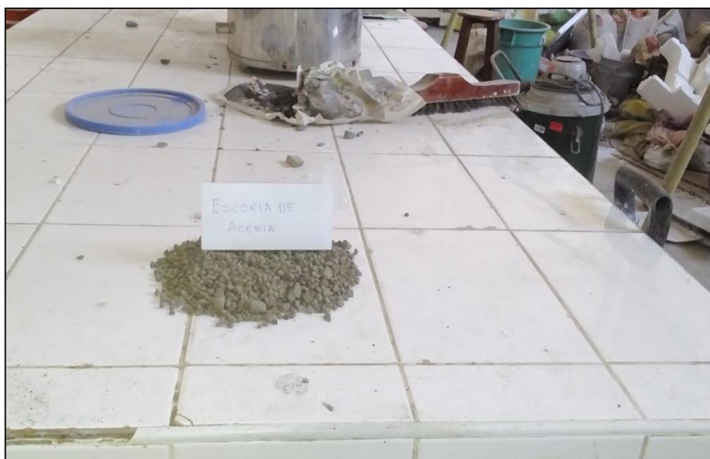
Fotografía 08. Muestra de la escoria del horno eléctrico de Sider Perú en laboratorio de Mecánica de suelos de la EPIC de la UNS lista para empezar a ensayarla.
