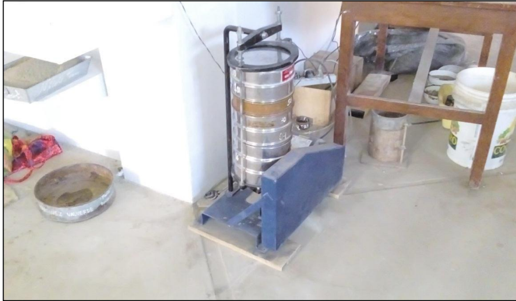
Fotografía 09. Realizando el tamizado de la muestra por vibración para determinar la granulometría y el tipo de suelo
