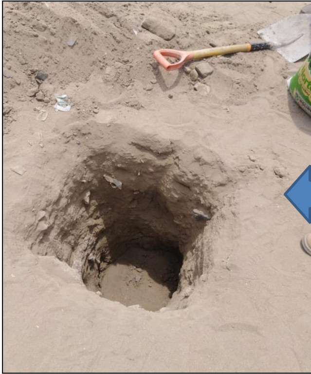
Fotografía 05. Calicata terminada lista para poder introducirse en él y examinar los diferentes estratos del suelo en su estado natural y extraer muestras
