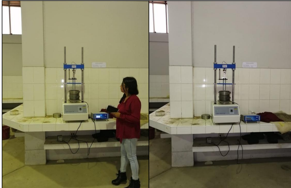
Fotografía 12. Realización del Ensayo de penetración en la Máquina Automática para Ensayos de CBR para medir la carga necesaria para alcanzar determinadas profundidades de penetración.
