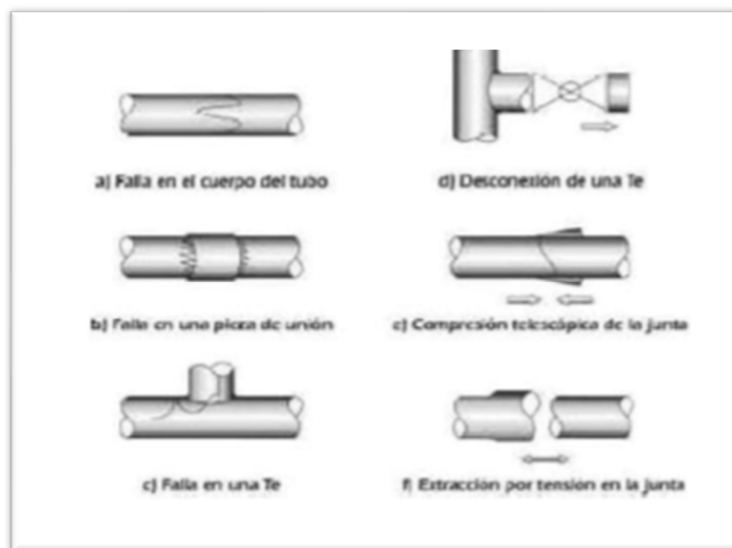
Figura 14: Falla más comunes en tuberías de PVC.
