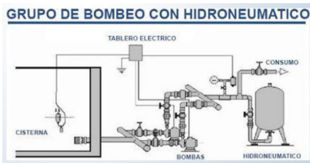
Figura 6: Sistema de Alimentación Indirecta con Hidroneumático.
