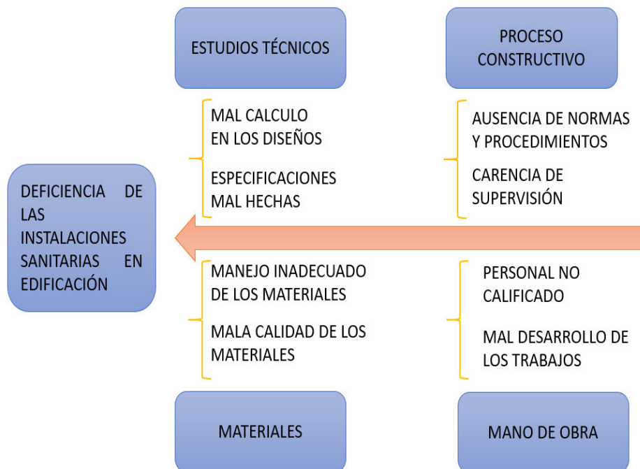
Figura 1: Deficiencia de las Instalaciones Sanitarias.
