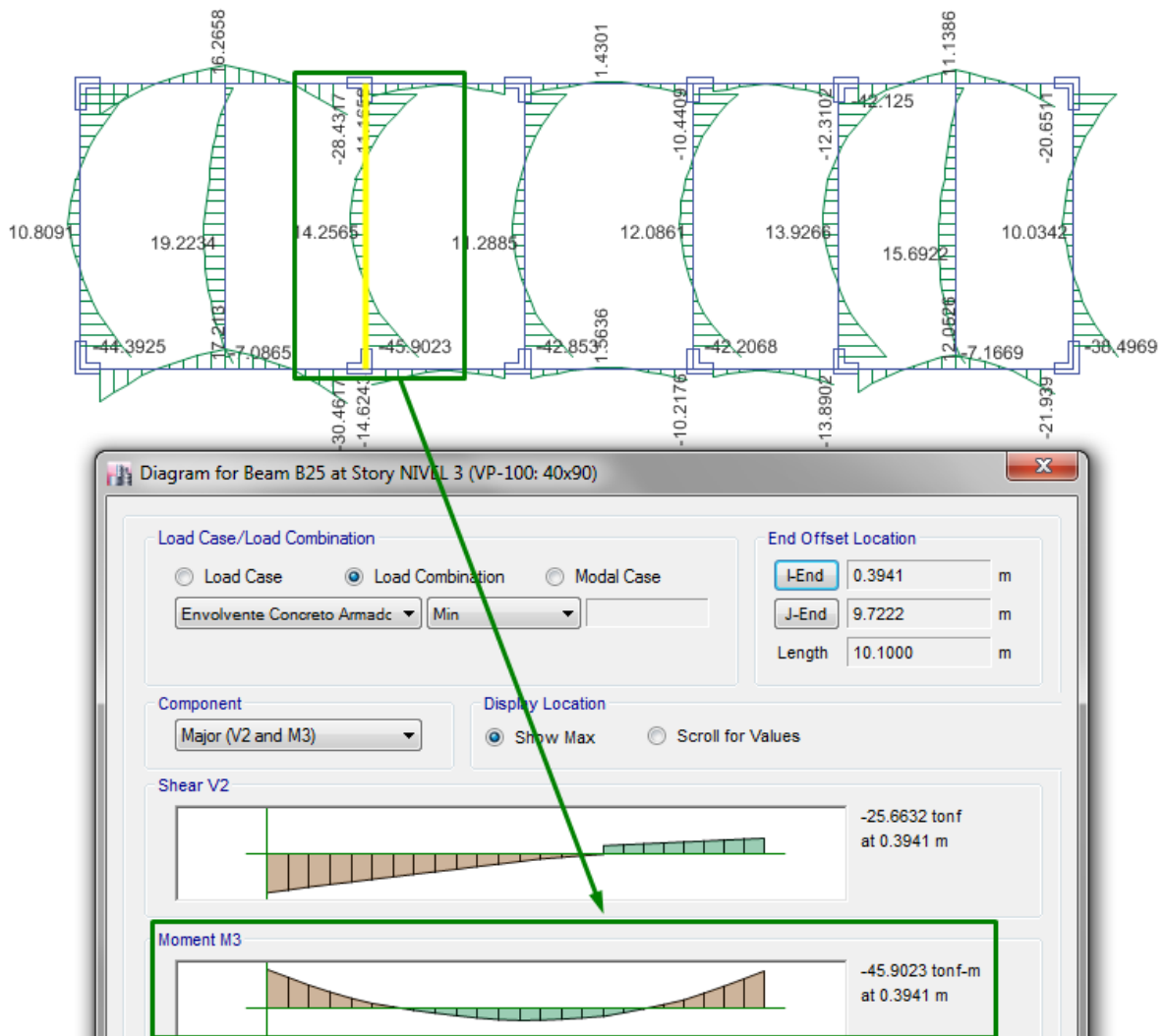
Figura 67: Análisis de VP-300 (40 x 90) por ETABS-Acero Negativo - Sistema estructural tradicional.
