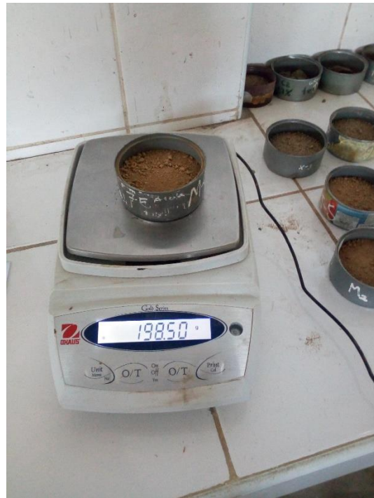
Pesaje de las muestras secas para contenido de humedad
