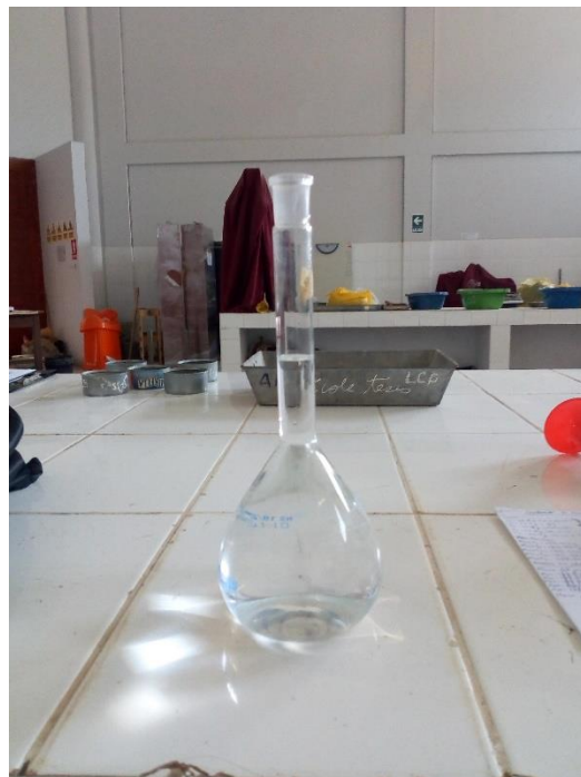
Picnómetro de 500 ml + agua destilada
