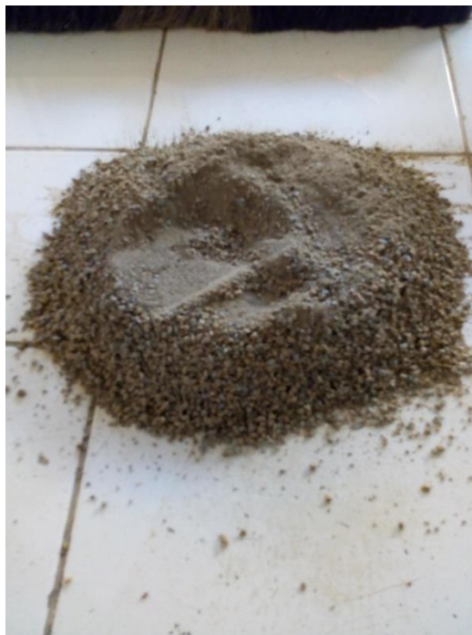
Cuarteo de la muestra del suelo
