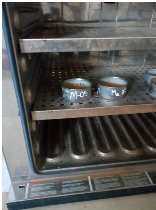
Secado de las muestras del suelo
