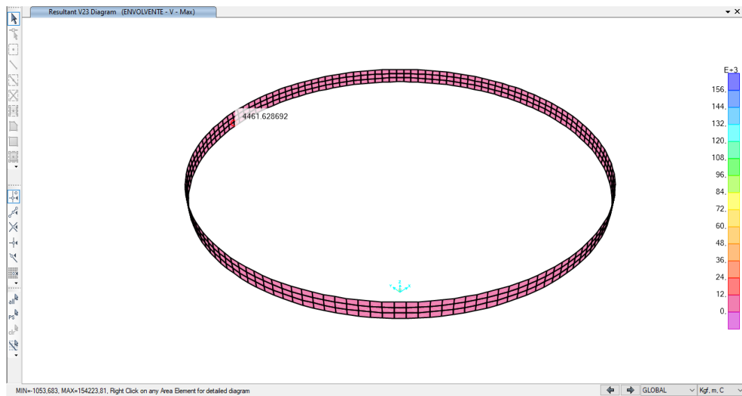
Figura 3.54 Cortante máximo V_{23} en viga anular
