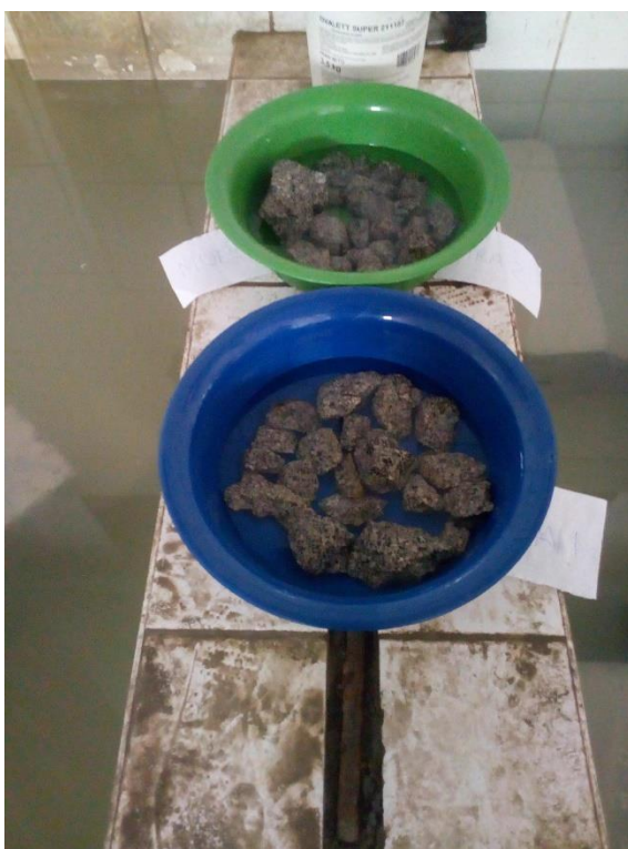
Absorción del agua destilada durante 48 horas
