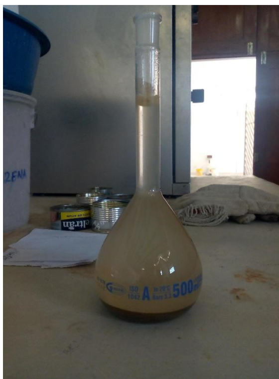
Picnómetro + agua + muestra de suelo
