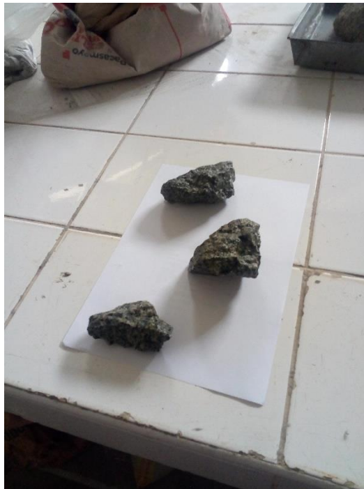
Muestras secas de la granodiorita para posterior pesaje
