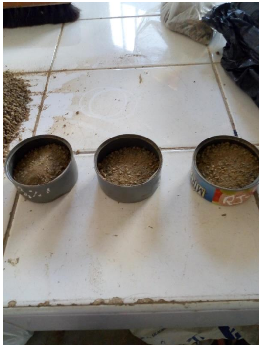
Muestras del suelo para contenido de humedad
