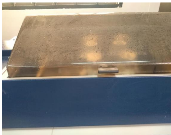
Figura 130: Incubación a baño maría de las muestras a 60°C por 30 min junto con el alcohol de 96° (usado para FDT).
