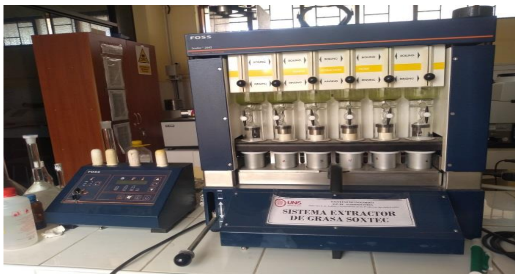
Figura 110: Equipo Soxhlet donde se llevó a cabo la extracción del aceite de cada muestra utilizando como solvente éter de petróleo.
