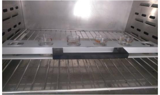
Figura 135: Los crisoles conteniendo los residuos son secados en estufa a 105°C por 12 h.
