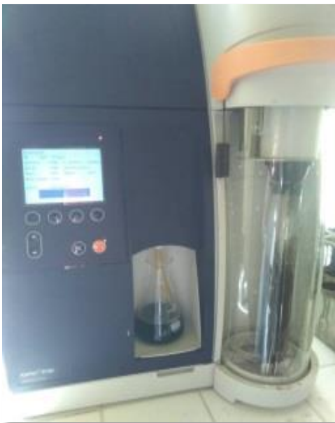
Figura 107: Destilación con NaOH al 40%, agua destilada y vapor.
