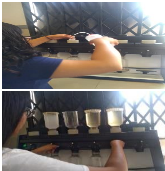
Figura 132: Humedecer el célite con alcohol de 78° para FDT y con agua destilada para FDI previo al montaje de crisol con célite y frascos de reacción para el proceso de filtración.
