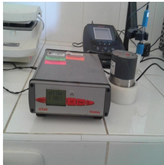
Figura 164: Espera hasta estabilidad térmica para la obtención de la actividad de agua ( A_w .)
