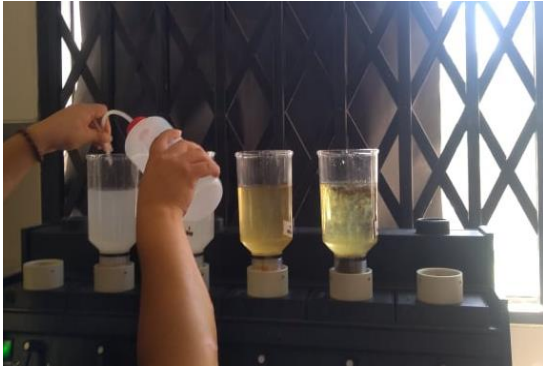
Figura 134: Para el proceso de filtración es necesario la aplicación de presión y succión.
