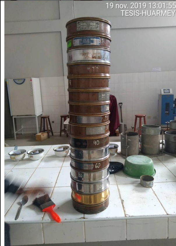
Fotografía N° 25, 26, 27 y 28 : Obtención de curva Granulométrica de los estratos, a través del tamizaje manual con cada uno de los tamices descritos en el Manual de Ensayos de Materiales.
