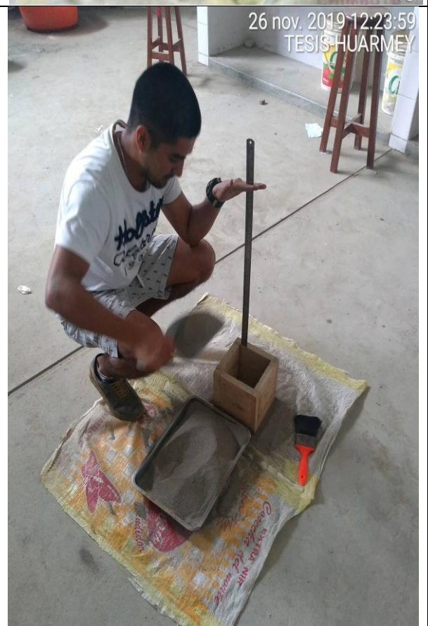
Fotografía N° 37, 38, 39 y 40 : Se realizó el ensayo de las densidades Máxima con las muestras secas, se utilizó un molde de madera, regla, varilla, cucharón y balanza.
