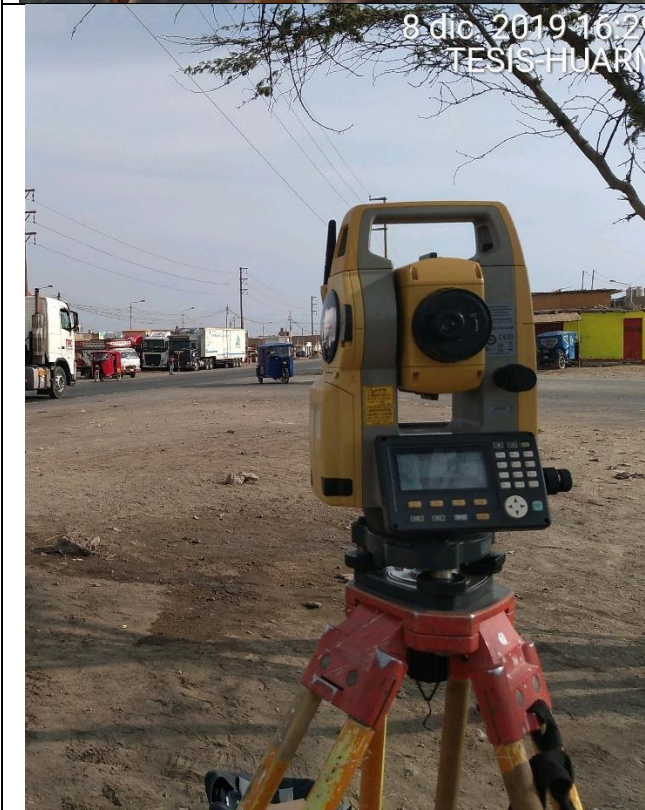
Fotografía N°57, 58, 59 y 60 : Una vez puestas las coordenadas y altura establecida, se prosigue con el levantamiento topográfico del área en intervención para el cruce peatonal entre el A:H. La Victoria y la Ciudad de Huarmey.
