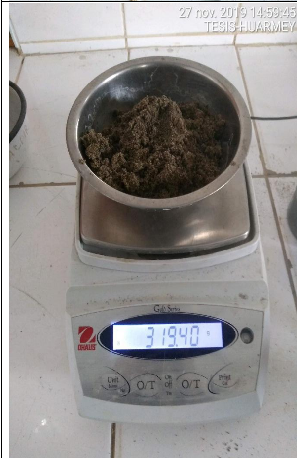
Fotografía N° 49, 50, 51 y 52 : Una vez finalizado el ensayo, se toma una porción de la muestra de la caja de corte, para posteriormente determinar su humedad
