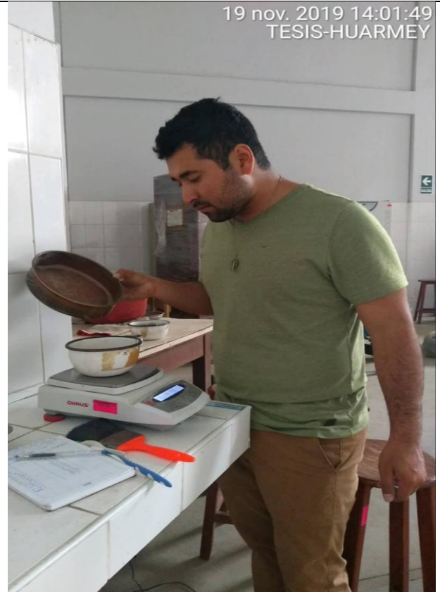
Fotografía N° 25, 26, 27 y 28 : Obtención de curva Granulométrica de los estratos, a través del tamizaje manual con cada uno de los tamices descritos en el Manual de Ensayos de Materiales.
