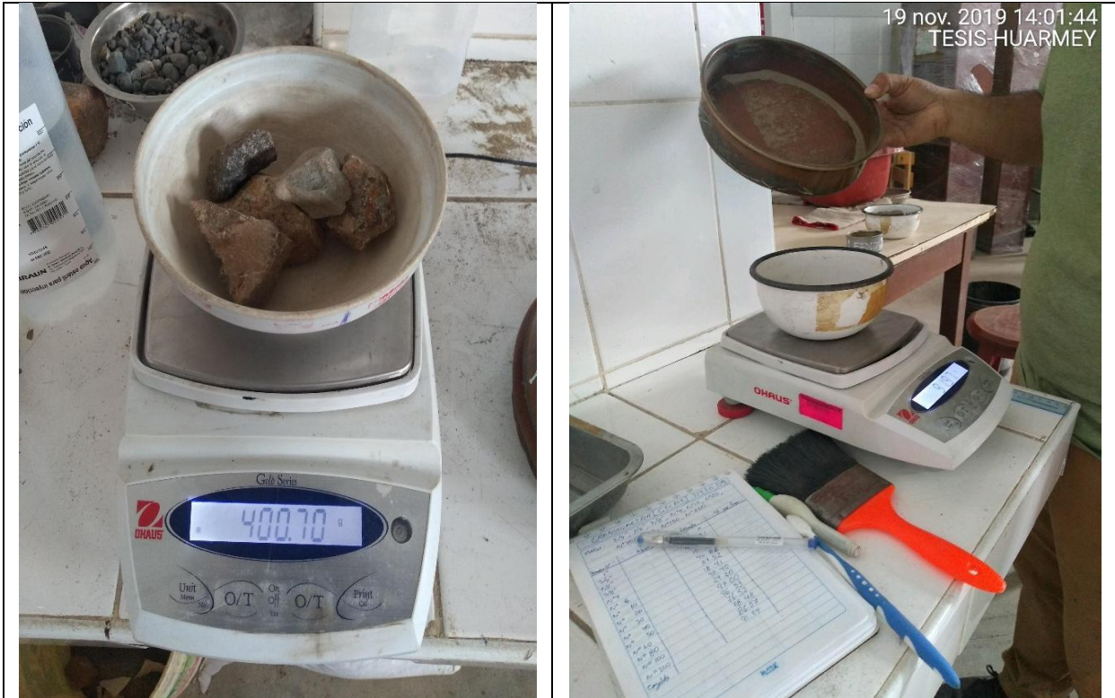
Fotografía N° 29 y 30 : Pesaje de las muestras en los tamices independiente uno del otro, después de ser removidos manualmente de manera conjunta y por separado.
