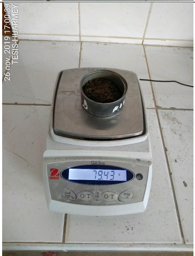
Fotografía N° 21, 22, 23 y 24 : Peso de taras con las muestras representativas en balanza electrónica, antes y después del secado en el horno eléctrico, para determinar el Contenido de Humedad de cada estrato.
