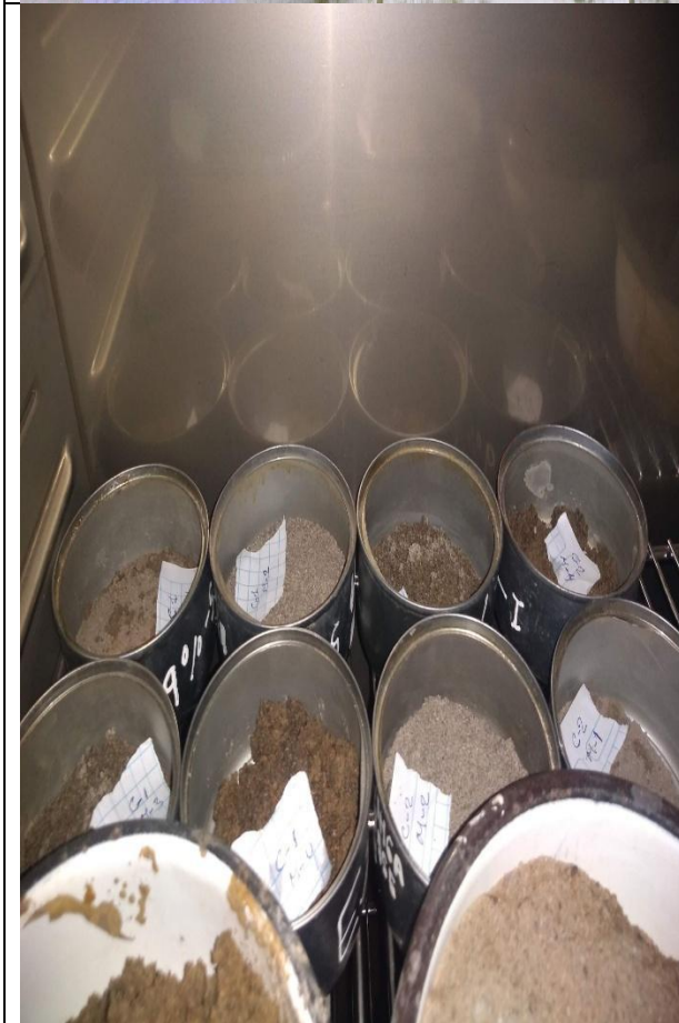
Fotografía N° 33, 34, 35 y 36 : De igual manera para la determinación de Densidades máximas y mínimas, se secan las muestras representativas en el Horno Eléctrico.
