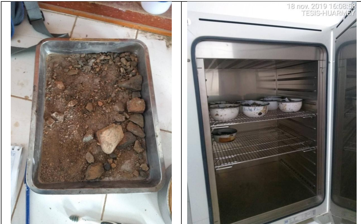
Fotografía N° 31 y 32 : Para la obtención del contenido de Humedad, se calientan las muestras representativas en el Horno Eléctrico, para posteriormente sacar su diferencia de pesos.
