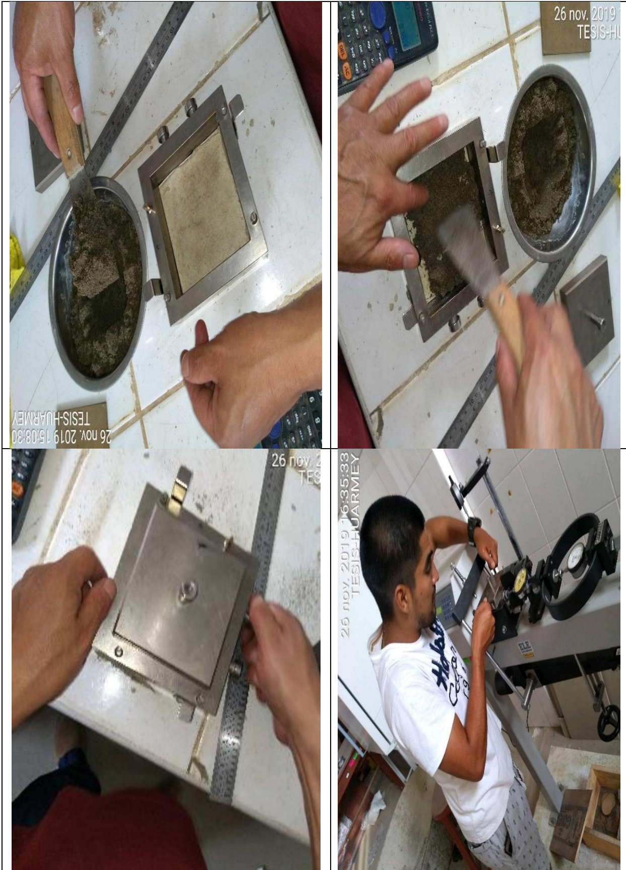
Fotografía N° 41, 42, 43 y 44 : Se preparó y colocó el espécimen de los estratos N°03 de cada calicata; que se emplearán en el posterior ensayo de Corte Directo
