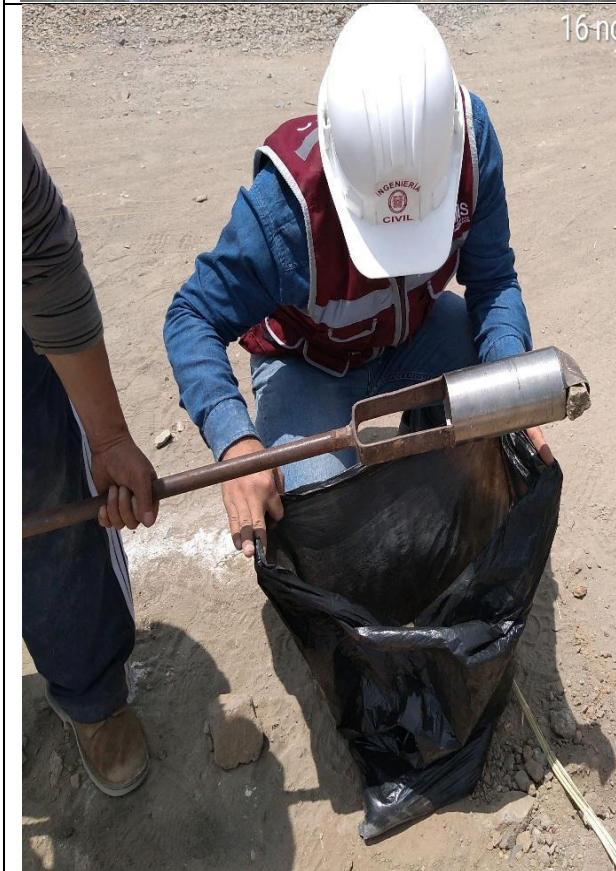
Fotografía N° 09, 10, 11 y 12 : Recojo de muestras del suelo con muestreador manual, Barrena y Palana; de calcatas en ambos lados de la Carretera Panamericana.
