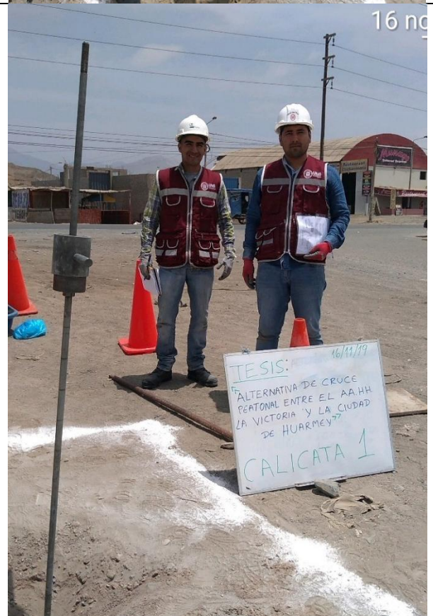
Fotografía N° 13, 14, 15 y 16 : Ensayo de Penetración Dinámica Ligera (DPL), en ambos lados de la Carretera Panamericana.
