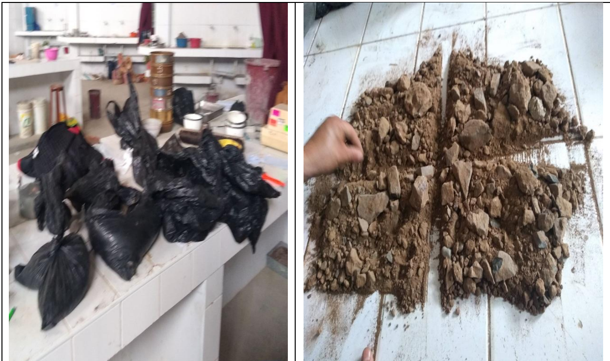
Fotografía N° 19 y 20 : Selección de muestras representativas de cada estrato extraído de las calicatas, con el Método del Cuarteo, en el laboratorio de la UNS.
