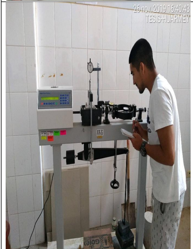
Fotografía N o 45, 46, 47 y 48 : Se procedió con el ensayo de Corte Directo en su respectivo Equipo, registrándose lecturas normales, siendo graficadas estas lecturas Vs el tiempo.
