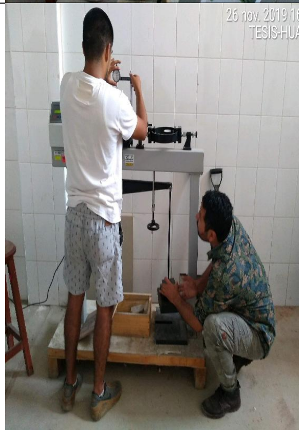
Fotografía N o 45, 46, 47 y 48 : Se procedió con el ensayo de Corte Directo en su respectivo Equipo, registrándose lecturas normales, siendo graficadas estas lecturas Vs el tiempo.
