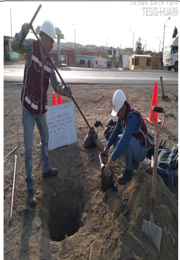
Fotografía N° 09, 10, 11 y 12 : Recojo de muestras del suelo con muestreador manual, Barrena y Palana; de calcatas en ambos lados de la Carretera Panamericana.
