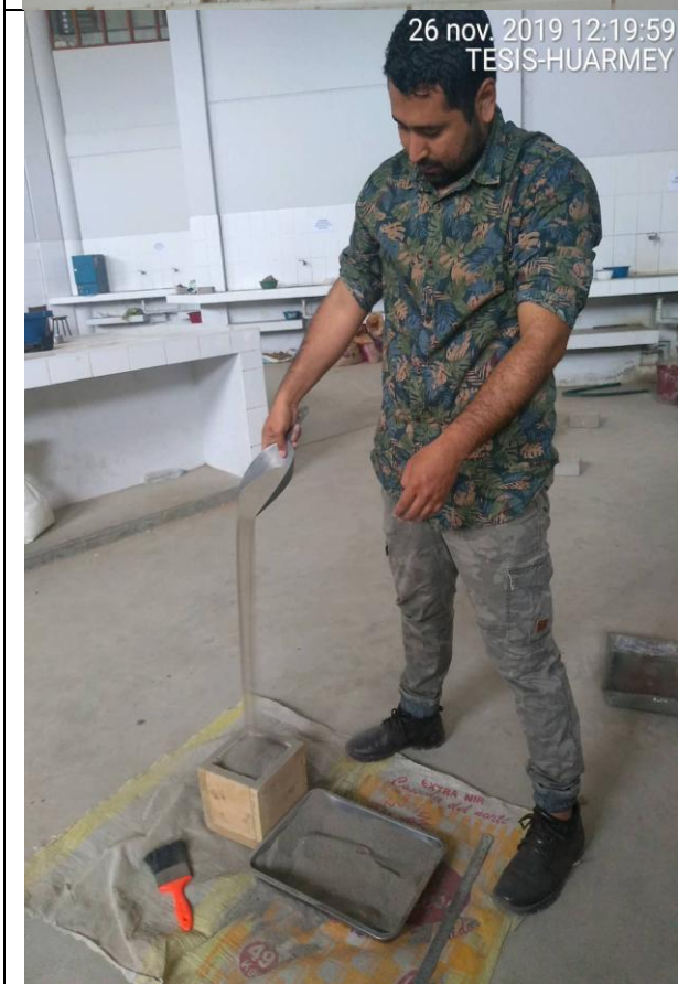
Fotografía N° 37, 38, 39 y 40 : Se realizó el ensayo de las densidades Máxima con las muestras secas, se utilizó un molde de madera, regla, varilla, cucharón y balanza.
