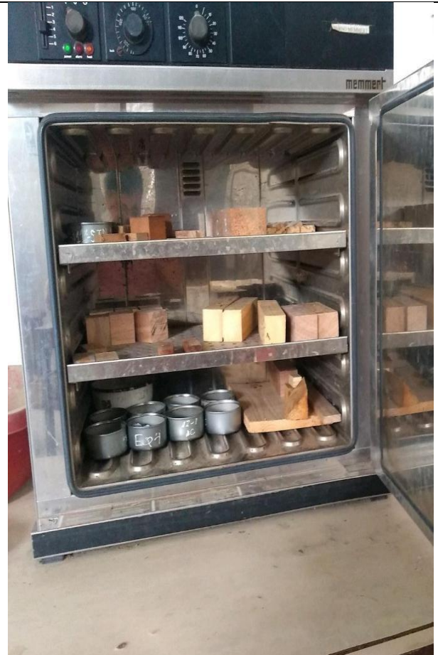
Fotografía N° 33, 34, 35 y 36 : De igual manera para la determinación de Densidades máximas y mínimas, se secan las muestras representativas en el Horno Eléctrico.
