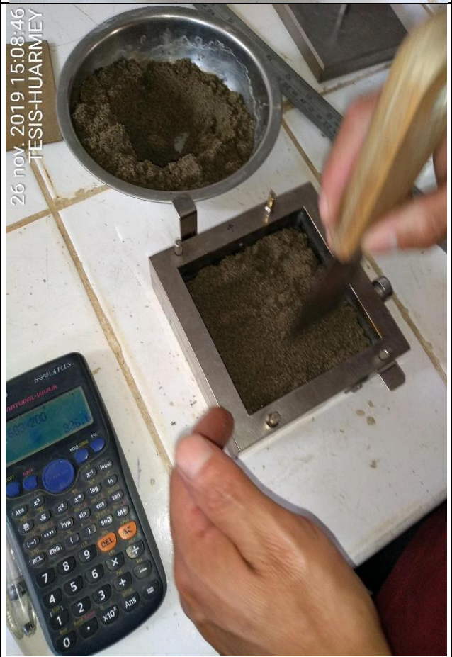
Fotografía N° 49, 50, 51 y 52 : Una vez finalizado el ensayo, se toma una porción de la muestra de la caja de corte, para posteriormente determinar su humedad
