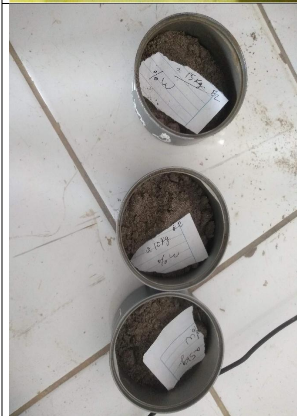
Fotografía N° 21, 22, 23 y 24 : Peso de taras con las muestras representativas en balanza electrónica, antes y después del secado en el horno eléctrico, para determinar el Contenido de Humedad de cada estrato.
