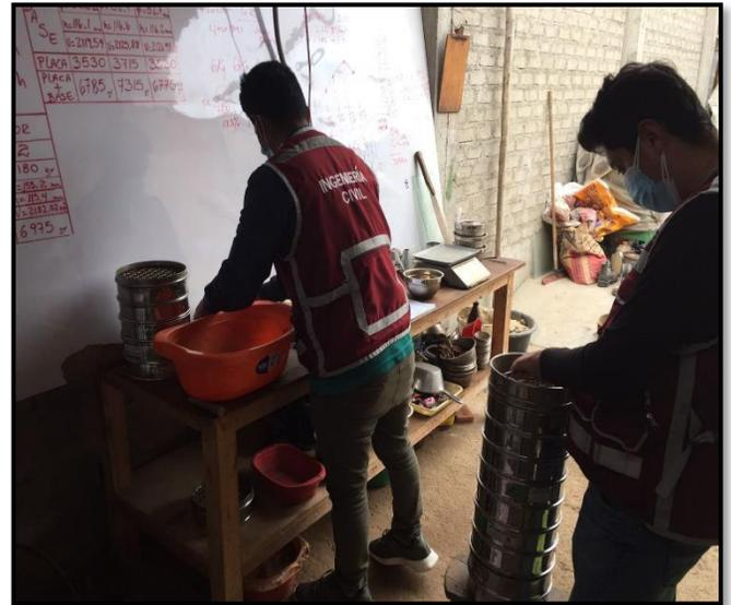
FIGURA N°76 Y FIGURA N° 77 ANÁLISIS GRANULOMÉTRICO
