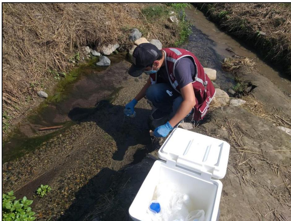
**Figura N° 38** Toma de muestra de Coliformes fecales totales en el dren
