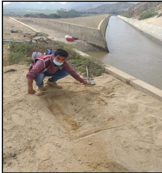
**FIGURA N° 52** DIMENSIONANDO LAS MEDIDAS DE LA CALICATA
