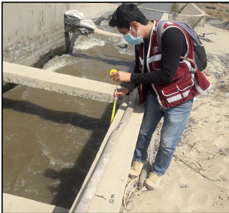
**Figura N° 19** Medición de las secciones transversales del canal madre.
