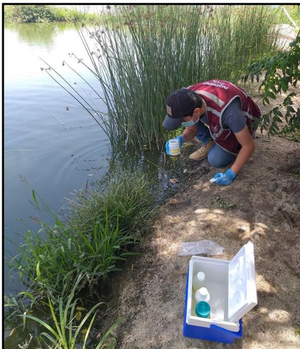
**Figura N° 49** Muestra de Ph y conductividad en el pozo
