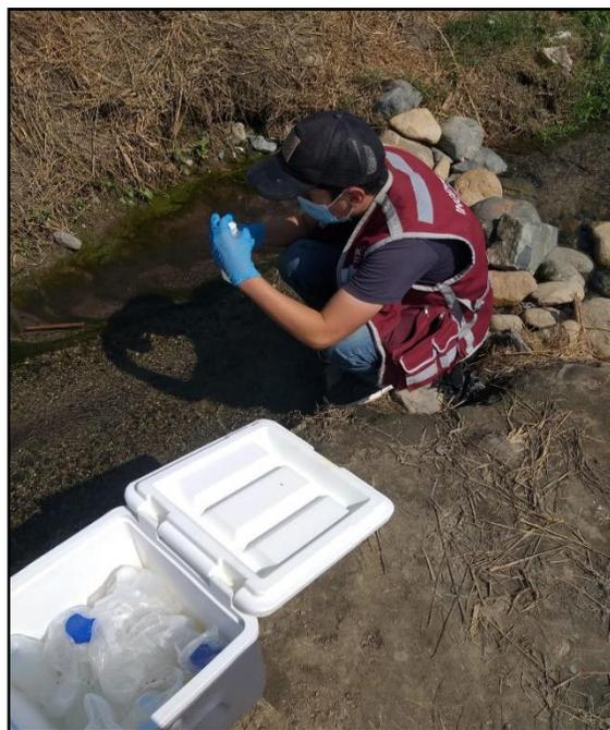
**Figura N° 42** Toma de muestra de Ph y conductividad en el dren
