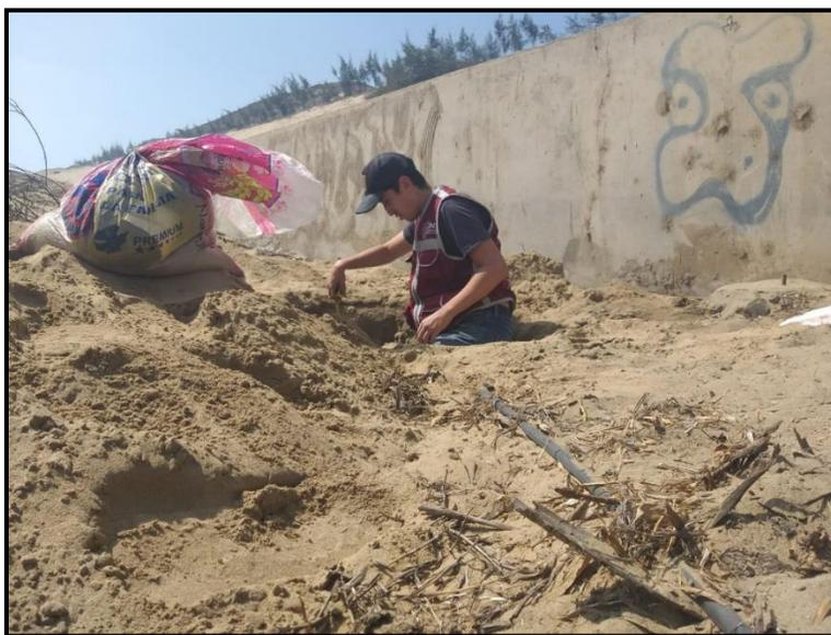
**FIGURA N° 56** CULMINACIÓN DE ESCAVACIÓN DE LA CALICATA N° 01 SE ENCONTRARON 3 TIPOS DE ESTRATOS.
