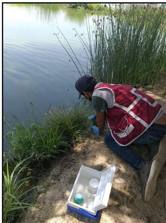
**Figura N° 50** Muestra de Turbidez en el dren
