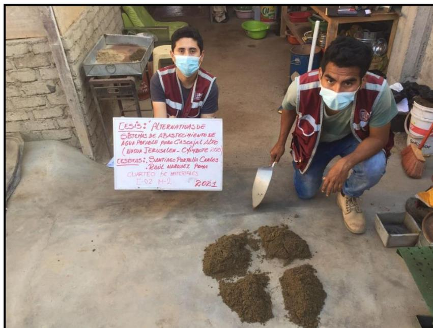
FIGURA N° 72 CUARTEO DEL MATERIAL CALICATA N° 2 MUESTRA – 02
