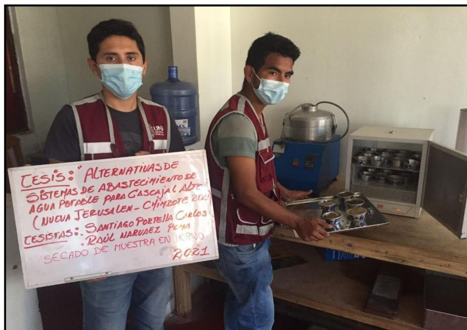
FIGURA N° 67 COLOCAR LAS MUESTRAS EN EL HORNO
