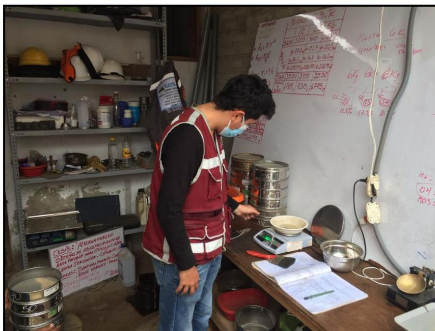
FIGURA N° 75 ANTES DE UTILIZAR LOS TAMICES DE DIFERENTES TAMAÑOS, PESAR LA MUESTRA.
