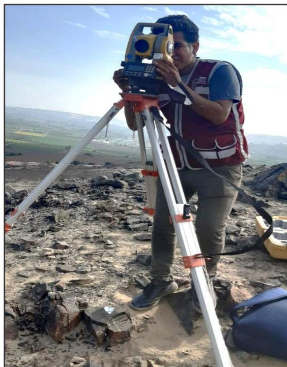
**Figura N° 26** Levantamiento topográfico con estación total.
