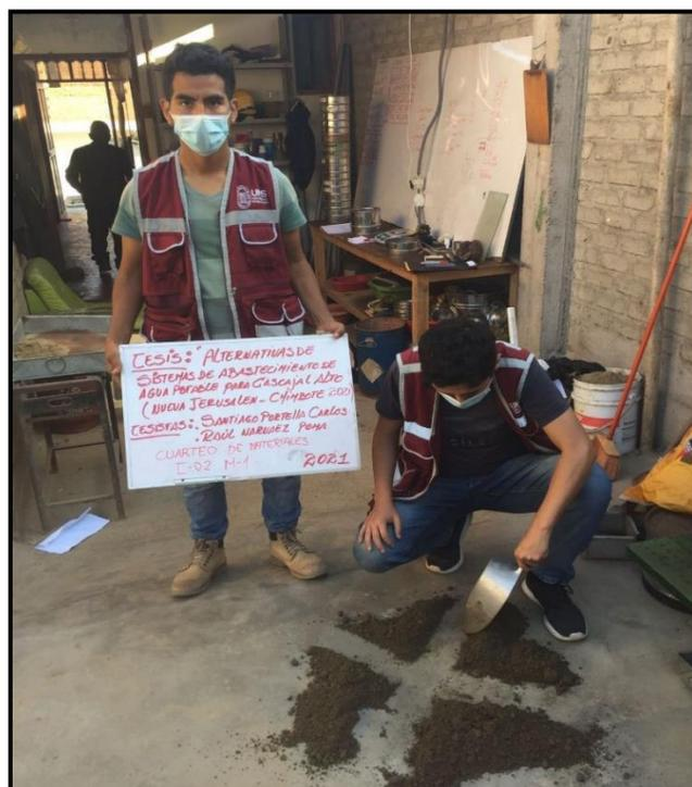
FIGURA N° 71 CUARTEO DEL MATERIAL
