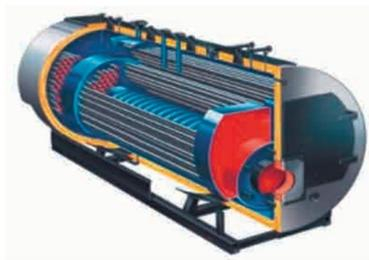
*Nota.* La figura muestra la disposición horizontal de los tubos de gases de la caldera pirotubular. Tomado de *(Uceda Martínez, J., 2013)*
