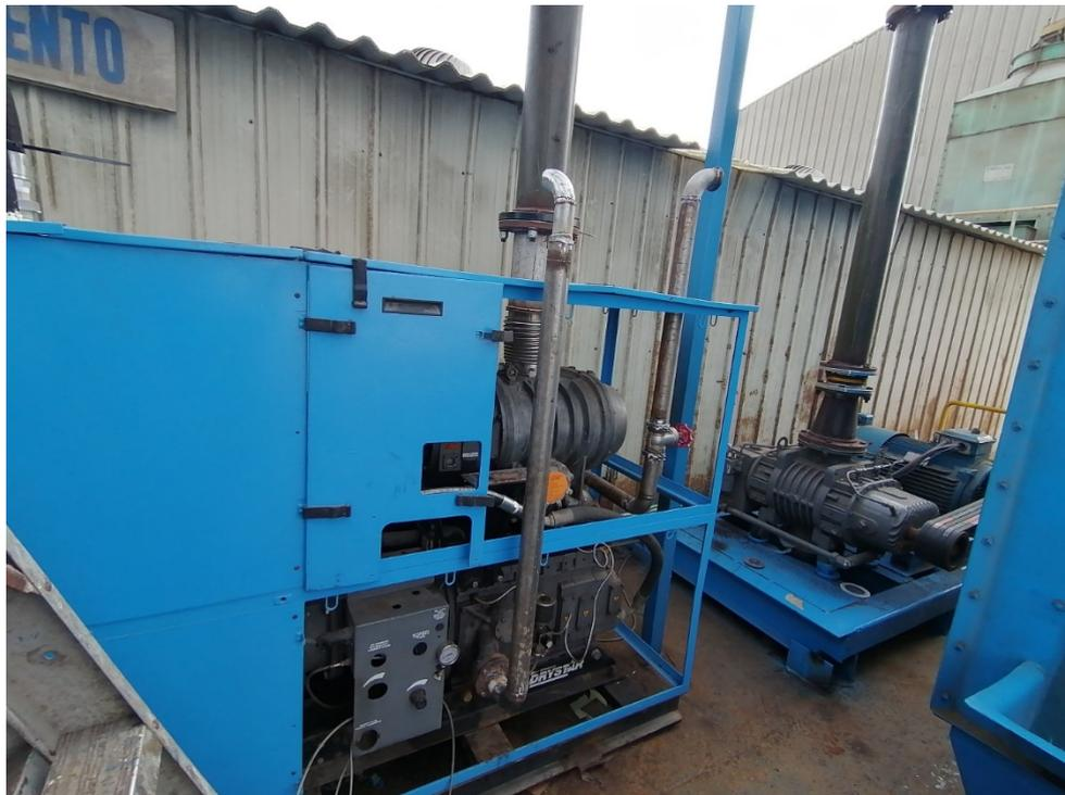
Bombas de vacío de secador de paletas (Pre – secado)
