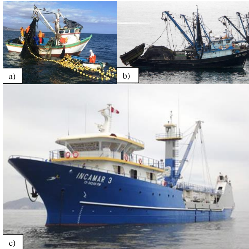
Figura 2. Tipos de embarcaciones empleados en la pesquería de anchoveta: a) Artesanal, b) Menor escala y c) Industrial.
