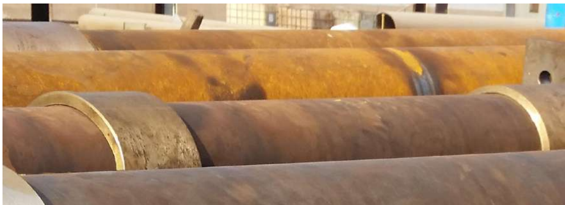
Figura 87. Eje barón con bocinas embonadas.
