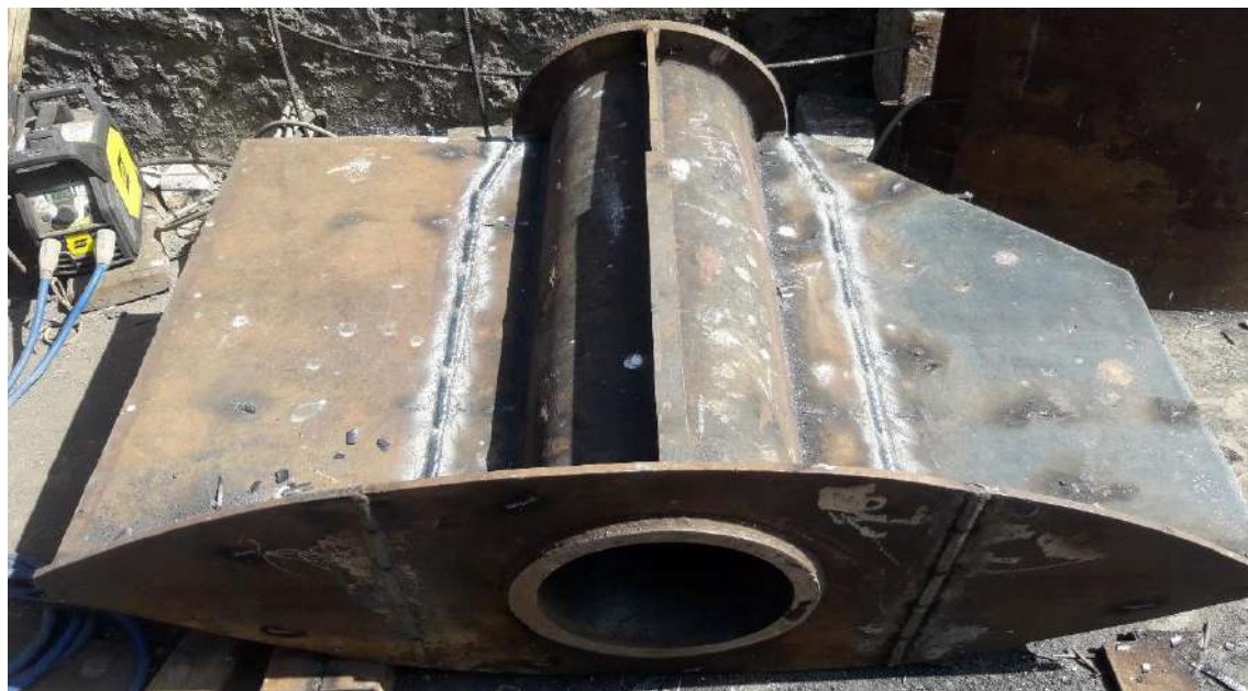
Figura 91. Estructura de tubo limera. Fuente: Elaboración propia.
