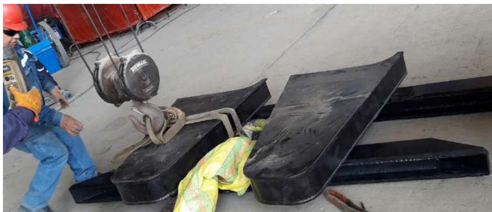
Figura 100. Zapatas laterales y refuerzos de quilla transportadas a astillero. Fuente: Elaboración propia.
