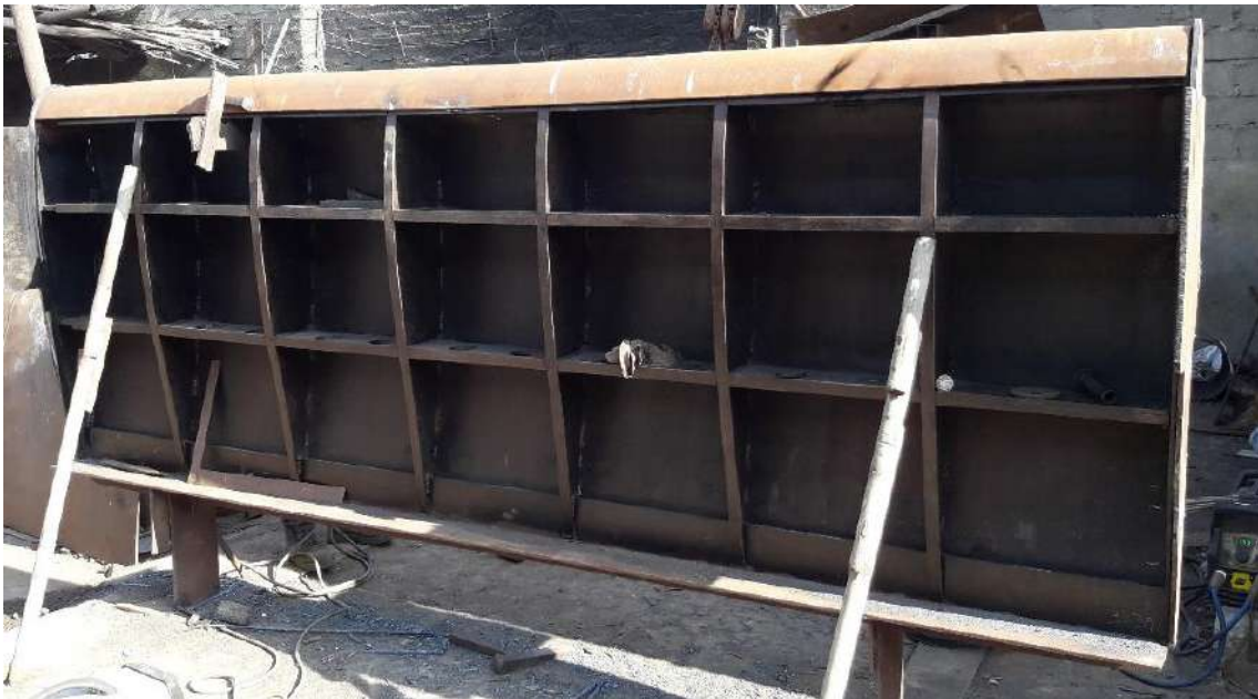
Figura 85. Estructura interna de pala de gobierno. Fuente: Elaboración propia.
