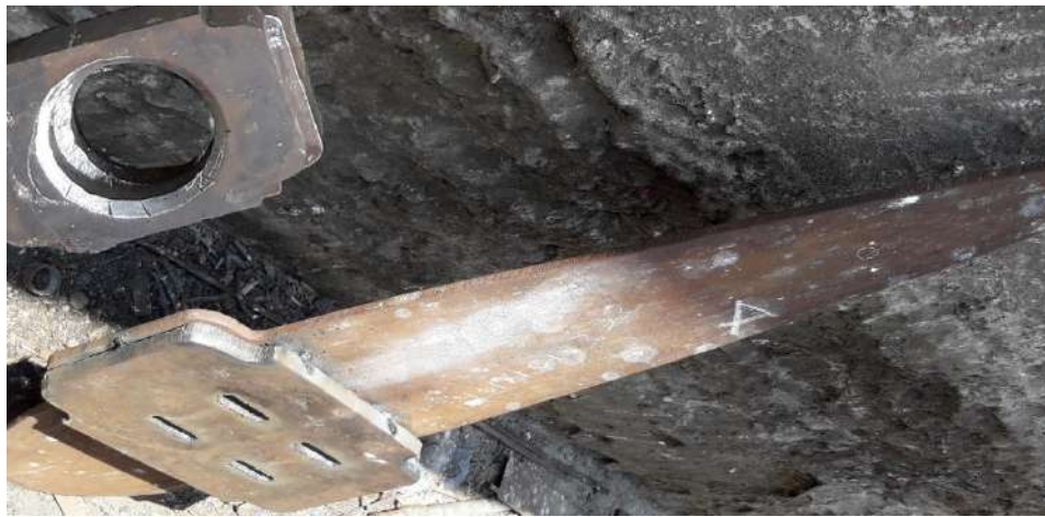
Figura 93. Bidas de pala de gobierno y eje barón. Fuente: Elaboración propia.
