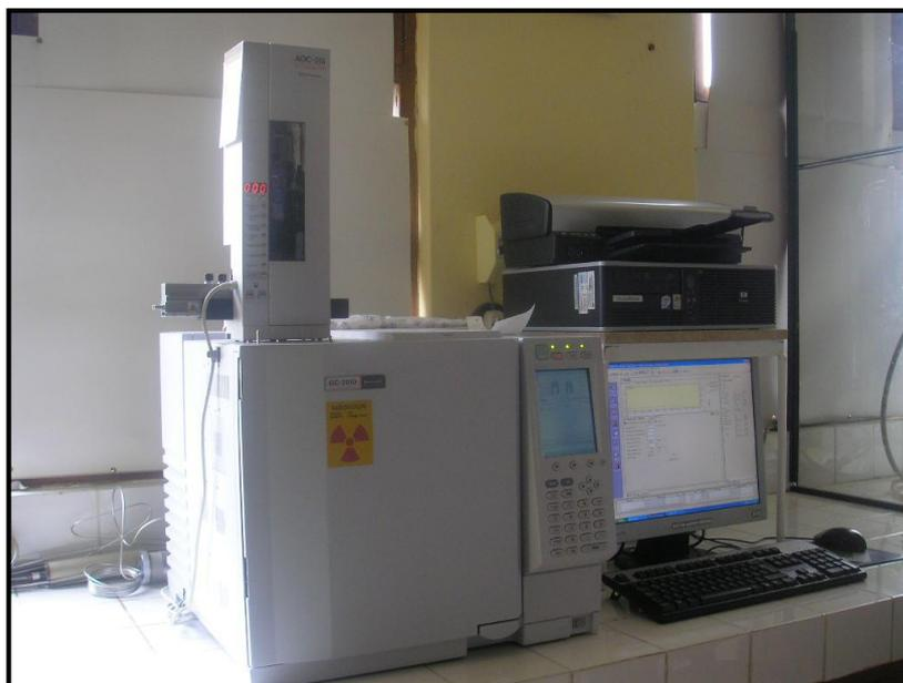
**Figura 08.** Cromatógrafo de Gas Shimadzu modelo 2010
