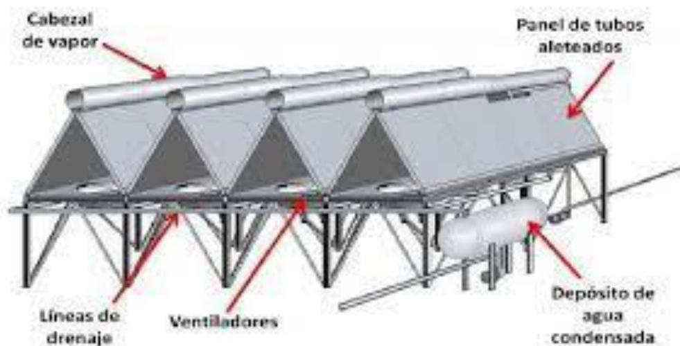
Figura 07 Esquema de componentes de un aerocondensador
