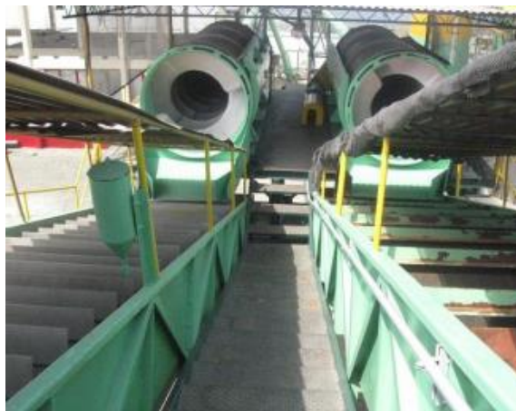
Figura 7: Trommel con malla rotatoria de 1mm
