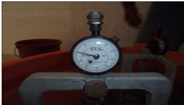
Figura 47. Equipo CBR Dial. Fuente: Laboratorio Mecánica de suelos Universidad Nacional del Santa
