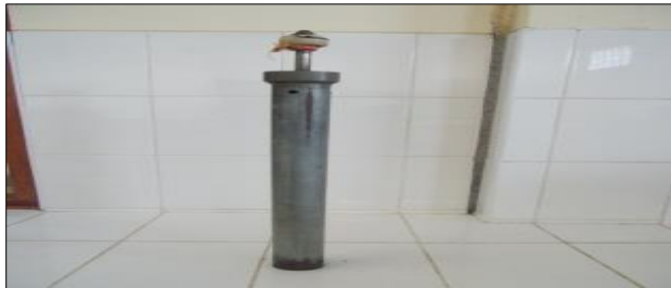
Figura 41. Equipo CBR Martillo de compactación.
