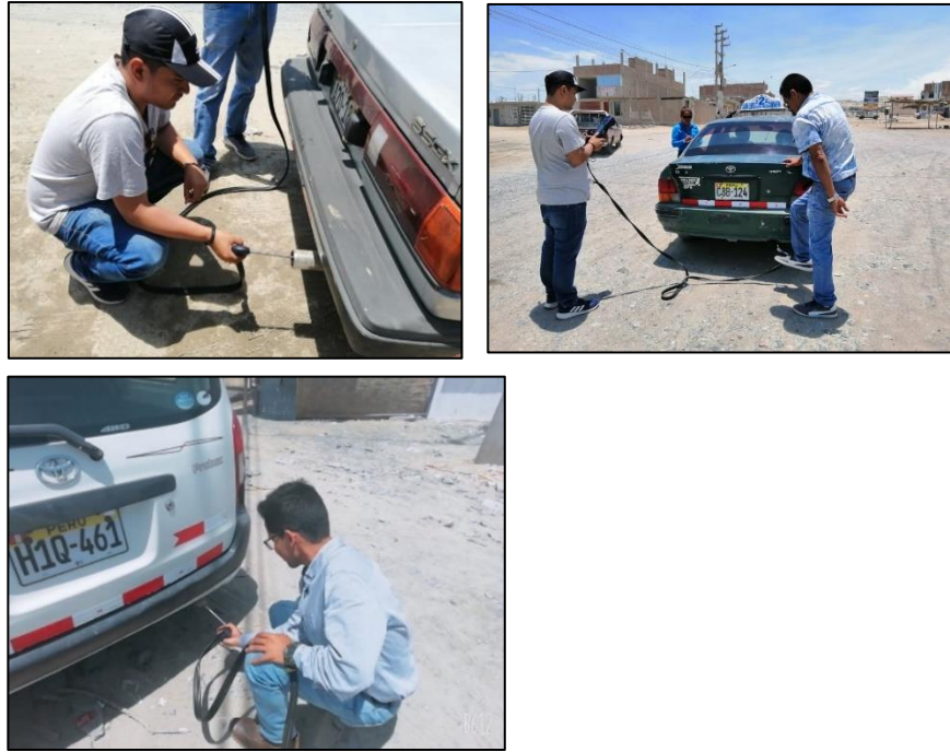
Figura 26. Evidencia de toma de mediciones con el Analizador de gases de Combustión E1500.
