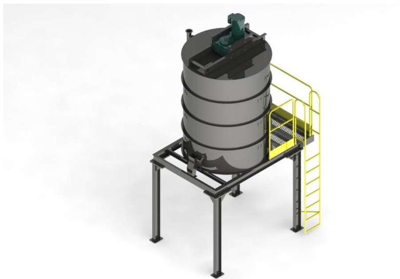
*Figura 2.1. Cocedor vertical de vapor
