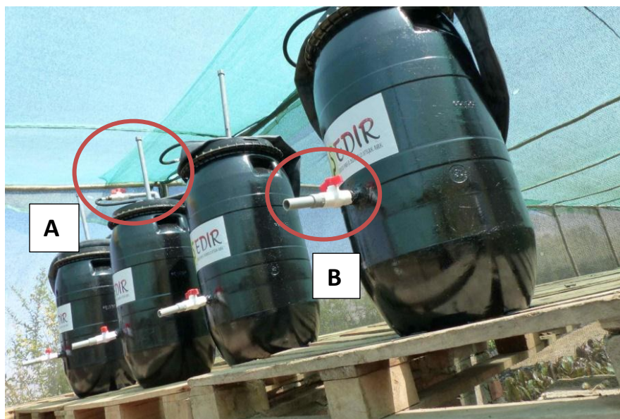
Figura 4. Estructura final de biodigestores usados en la fermentación en el que se muestra: A. Llave de muestreo y control de pH de la fracción líquida durante la fermentación y B. Sistema de control de salida y almacenamiento de Biogás.
