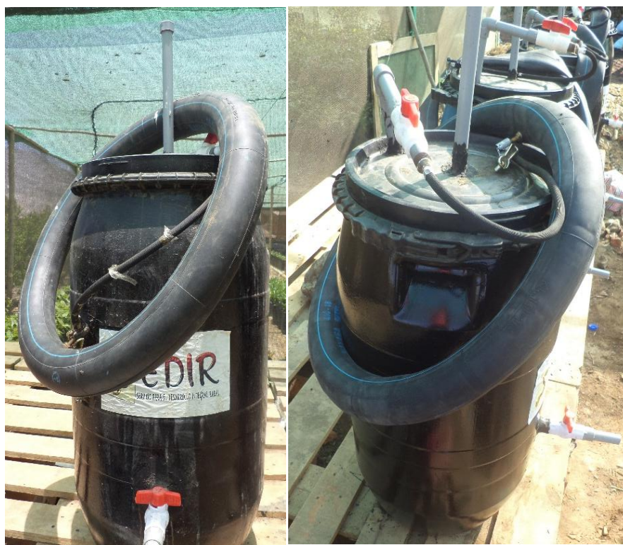
Figura 5. Producción de biogás durante la fermentación y su almacenamiento en cámaras de llantas colocados sobre los biodigestores, en la figura se observa los conductos de control para la salida de biogás.
