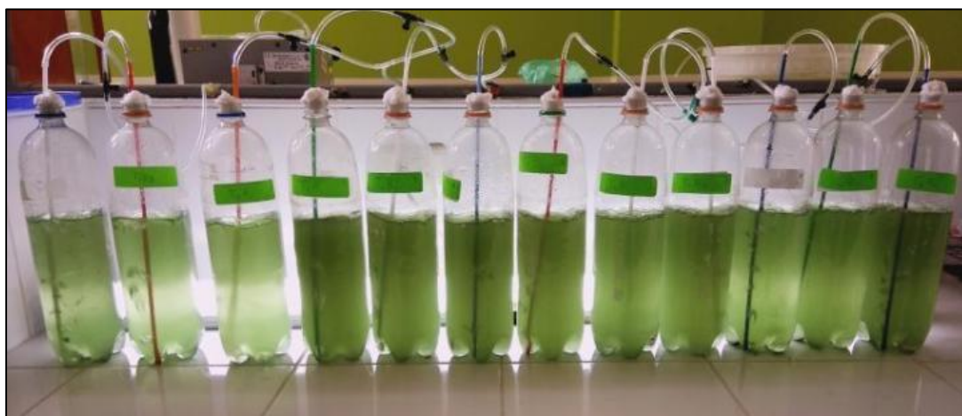
Figura 5. Disposición de las unidades de cultivo (fotobiorreactores) y el sistema de aireación e iluminación.
