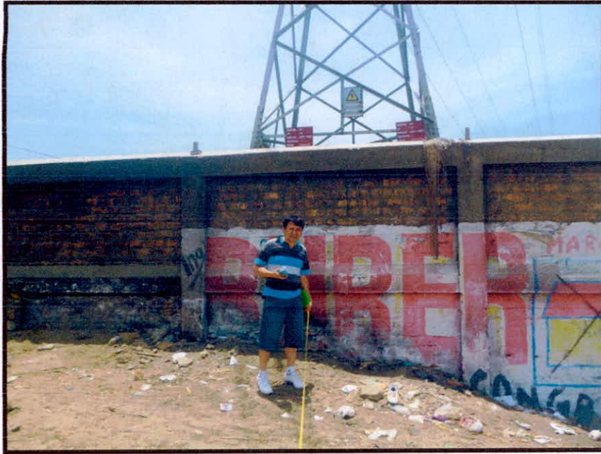
Foto N° 09: Tomando medición de ruido en el cerco perimetral de la torre de la Línea de Transmisión
