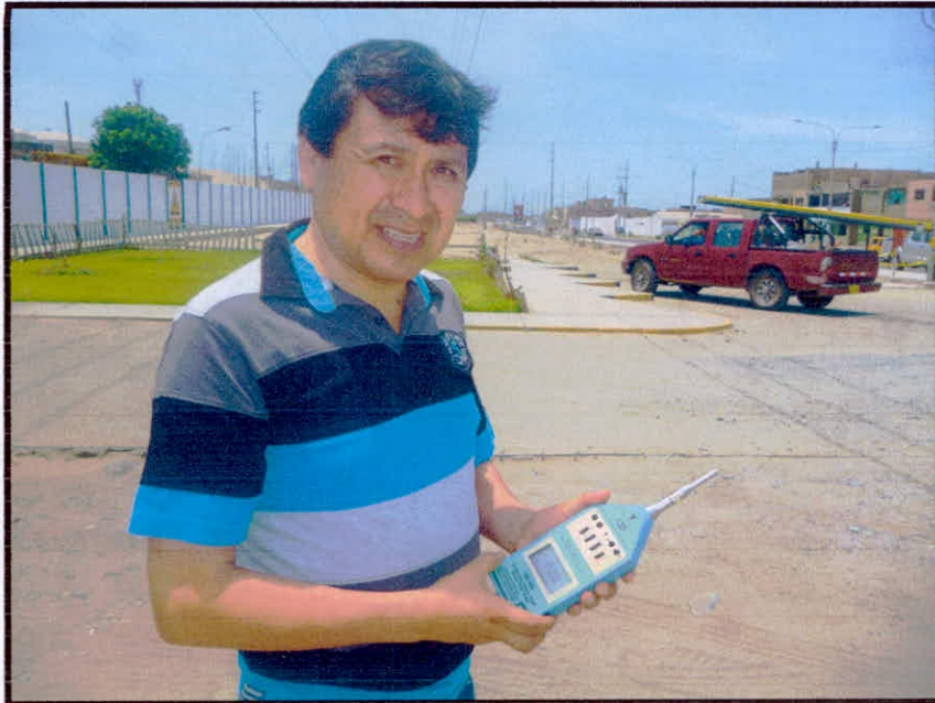
Foto N° 05: Sonómetro. Equipo utilizado para medir el ruido de la Línea de Transmisión.
