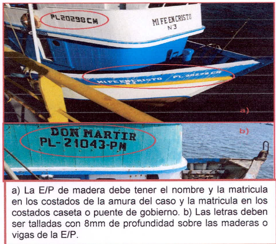
Figura 6. Inspección de una E/P de madera
