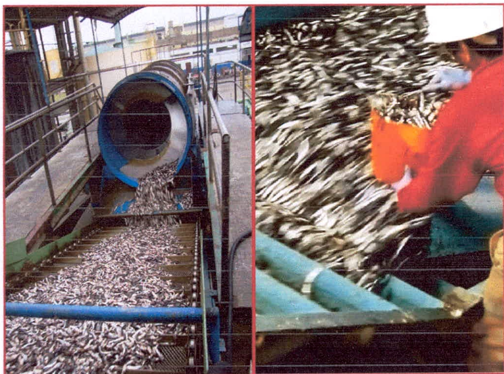
Figura 32. Inspector tomando la muestra en la caída del desagador
