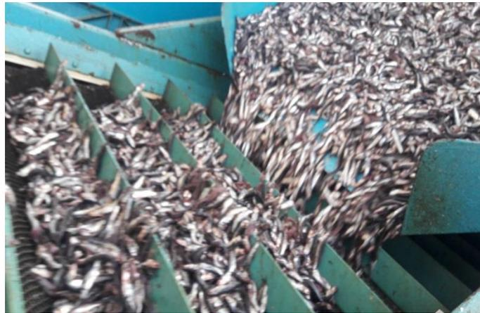
**Figura 35: Sistema de alimentación al transportador de malla.**
