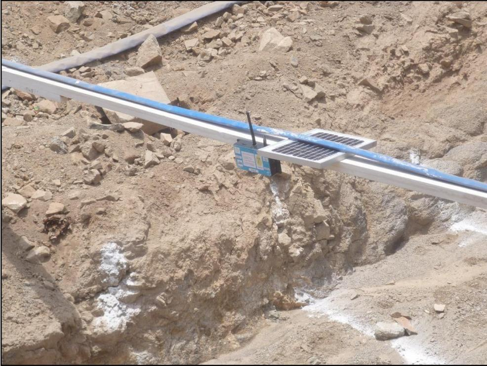
FOTO 03: Instalación de sensores ultrasónicos en las secciones de control de la quebrada experimental.
