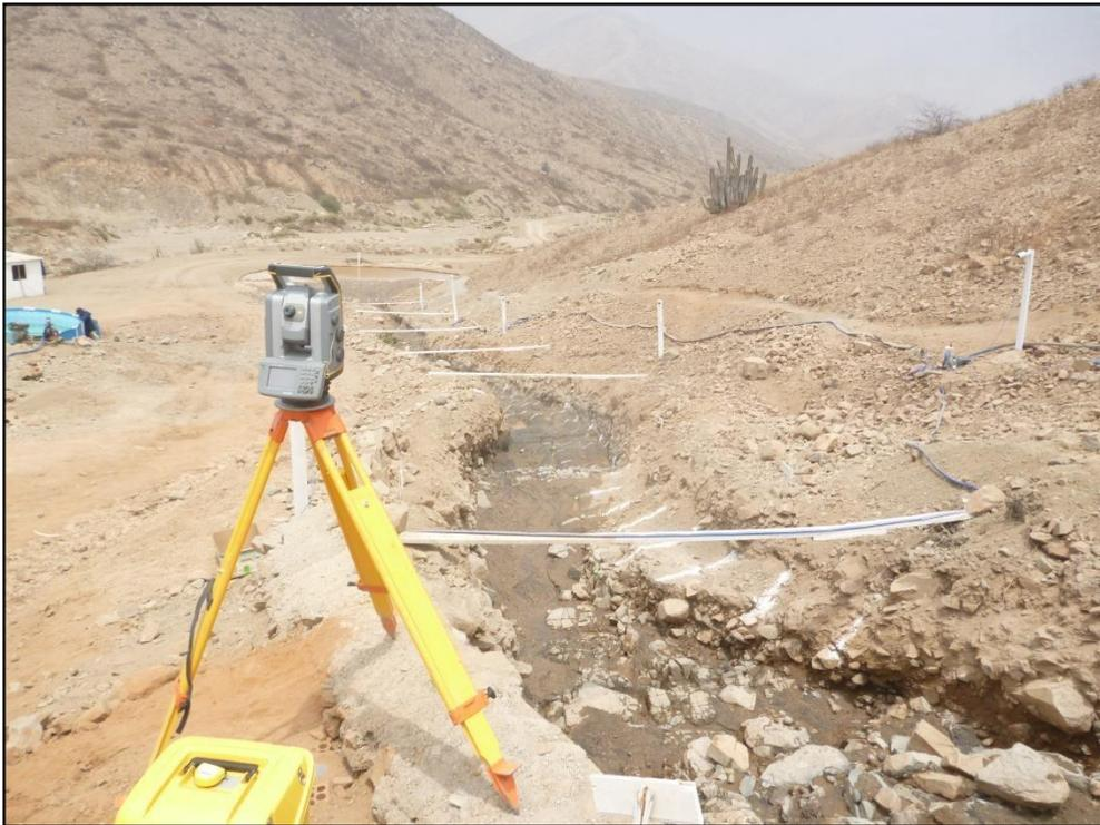
FOTO 12: Topografía post ensayo de flujos de escombros de la quebrada experimental.
