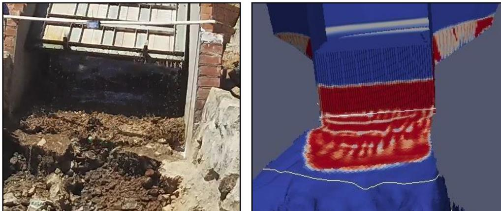
Figura 4.5: Comparación del modelo experimental con el modelo numérico en la sección 01.
