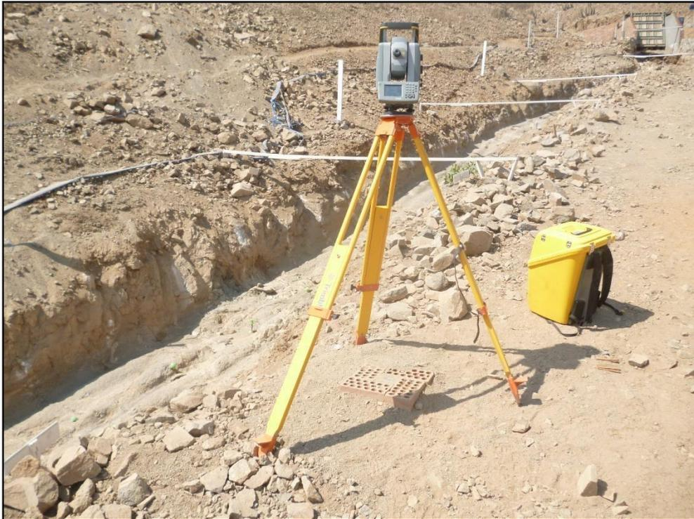
FOTO 01: Topografía pre ensayo de flujos de escombros de la quebrada experimental.
