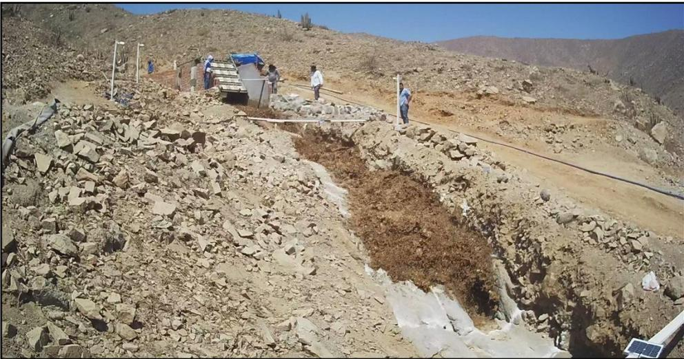
FOTO 10: Avance del flujo de escombros aguas abajo a lo largo de la quebrada experimental.
