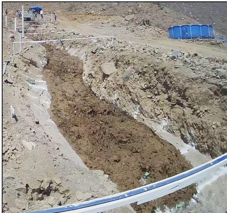
Figura 4.25: Avance del frente de onda del flujo de escombros con un tirante inicial  $H:1.00$  m y  $C_v:40\%$  en la quebrada experimental para un tiempo  $t = 20$  s.
