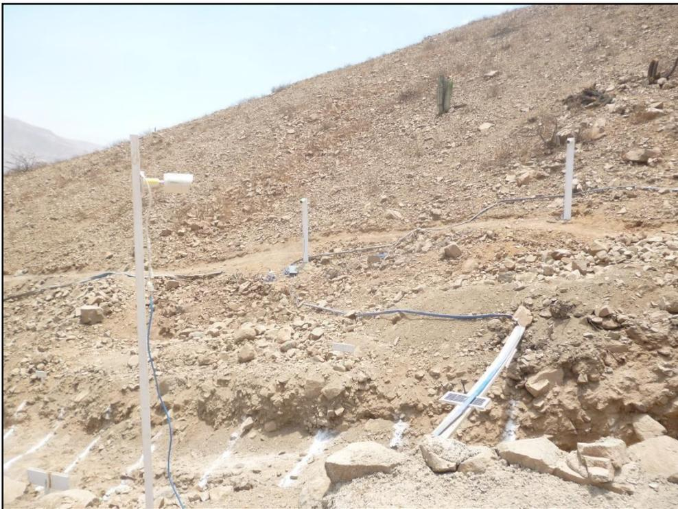
FOTO 02: Instalación de circuito cerrado de video (CCTV) en la quebrada experimental.
