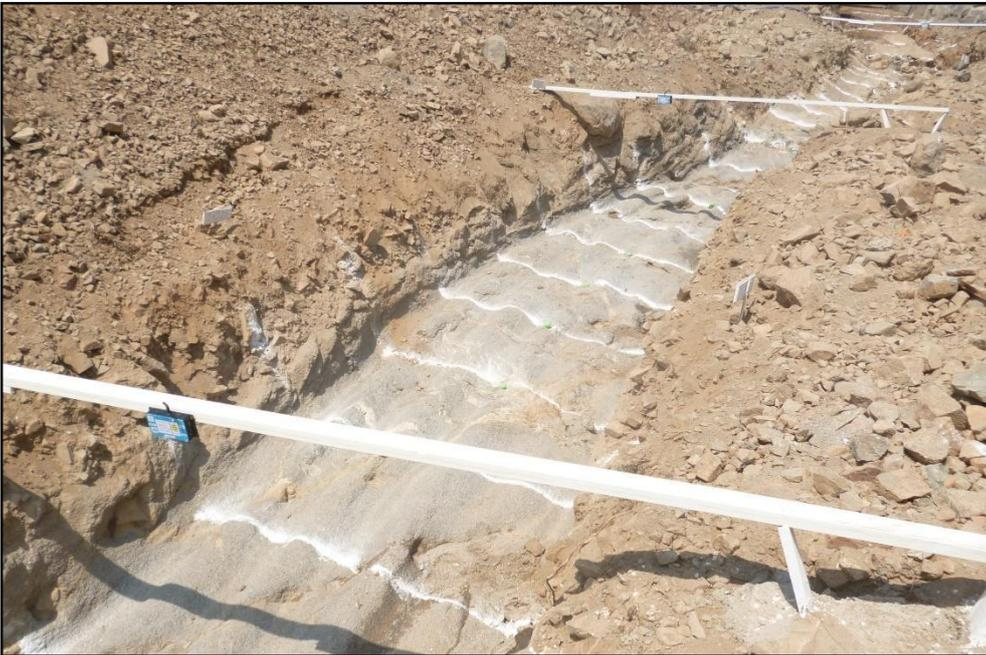
FOTO 04: Mallado reticular equidistante (cada 1.0 m) en el cauce de la quebrada experimental.
