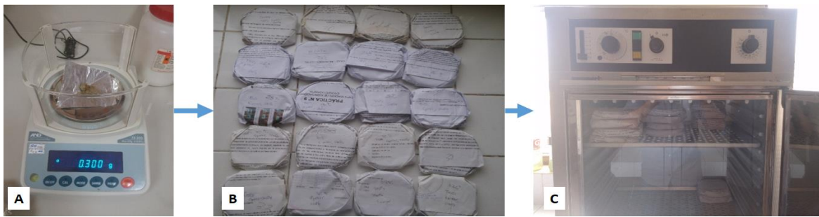
Figura 14. Síntesis de celulasas por T. harzianum cultivado en placa. A. Sembrado en placa de T. harzianum suplementado con bagazo pretratado; B. Síntesis de celulasas por T. harzianum en oscuridad a 30°C.
