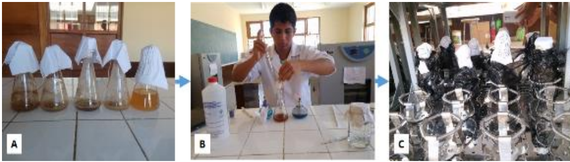
Figura 11. Pretratamiento biológico por Pleurotus ostreatus . A. Medio de pretratamiento suplementado con bagazo de caña de azúcar; B. Inoculación de Pleurotus ostreatus ; C. Incubación en oscuridad y con agitación.
