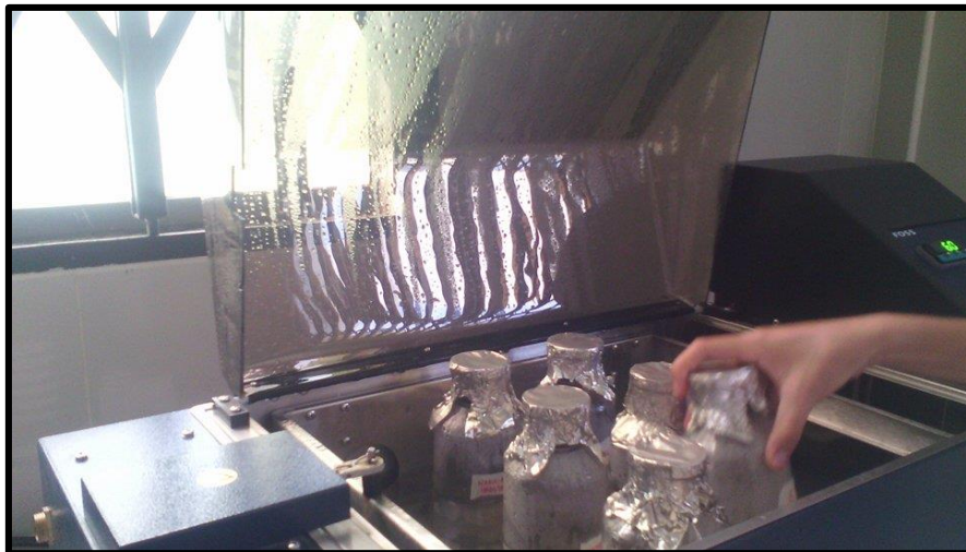
Figura 41. Muestras ingresando al baño maría para incubar a 95°C y evaluar la acción de la enzima amilasa.
