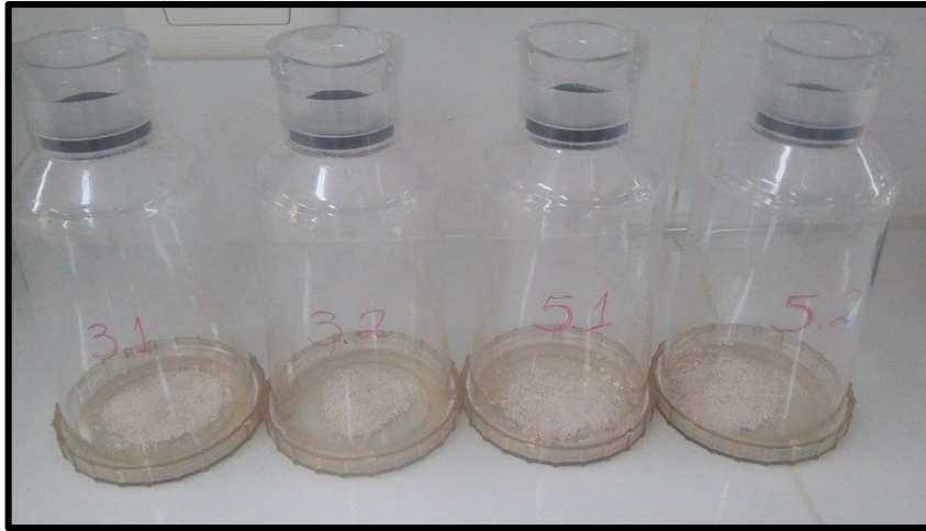
Figura 36. Preparación de las muestras en los vasos FOSS
