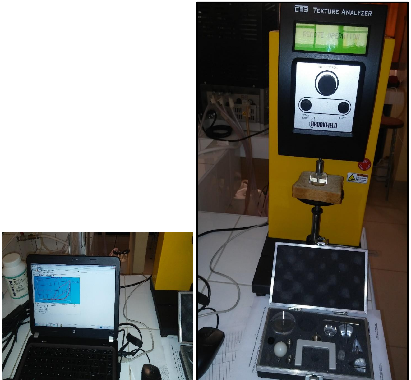
Figura 33. Muestras de pan de molde, sometidos al texturómetro Brookfield
