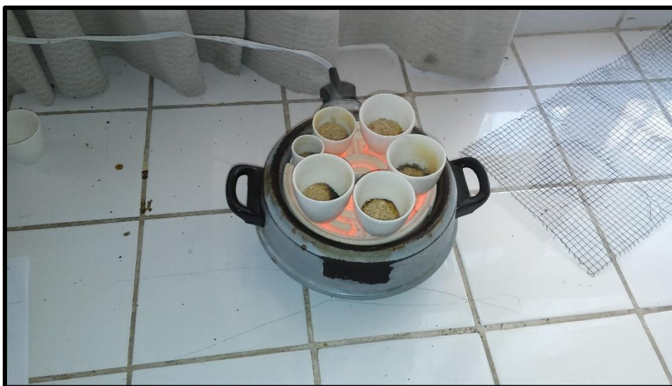
Figura 31. Calcinación de las muestras para evaluar cenizas
