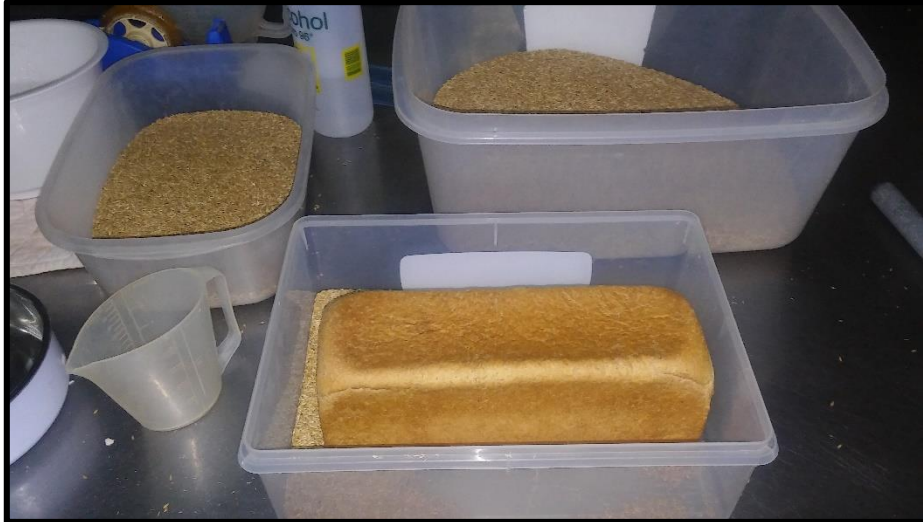
Figura 27. Evaluación del peso específico de los panes de molde utilizando la metodología de desplazamiento con semillas de alpiste.
