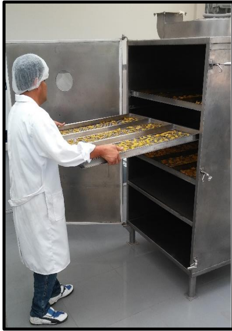
Figura 14. Disposición de las bandejas dentro del secador del IITA
