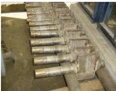
Fotos 3.15 y 3.16. Vista de los álabes directrices: relleno y maquinado
