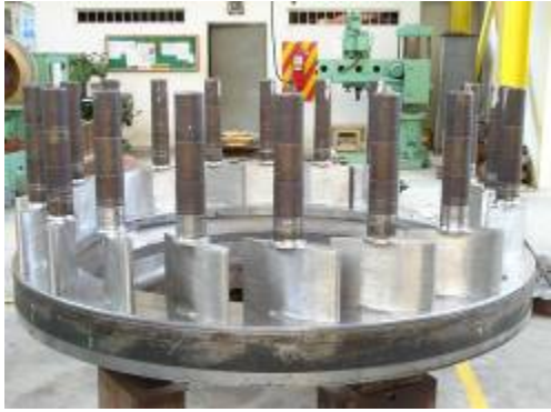
Fotos 3.19 y 3.20. Premontaje de los álabes directrices
