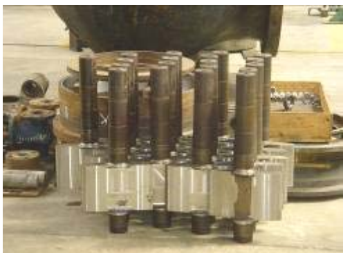
Fotos 3.17 y 3.18. Vista de los álabes directrices luego de haber sido pulido (izq.) y metalizado (der.)
