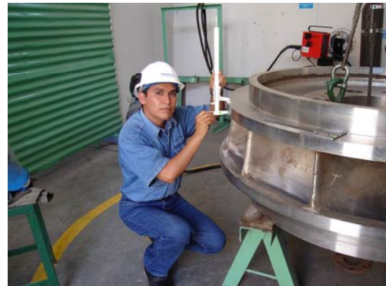
Fotos 3.21 y 3.22. Verificación de medidas en los rodetes Francis: Distancia entre corona y banda (izq.) y longitud de corona (der.)
