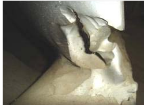
Fotos 3.7 y 3.8 Evaluación de los efectos de abrasión y erosión en el rodete Francis, correspondiente al Grupo N°1
