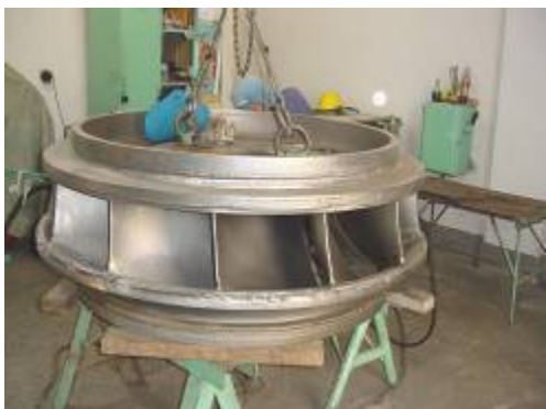
Fotos 3.11 y 3.12 Rellenado con soldadura de los Rodetes Francis
