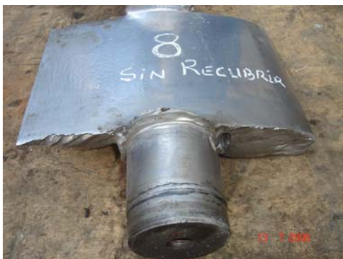
Fotos 4.3 y 4.4. Álabe directriz N° 8 sin recubrimiento antiabrasión (belzona) después de un año de operación
