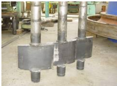
Fotos 3.17 y 3.18. Vista de los álabes directrices luego de haber sido pulido (izq.) y metalizado (der.)
