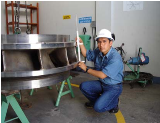
Fotos 3.21 y 3.22. Verificación de medidas en los rodetes Francis: Distancia entre corona y banda (izq.) y longitud de corona (der.)
