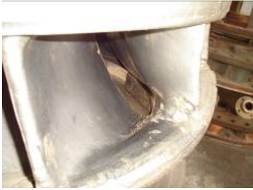
Fotos 3.9 y 3.10 Evaluación de los efectos de abrasión y erosión en el rodete Francis, correspondiente al Grupo N°2
