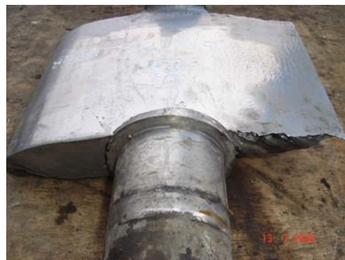
Fotos 4.3 y 4.4. Álabe directriz N° 8 sin recubrimiento antiabrasión (belzona) después de un año de operación
