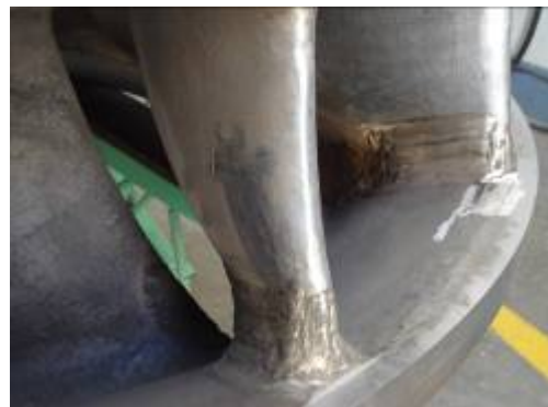
Fotos 3.11 y 3.12 Rellenado con soldadura de los Rodetes Francis
