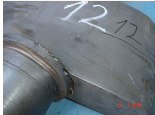
Fotos 4.1 y 4.2. Álabe directriz N° 12 con recubrimiento antiabrasión (belzona) después de un año de operación
