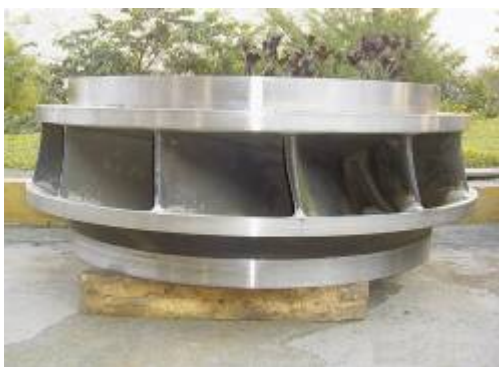
Fotos 3.13 y 3.14. Vista de los rodetes Francis luego de ser esmerilado y pulido
