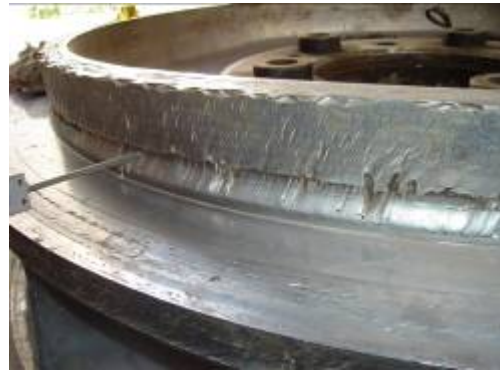
Fotos 3.9 y 3.10 Evaluación de los efectos de abrasión y erosión en el rodete Francis, correspondiente al Grupo N°2
