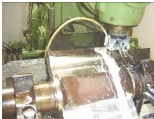
Fotos 3.15 y 3.16. Vista de los álabes directrices: relleno y maquinado
