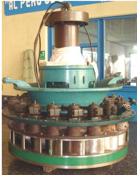
Foto N° 3.2. Turbina Francis de eje vertical
