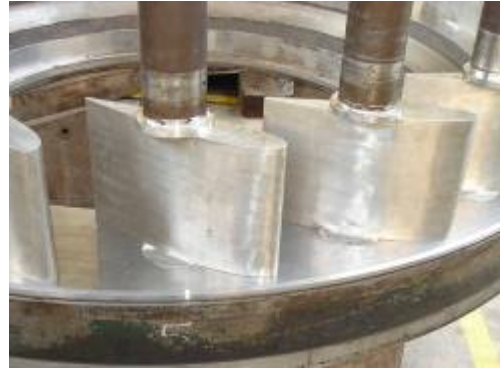
Fotos 3.19 y 3.20. Premontaje de los álabes directrices
