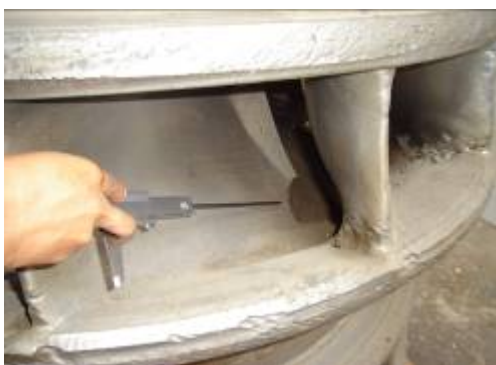
Fotos 3.7 y 3.8 Evaluación de los efectos de abrasión y erosión en el rodete Francis, correspondiente al Grupo N°1
