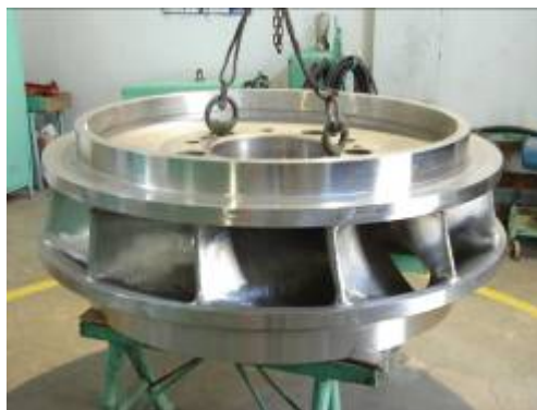
Fotos 3.13 y 3.14. Vista de los rodetes Francis luego de ser esmerilado y pulido
