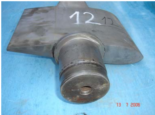
Fotos 4.1 y 4.2. Álabe directriz N° 12 con recubrimiento antiabrasión (belzona) después de un año de operación
