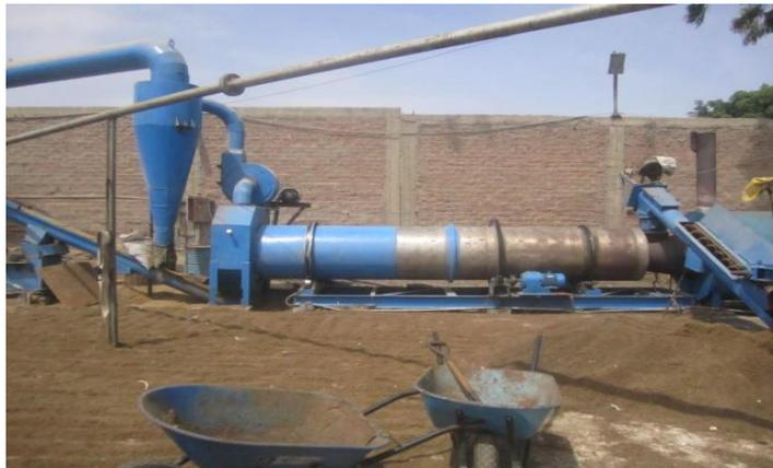
Foto 8. Secador de cilindro rotatorio
