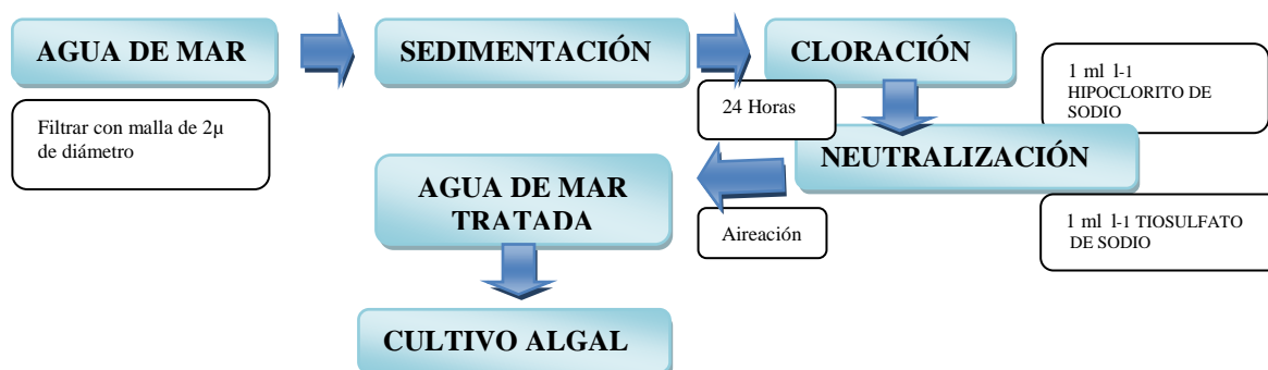
Fig. 2. Esquema del proceso de tratamiento del agua de mar, según Merino et. al. , (2003).
